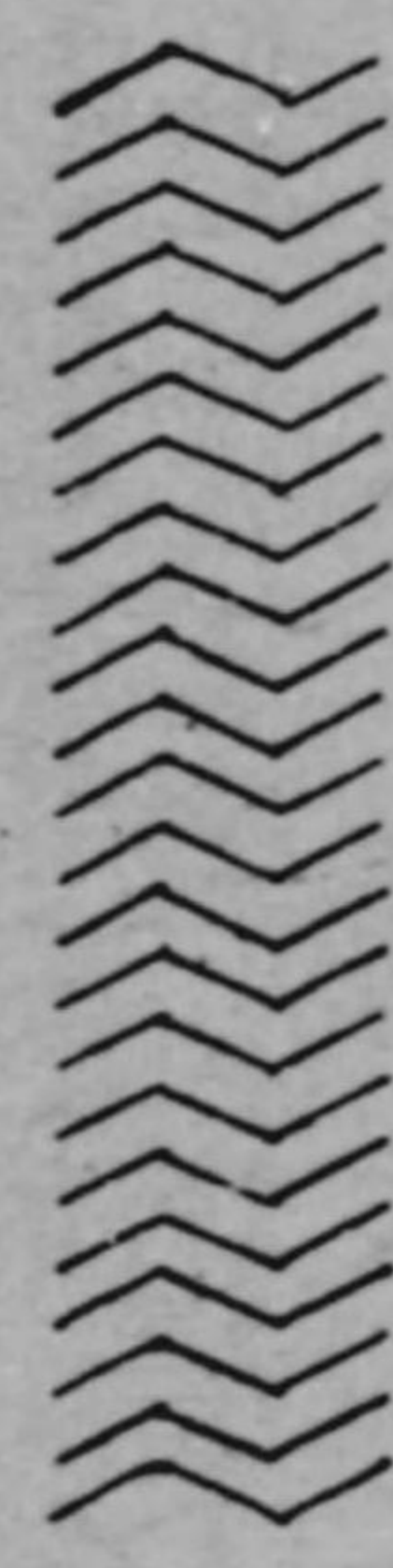
遮光換氣用燈戸の断面圖例
