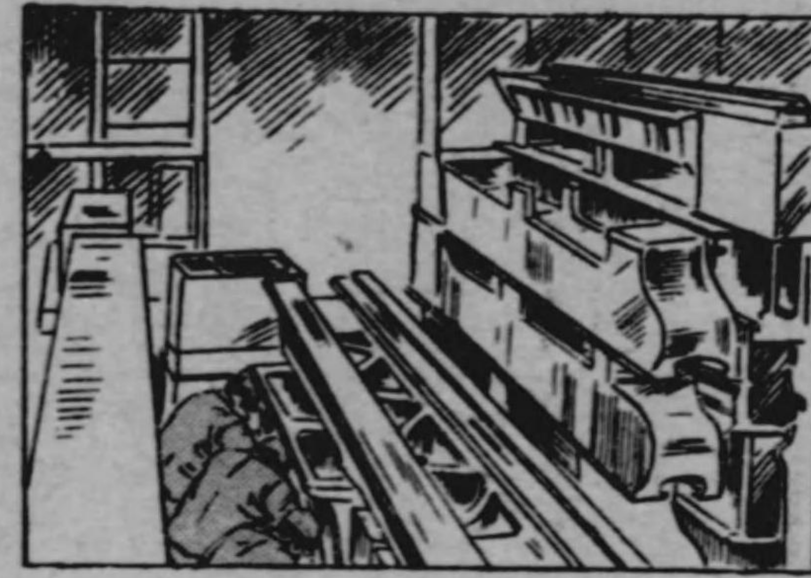
大物材料（鋼材）を利用せる待避所の例
