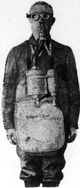
附圖 39. 德國之 韋革士 奔式 自救器(Selbstretter nach Dräger-Tübchen)。 1913 年之模型,在大戰 時曾用之者。
