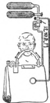
附圖 64. “撲羅多”器具 (附圖 63)之機能圖式。
