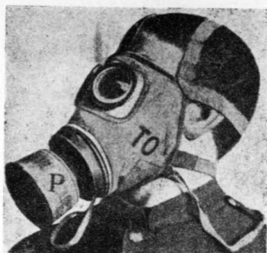
附圖 28. 1917 年之法國式防毒面具，A. R. S. 式之特別呼吸器具 (l'appareil respiratoire spécial A. R. S.)。
