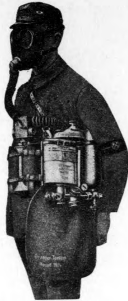
附圖 48. 椎革 (Dräger) 式之氣體防護器具，自 1924 年模型之自救器 (備有面具呼吸者) 與過濾器 (尋常工業用之吸收罐或大號之吸收罐) 聯合而成，且備有呼吸改換箱以便自氧氣呼吸改為過濾呼吸及作相反之改換者。
