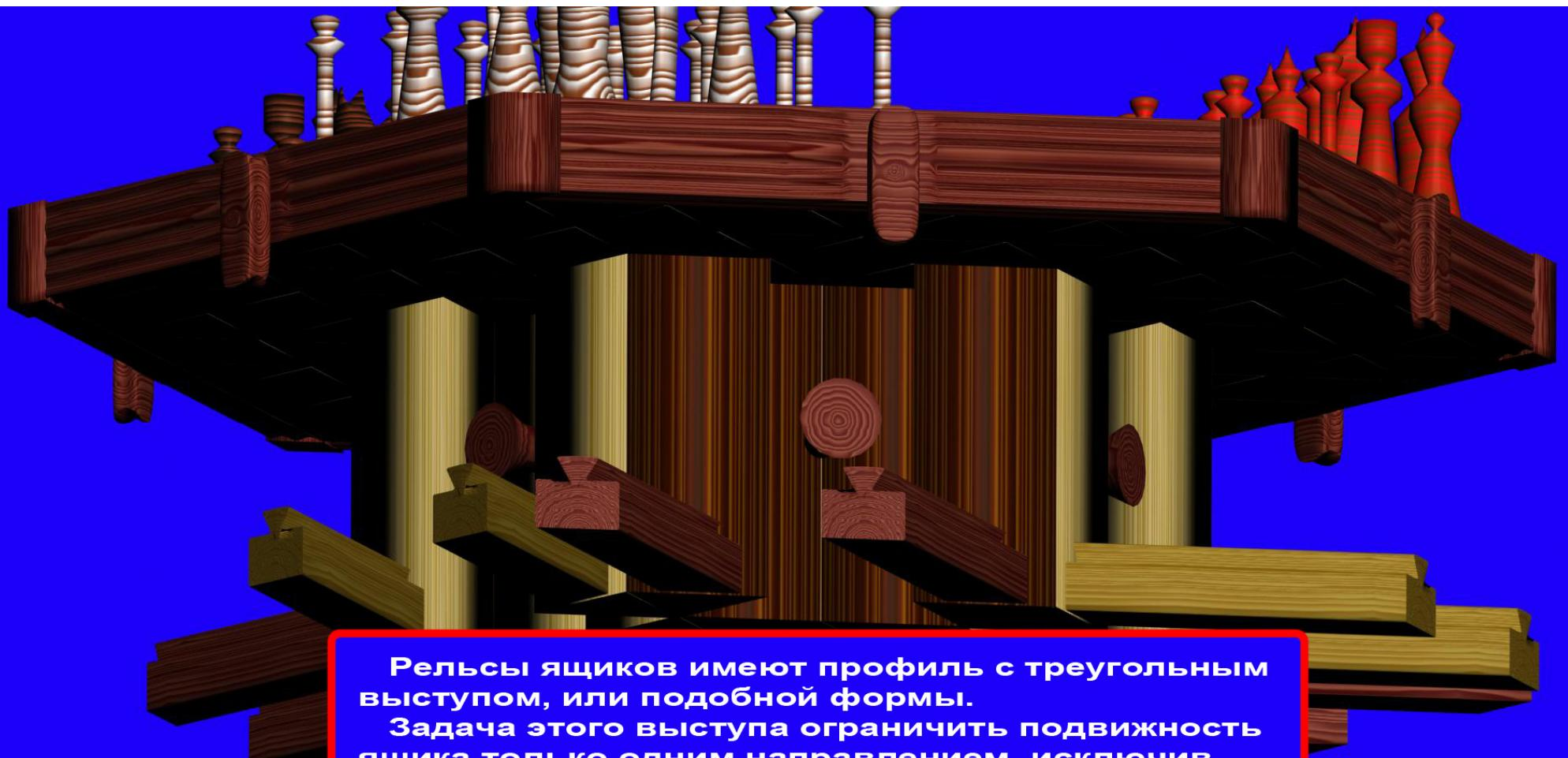
**Рельсы ящиков имеют профиль с треугольным выступом, или подобной формы.**
