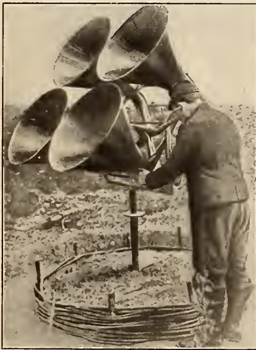
Los “oídos” más finos que se conocen. Funcionan por medio de micrófonos y descubren cualquier aeronave a media hora de distancia, por nublado que esté el tiempo.
