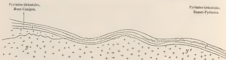
Coupe Q. — COUPE IDÉALE DES TERRAINS GRANITIQUE ET DE TRANSITION POUR MONTRER LE GRAND RÔLE DES DÉNUDATIONS DANS LA PARTIE ORIENTALE DES PYRÉNÉES. y, granite; i, terrain de transition.
