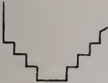
Fig. 14. Genomskärning af en arkadbåge. Bondkyrkan.
