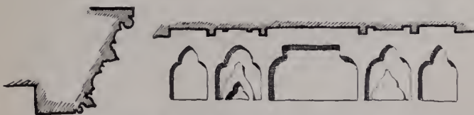
Fig. 14. Profil från dörr i Tavastehus slott och ornerad dörr från samma borg.
