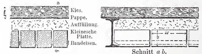
Abb. 10. Feuersicheres Dach nach Kleinescher Bauart.
