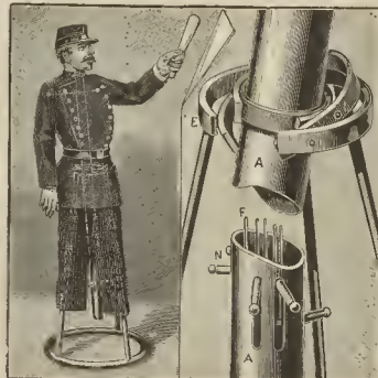
Fig. 3. - Modo de suspensión y llaves de maniobra de un títere
