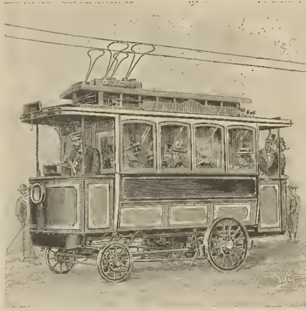
Fig. 1. — Ómnibus eléctrico de Berlín. — Carga de una batería durante una parada por medio de los alambres eléctricos de los tranvías
