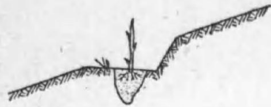
第3・4圖 萱株筋工
