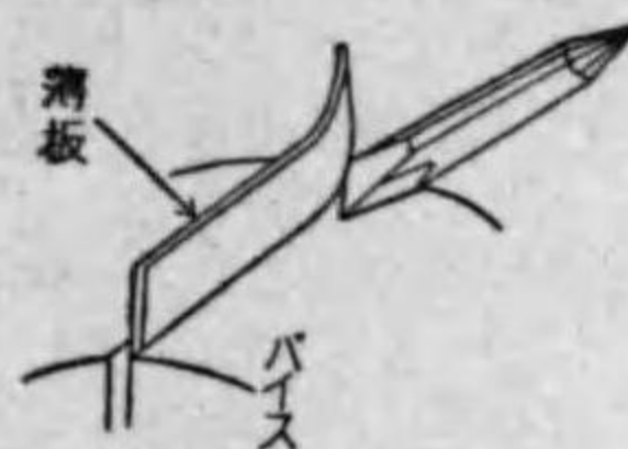
第174圖 薄板の切斷法
