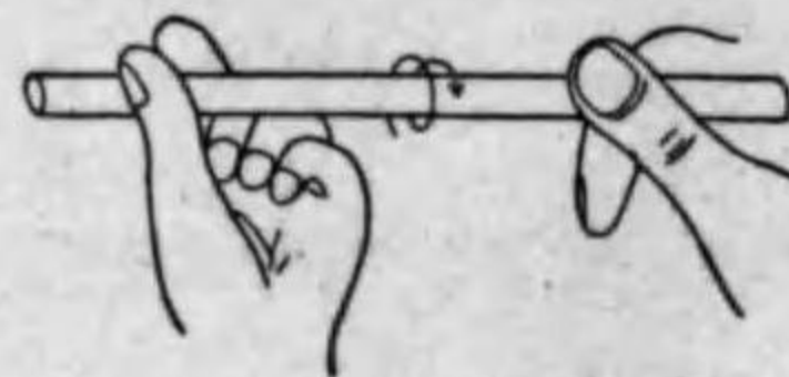
第193圖 指で丸さを検査する法
