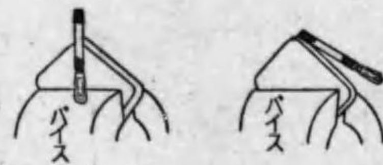
第194圖 丸面の荒削法
