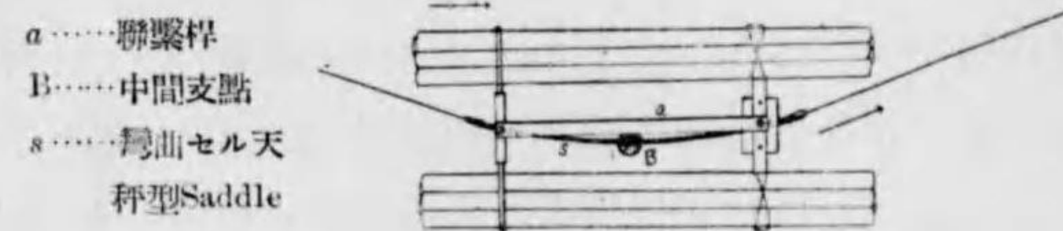
第XIII圖 長尺荷物ノ搬送中搬機ガ中間曲線路ノ支點ヲ跨ギシ瞬間ノ態形 (平面圖)
