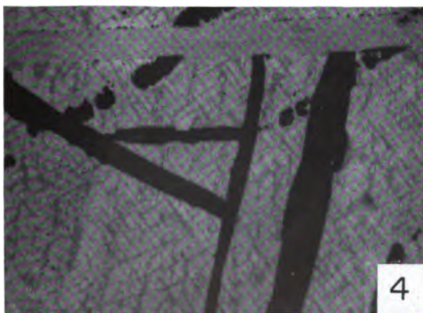
Photo 3. —Agrégat de magnétite (blanc), de \text{TiFe}_2\text{O}_4 (gris) et d'hercynite (lamelles noires). Grossissement: 2,000 x
