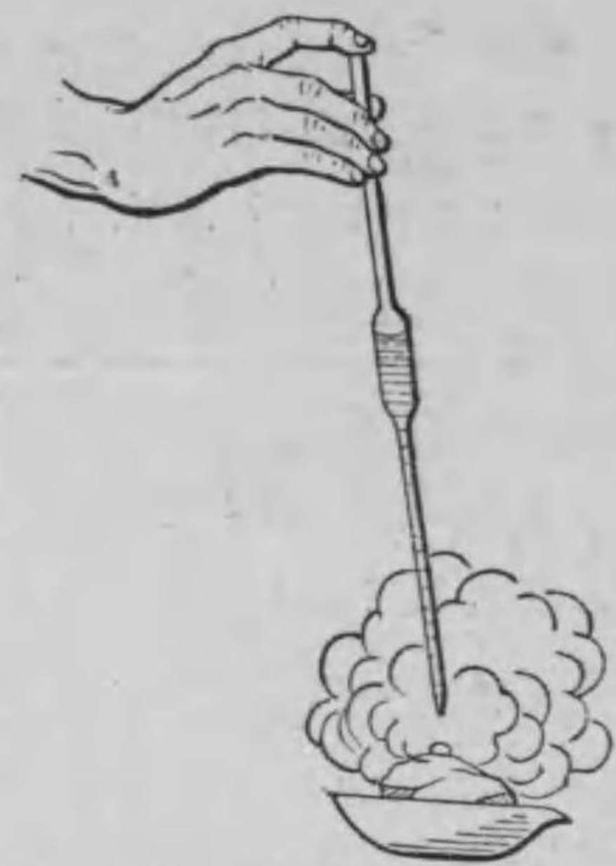
第147圖—生石灰に水を加へて消石灰を製す。
