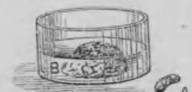
第 167 圖—アムモニウムアマルガム(A), 及び之を水に入れたる状態(B).
