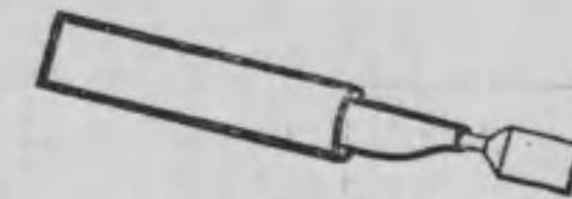
第138圖—亞鉛溜出器。(左) レトルト, (右) 受器。
