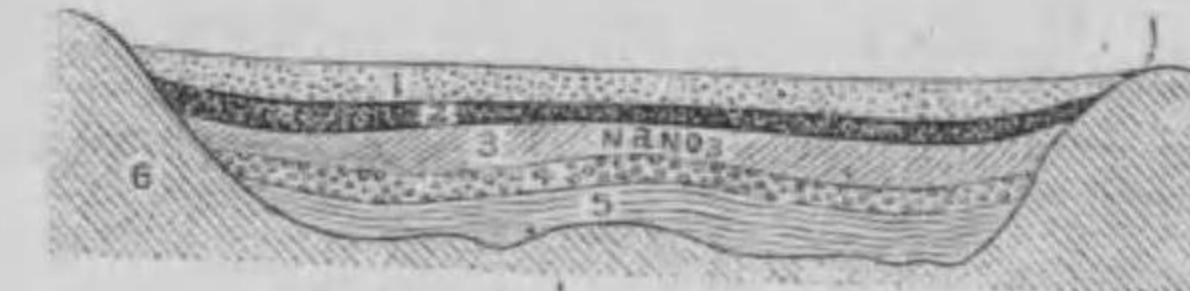
第158圖—チリ硝石地層。(1)砂層 (2)粘土層 (3)チリ硝石層 (4)鹽化加里層 (5)石灰岩
