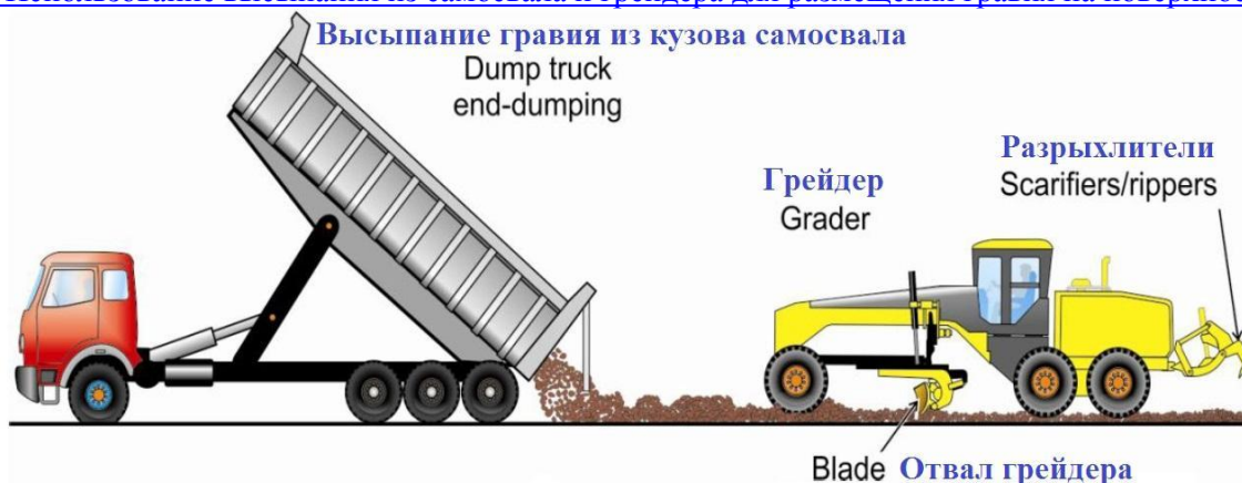
Рис. 10.4. Использование высыпания из самосвала и грейдера для размещения гравия на поверхности дороги
