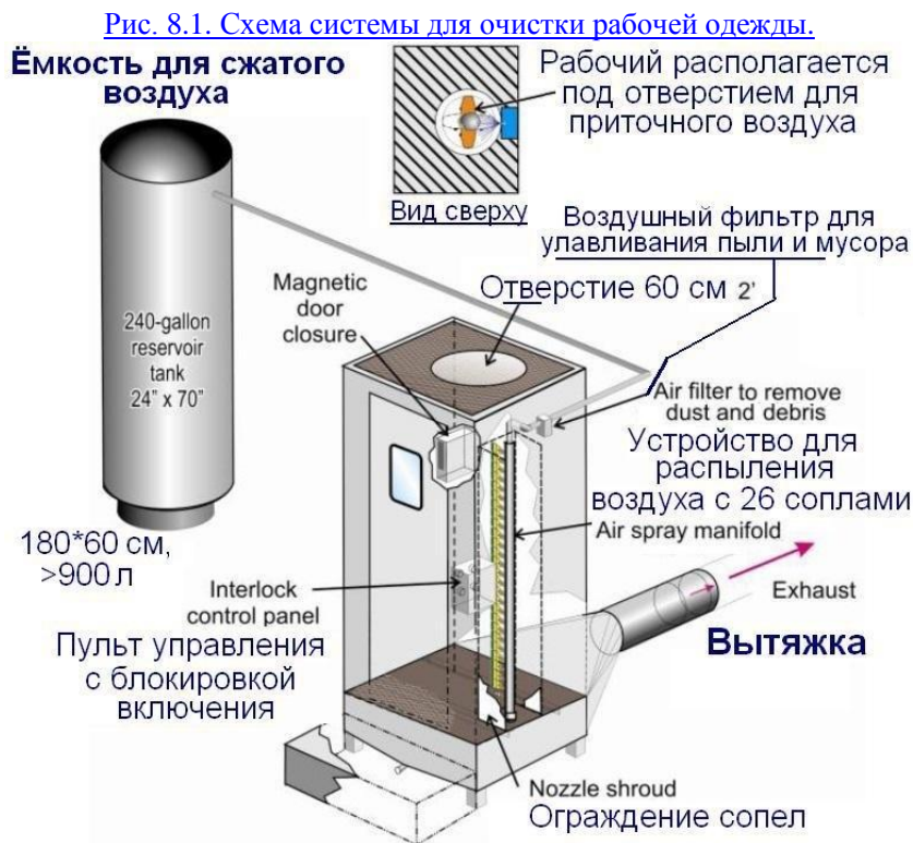
Рис. 8.1. Схема системы для очистки рабочей одежды
