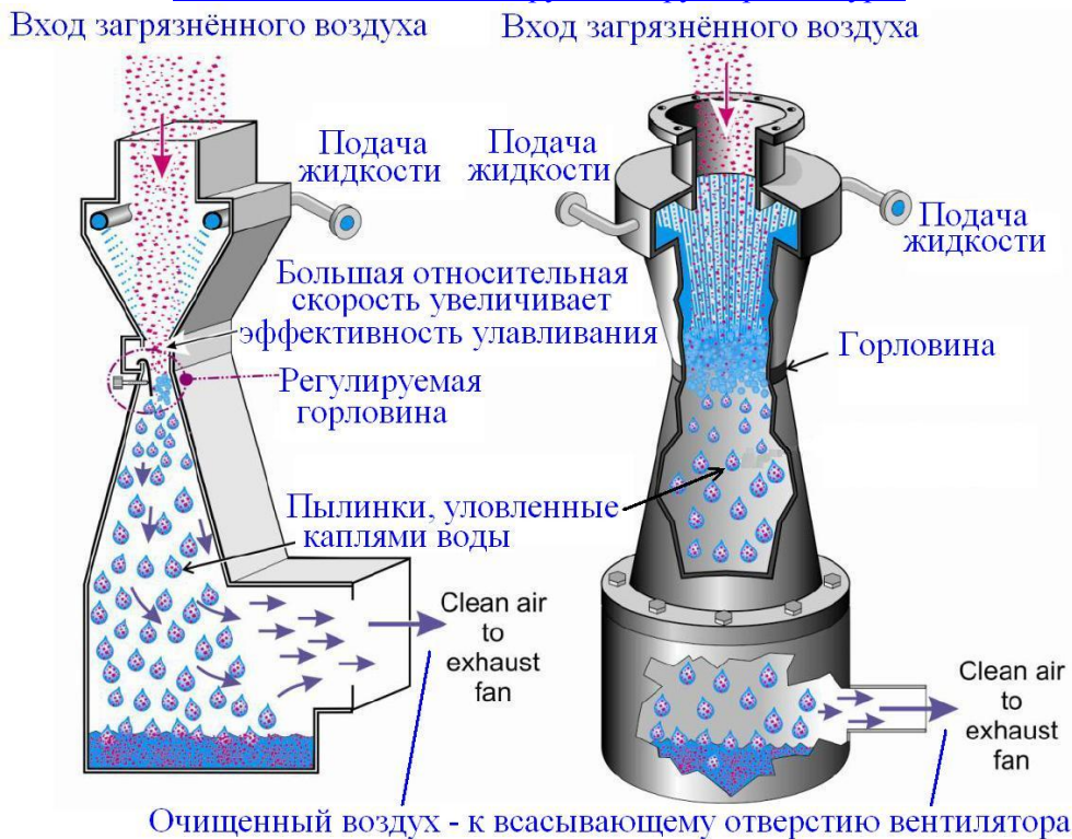
Рис. 1.22. Типичная конструкция скруббера Вентури
