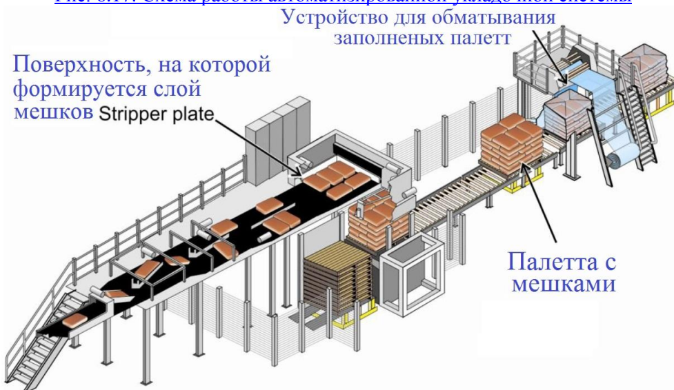
Рис. 6.17. Схема работы автоматизированной укладочной системы
