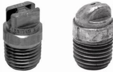
Рис. 2.19. Повреждение сопел форсунок - новая и использованная [SSCO 2003].
