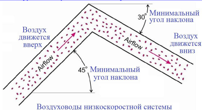
Рис. 1.11. Конструкция воздуховодов низкоскоростной обеспыливающей системы.
