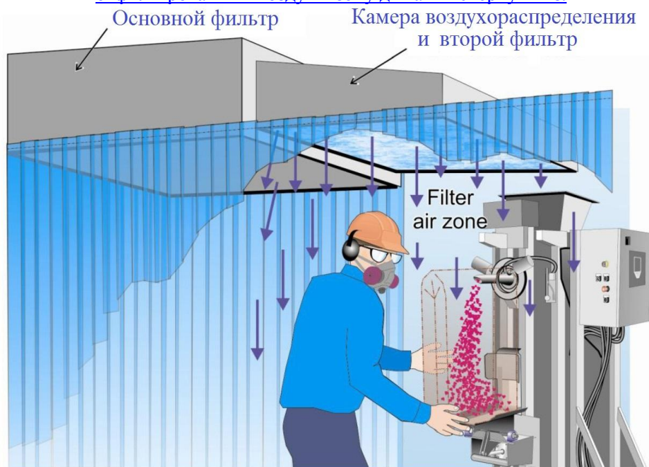
Рис. 6.12. Система OASIS (воздушный душ) над рабочим местом оператора фасовочной машины подаёт чистый отфильтрованный воздух в зону дыхания сверху вниз.
