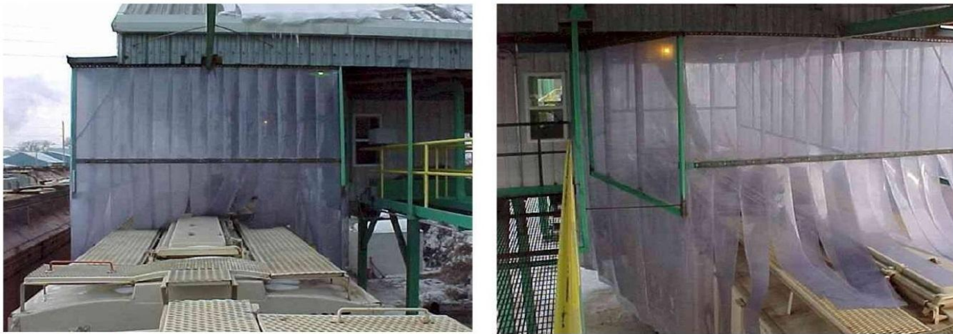
Рис. 7.7. Место погрузки железнодорожных вагонов, изолированное от окружающего пространства пластиковыми лентами для уменьшения распространения пыли
