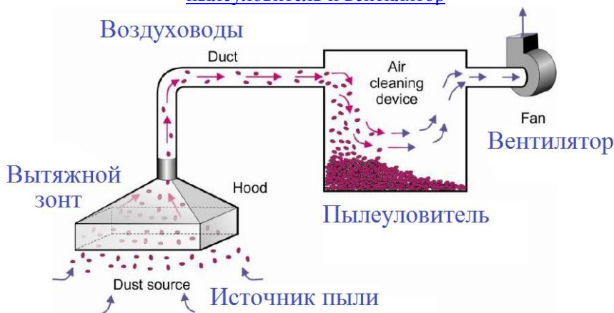
Рис. 1.02. Основные части простой вытяжной вентиляционной системы: укрытие (кожух, вытяжной зонт), воздуховоды, пылеуловитель и вентилятор.
