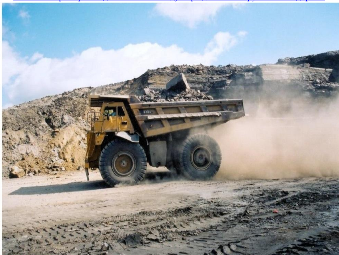
Рис. 10.1. Пример попадания пыли в воздух при движении самосвала по дороге
