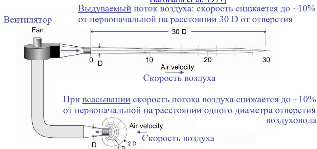
Рис. 1.03. Сравнение параметров вентиляционных потоков воздуха – всасываемого и выдуваемого [adapted from Hartman et al. 1997].
