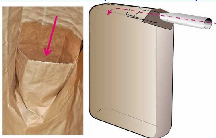
Рис. 6.2. Типичный клапан мешка - вид изнутри мешка. Показано сопло устройства загрузки материала, и клапан (справа). Сопло вводится в мешок через клапан, и подаёт материал в ёмкость.
