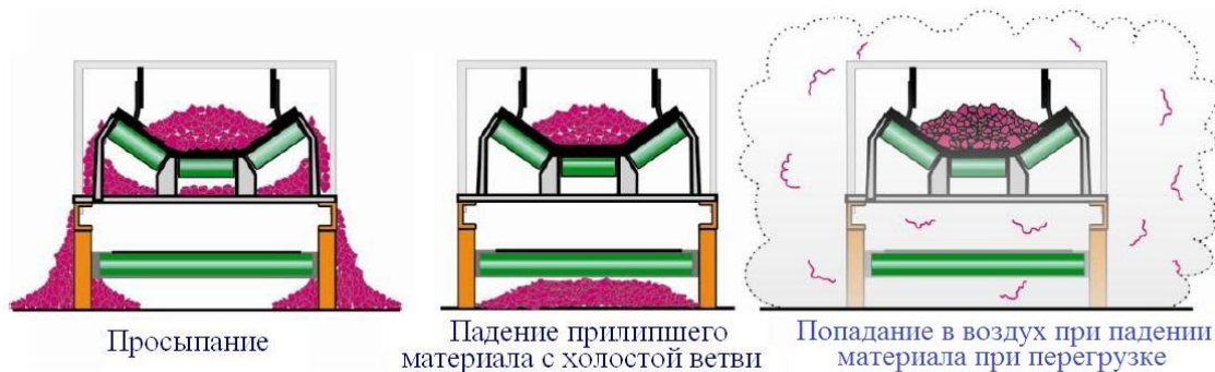
Рис. 5.2. Пути попадания пыли в воздух при перемещении материала ленточным конвейером
