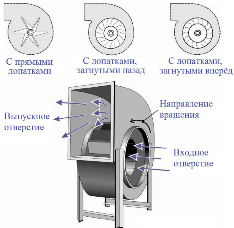
Рис. 1.30 Типичный радиальный вентилятор
