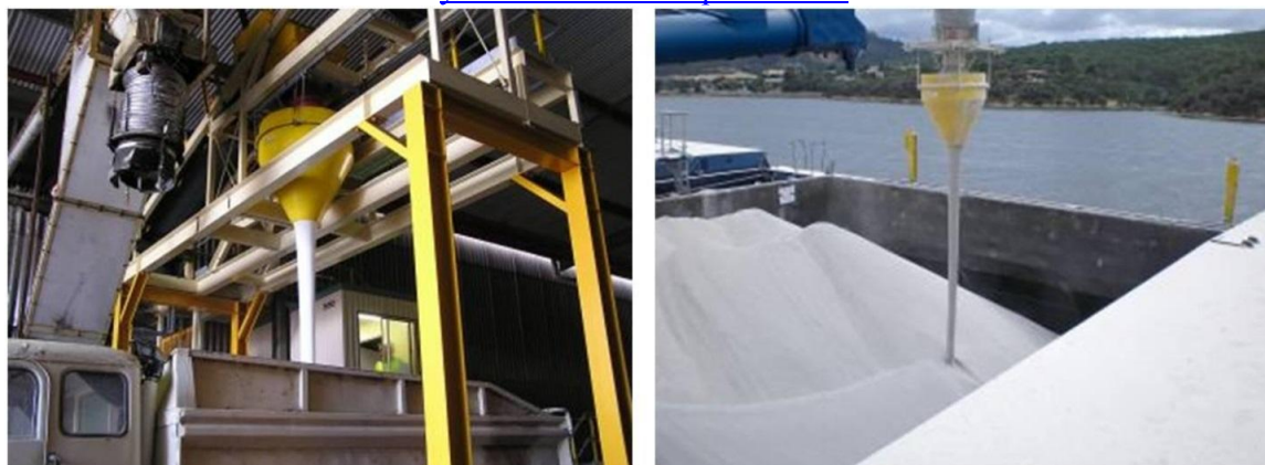
Рис. 7.6. Бункер для предотвращения образования пыли создаёт сплошной поток материала при погрузке, что уменьшает пылеобразование.
