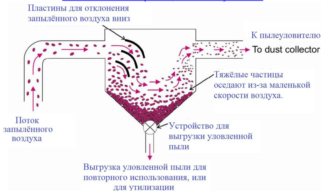
Рис. 1.14. Типичный гравитационный пылеуловитель
