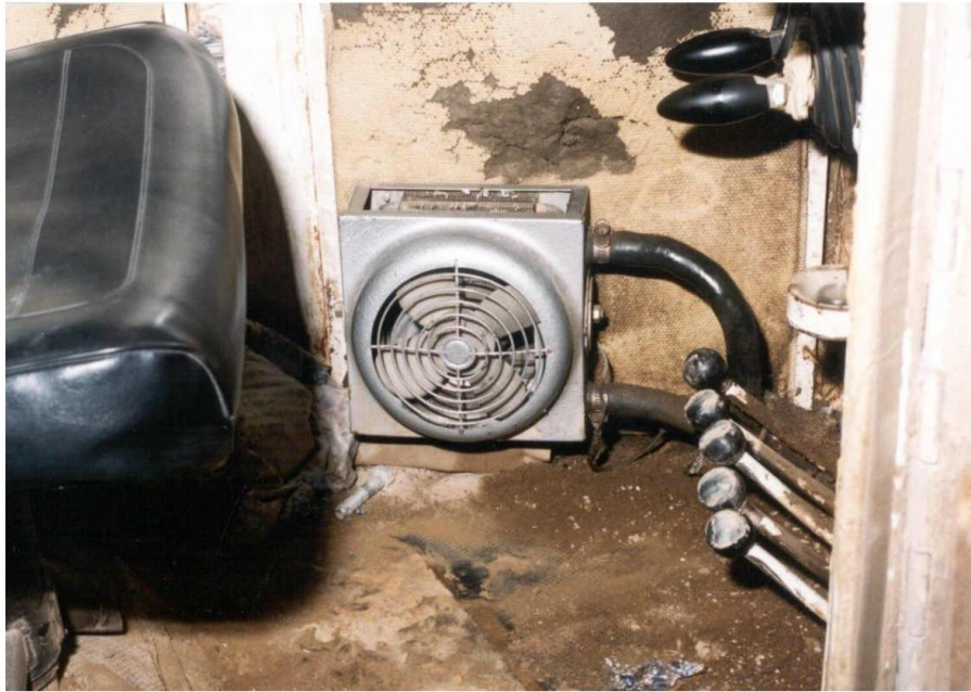
Рис. 8.13. Накопление грязи в кабине мобильного оборудования, принесённой на грязной обуви.
