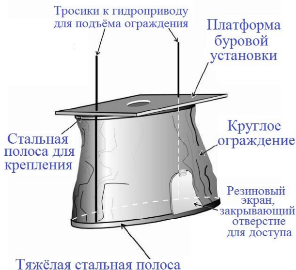
Рис. 3.6. Конструкция круглого ограждения
