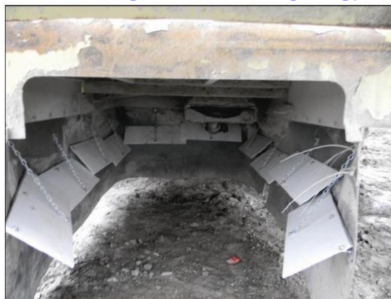
Рис. 3.12. Модифицированные полки. Они сделаны в виде коротких секций для предотвращения возможного повреждения при перемещении буровой установки. Каждая из секций перекрывает соседние так, что исключается просачивание по периметру.
