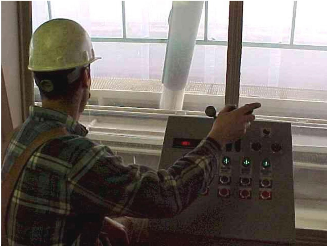
Рис. 7.8. Изолированная кабина оператора, управляющего погрузкой материала, с контролируемой атмосферой.
