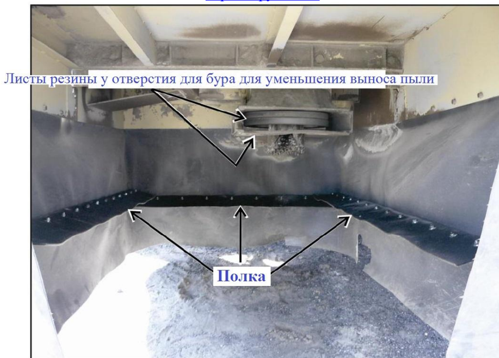
Рис. 3.10. Отклоняющие поток полки, установленные с внутренней стороны ограждения укрытия буровой установки. Обратите внимание на перекрытие по углам, которое уменьшает просачивание через зазоры по периметру полок.
