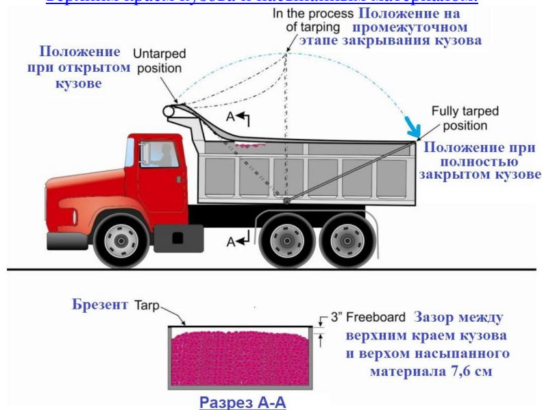
Рис. 10.9. Самосвал с приспособлением для накрывания груза брезентом. Голубая стрелка показывает направление движения (кронштейна) при накрывании. На разрезе А-А показан рекомендуемый зазор между верхним краем кузова и насыпанным материалом.
