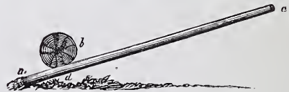
Fig. 2087. Einarmiger Hebel (Hebebaum).
