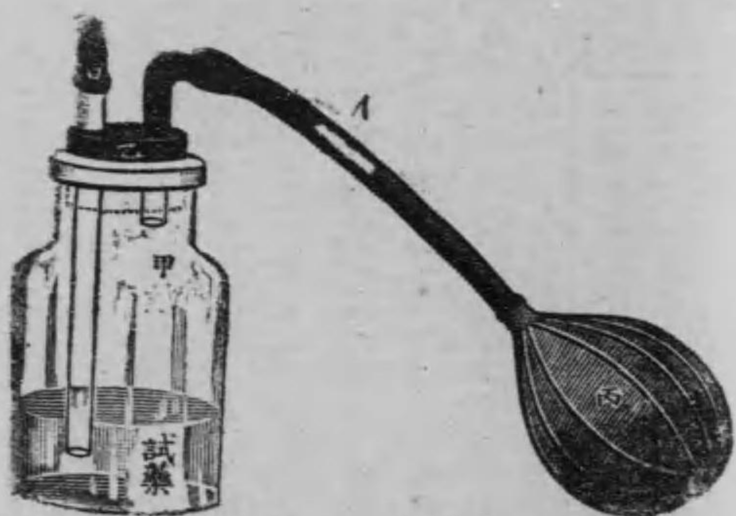
第五圖 ノンケツゲンル フルドンケツゲンル 炭酸測定器
