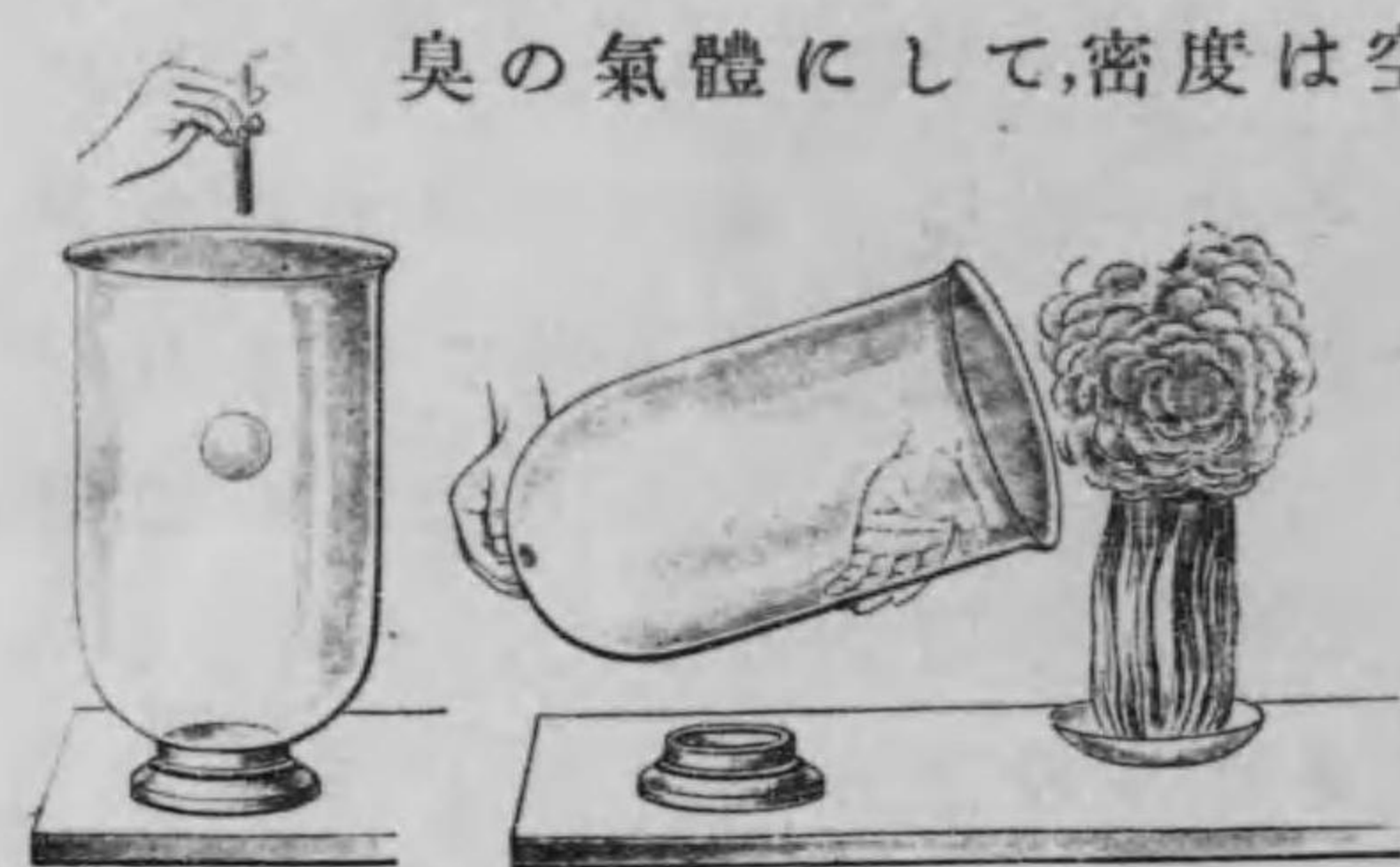
第34圖：一無水炭酸に浮べる石鹼球(左)と、無水炭酸の消火作用(右)。
