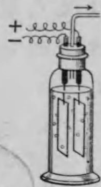
第8圖：一水合成用の水素と酸素との混合氣體を製する装置。
