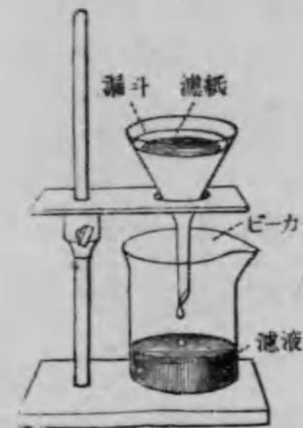
第1圖：一水の濾過。 濾紙にて水を濾過す。
