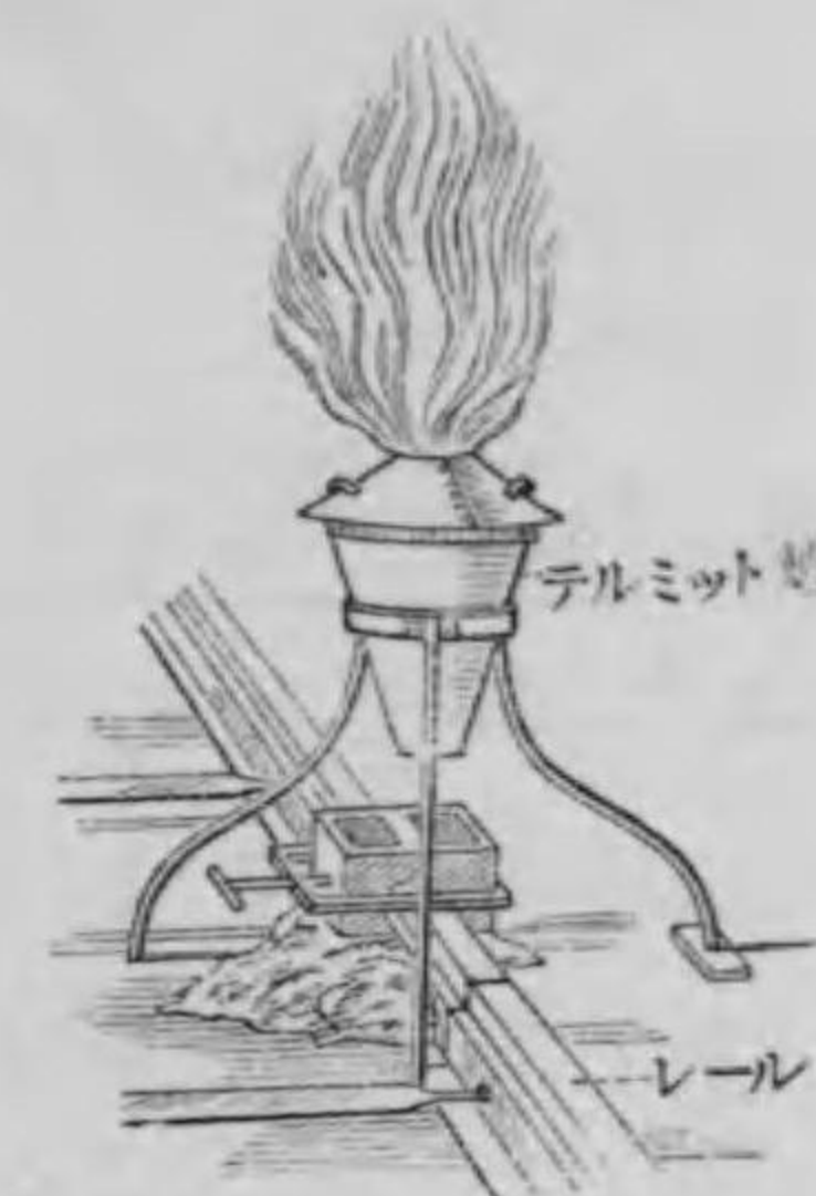
第83圖：一テルミット法にてレールを接合す。
