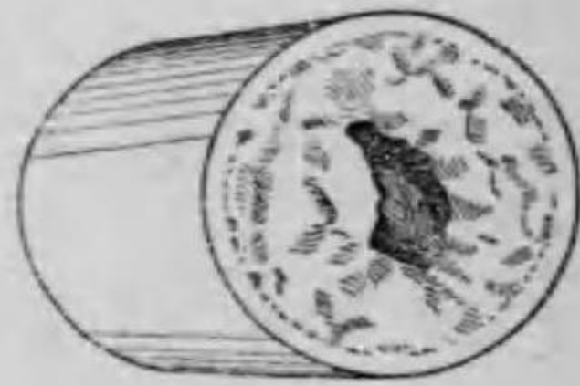
第135圖：—硬水を使用せし汽罐用水管内に沈積物の生じたる有様。
