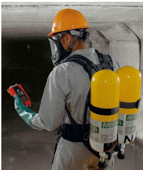
**Фиг. 2-45. Автономный дыхательный аппарат с открытым контуром**
