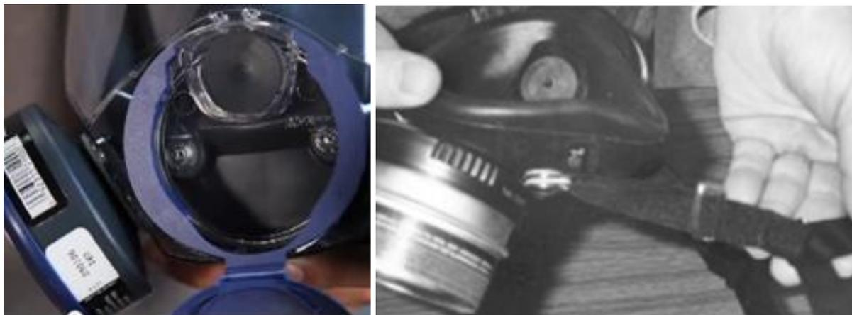
**Фиг. 4.2. Проверка клапана**
