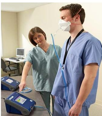
**Фиг. В-5 Количественная проверка ИС респиратора – фильтрующей полумаски**
