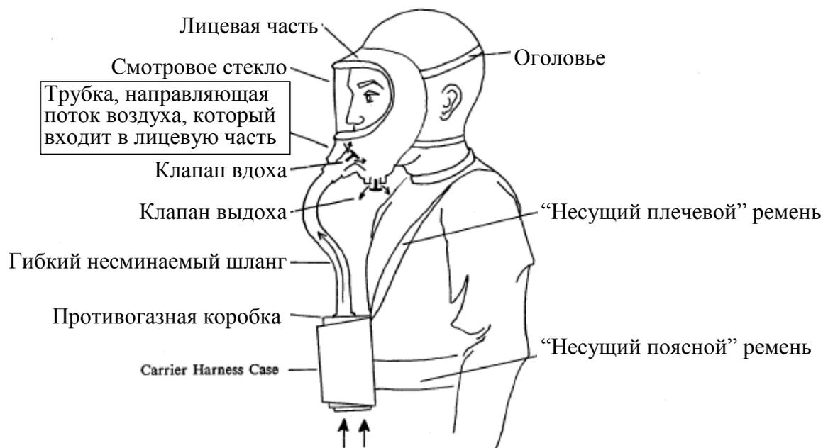
**Фиг. 2-29. Противогаз с расположенной спереди противогазной коробкой**
