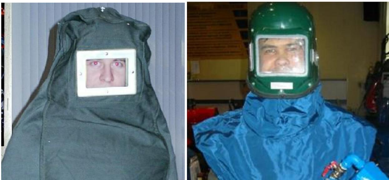
**Фиг. 2-12 Респиратор - пневмокапюшон для абразивных пескоструйных работ**
