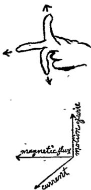
方向，食指表示磁力線之方向，則中指表示誘導電流
