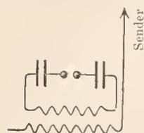
funkenlose metallische Leitung ist, und die Schwingungen in ihm elektrodynamisch, d. h. durch Induction erregt werden. Beistehende schematische Figur erläutert dieses Princip.
