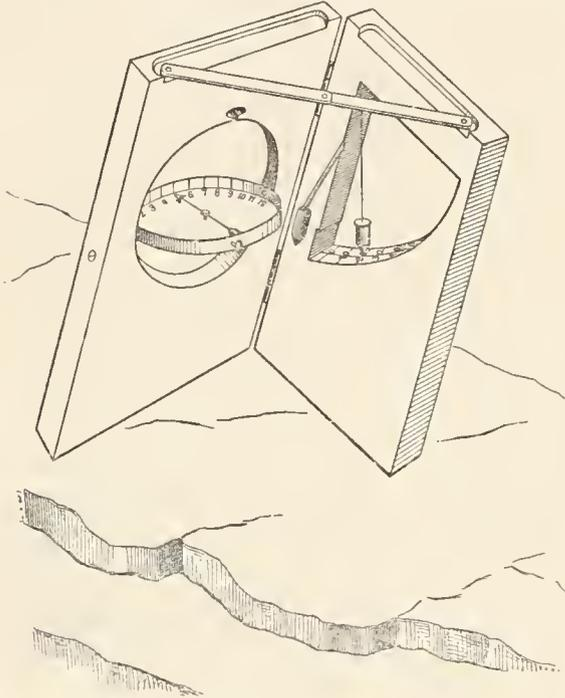
Genauigkeit zu bestimmen. Die Anfertigung und den ausschließlichen Vertrieb des Apparats hat die Firma R. Fuess, Mechanisch-optische Werkstätten in Steglitz bei Berlin übernommen. Befolgend eine kurze Beschreibung und Gebrauchsanweisung des Stratometers.
