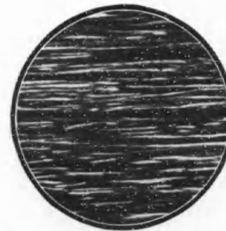
(3)ノ組織ノ線材ヲ鋼索用ニ加工シタル鋼線ノ組織
