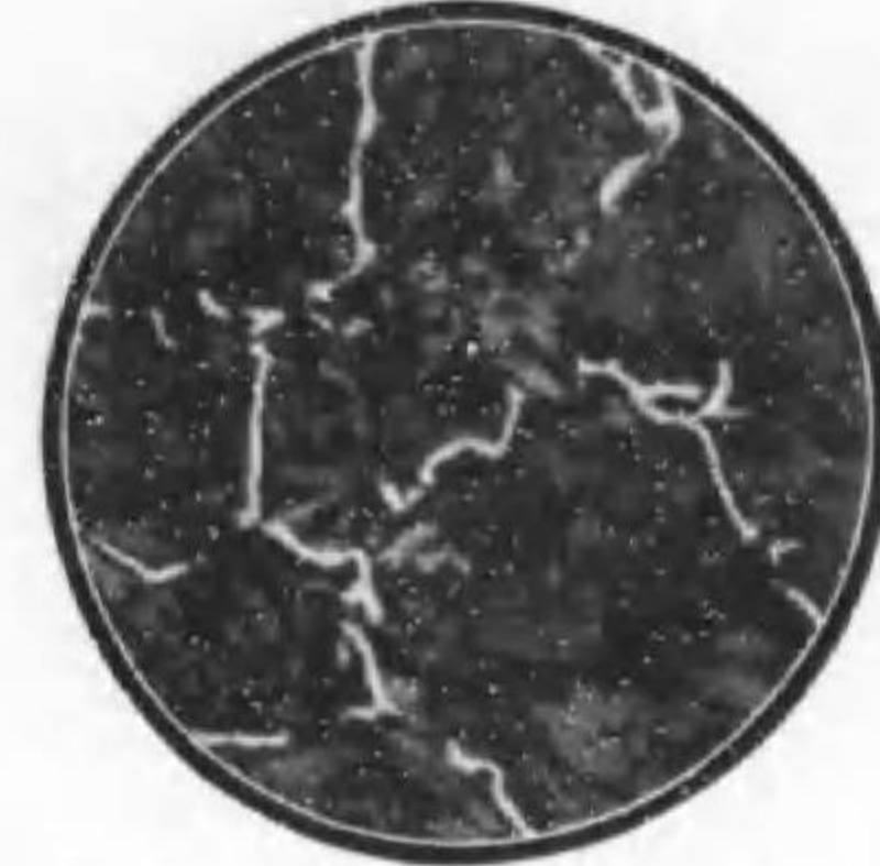
(1)ノ金質ヲ普通ノ方法ニヨリ調整シタル線材ノ組織
