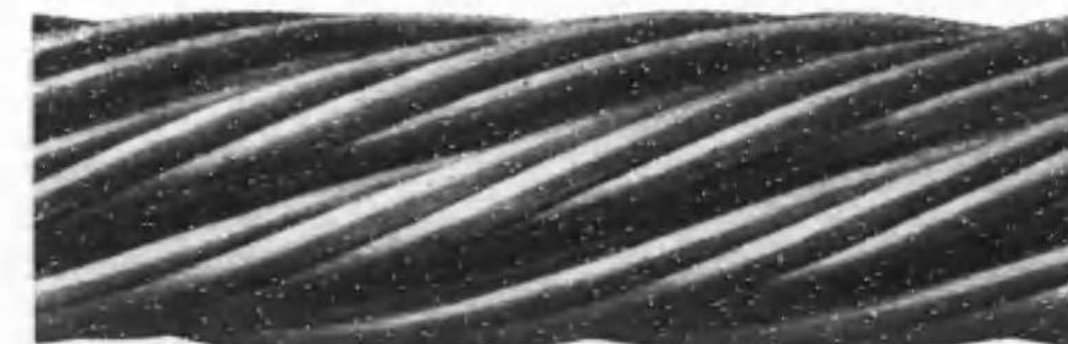
右ラングレー撚 (Left hand lang's lay)
