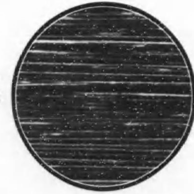
(3)ノ組織ノ線材ヲ高級品用トシテ加工シタル「ピアノワイヤ」ノ組織
