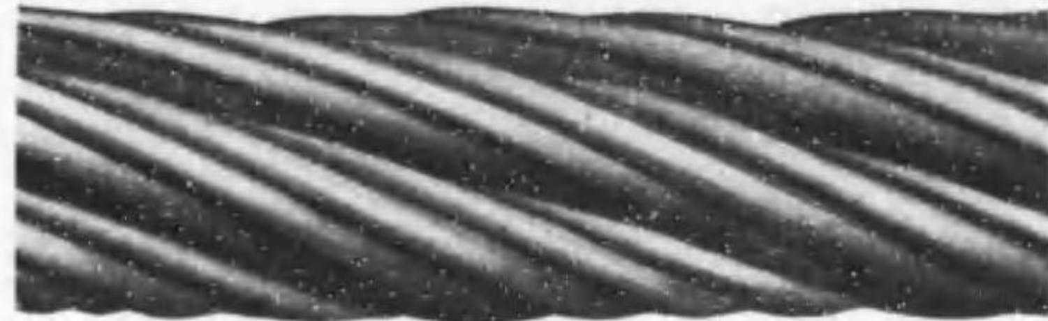
左ラングレー撚 (Right hand lang's lay)
