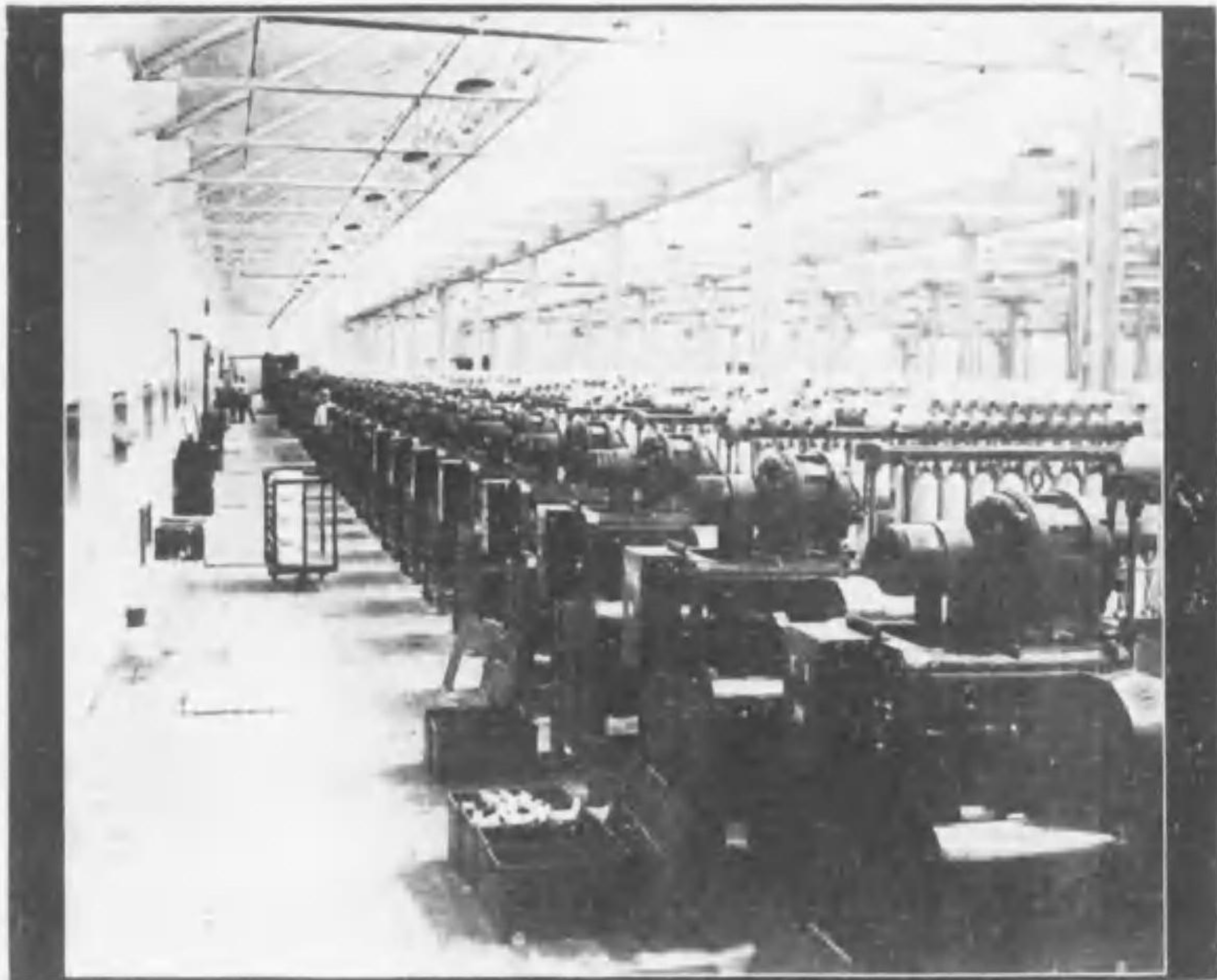
弊社紡績用高率モートルによつて單獨運轉されつゝある精紡機
