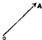
第81圖 力的圖示O，力點；OA，方向；OA的長表示力的大小
