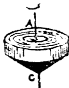
第122圖 陀螺AC轉動軸
