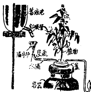
圖25. 小規模水植中虹吸水池換氣裝置。
