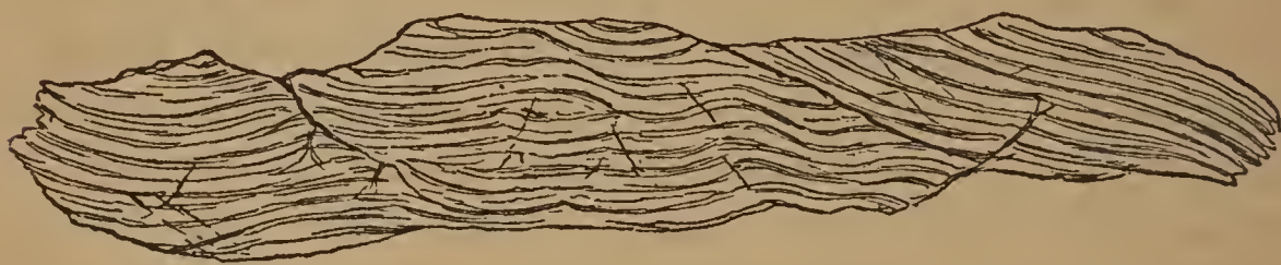
Druckerscheinung (Biegung der Zwillingslamellen) am Calcit aus dem Diabas von Wiemeringhausen.
