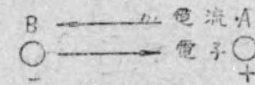
第 4.2 圖 自由電子の移動と電流
