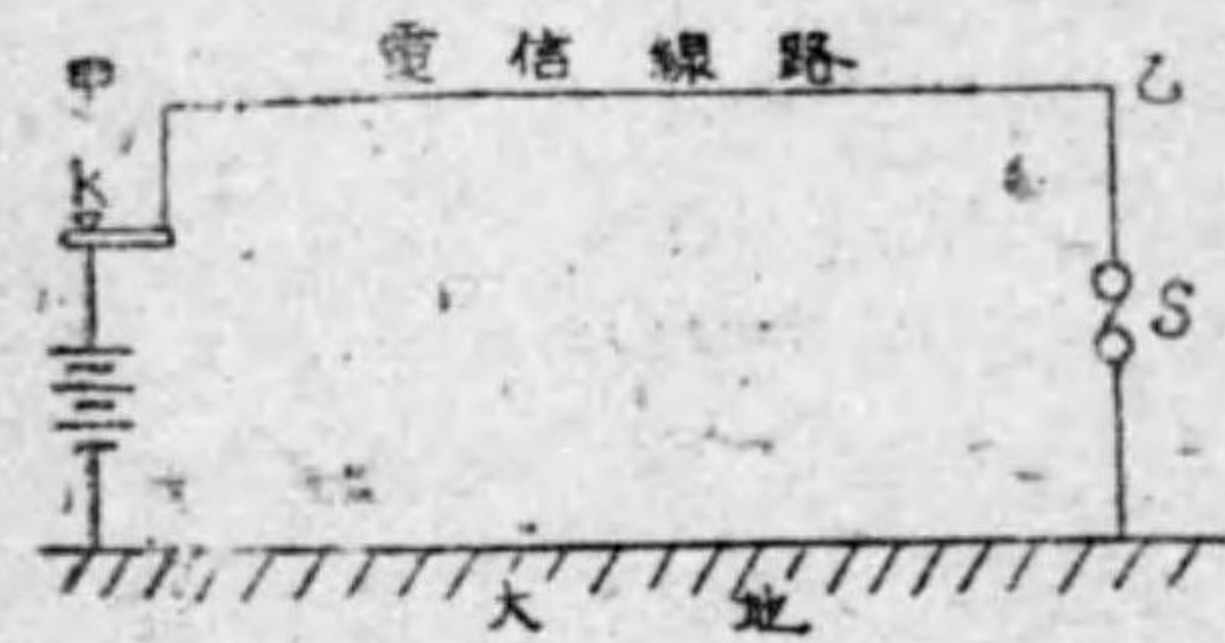
第1.1圖 有線電信の原理
