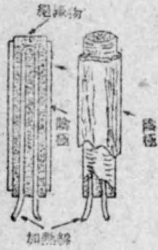
第 4.27 圖 傍熱型陰極の構造
