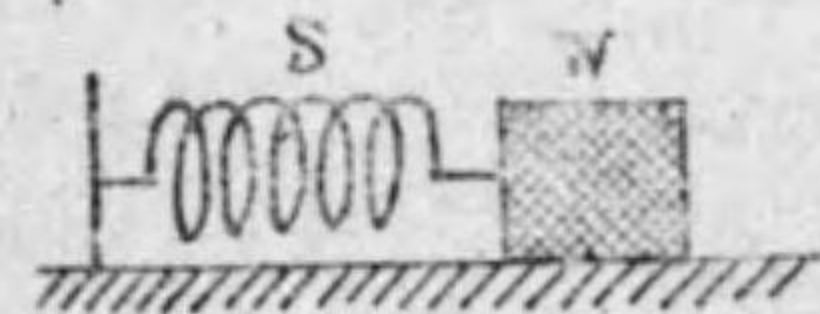
第3.11圖 機械的振動の1例
