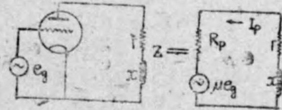
第 4.13 圖 三極真空管の等価回路
