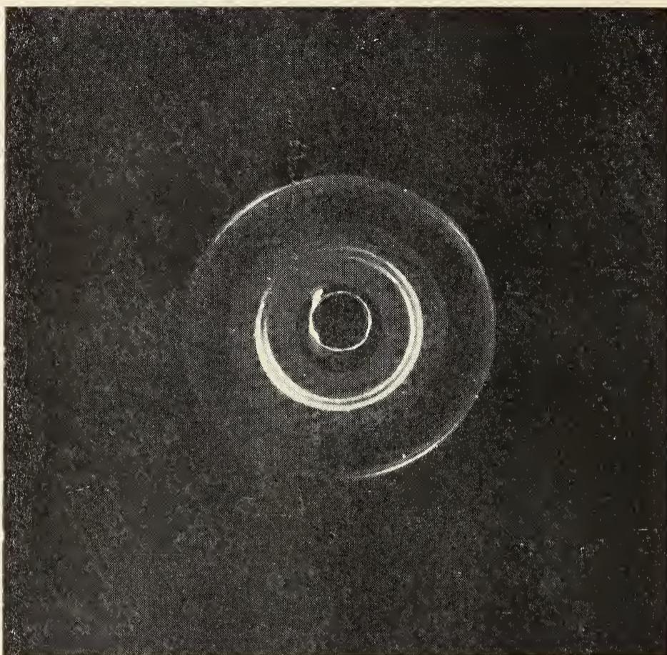
Fig. 6. — Diagrama de rayos X de la zona (1) de la Fig. 1, con anillos y puntos
