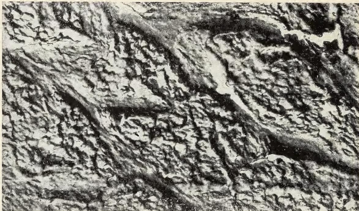
Fig. 3. — Prismas cortados oblicuamente. Réplica observada al microscopio electrónico de una muestra pulida y atacada. Nótese el ancho considerable de la sustancia interprismática. 8.600  $\times$ .
