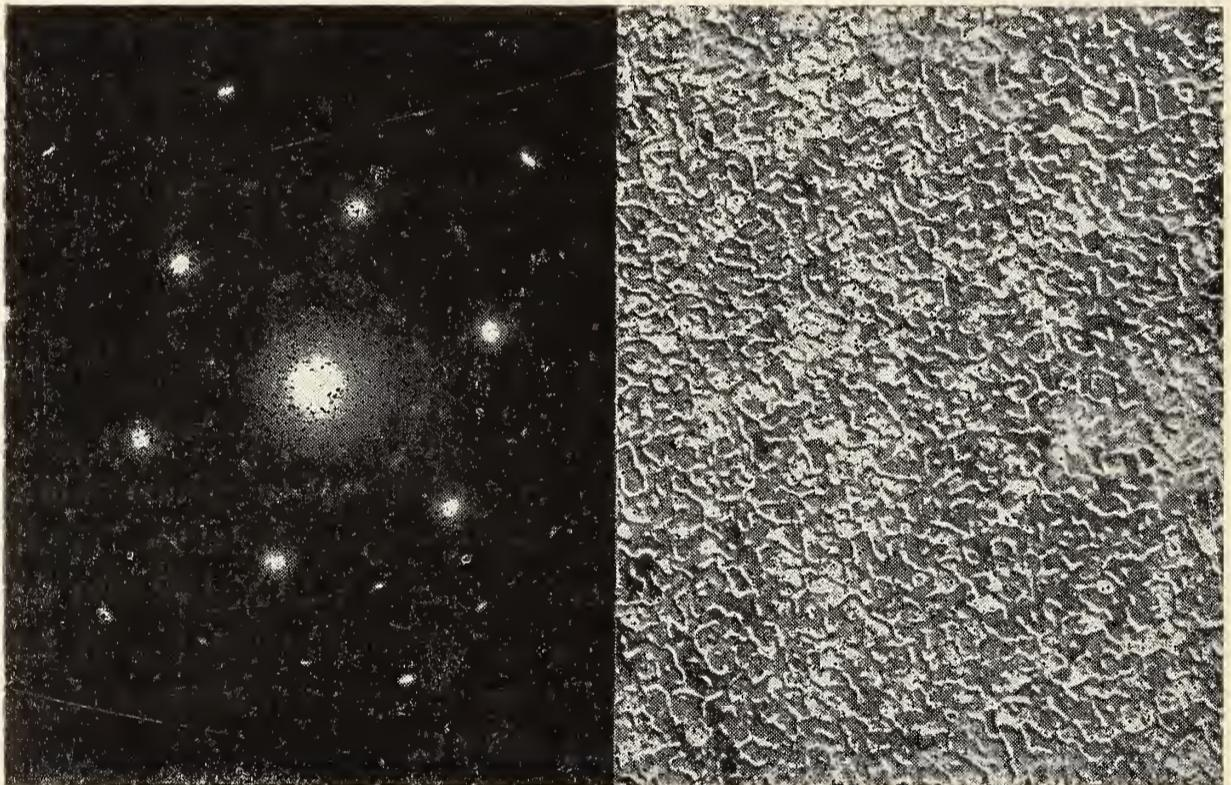
Fig. 2. — Diagrama de difracción de oro depositado sobre plata monocristalina, orientación  $\{111\}$ , sin ataque térmico; 60 kV. Aspecto de la zona correspondiente a este diagrama. 10,000  $\times$
