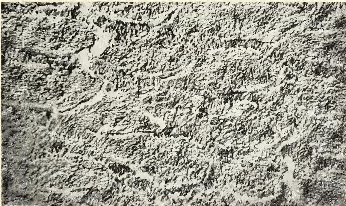
Fig. 2. — Prismas cortados oblicuamente. Réplica al microscopio electrónico de una muestra pulida y atacada. Compárese el poder separador con la figura anterior. 3.700  $\times$ .
