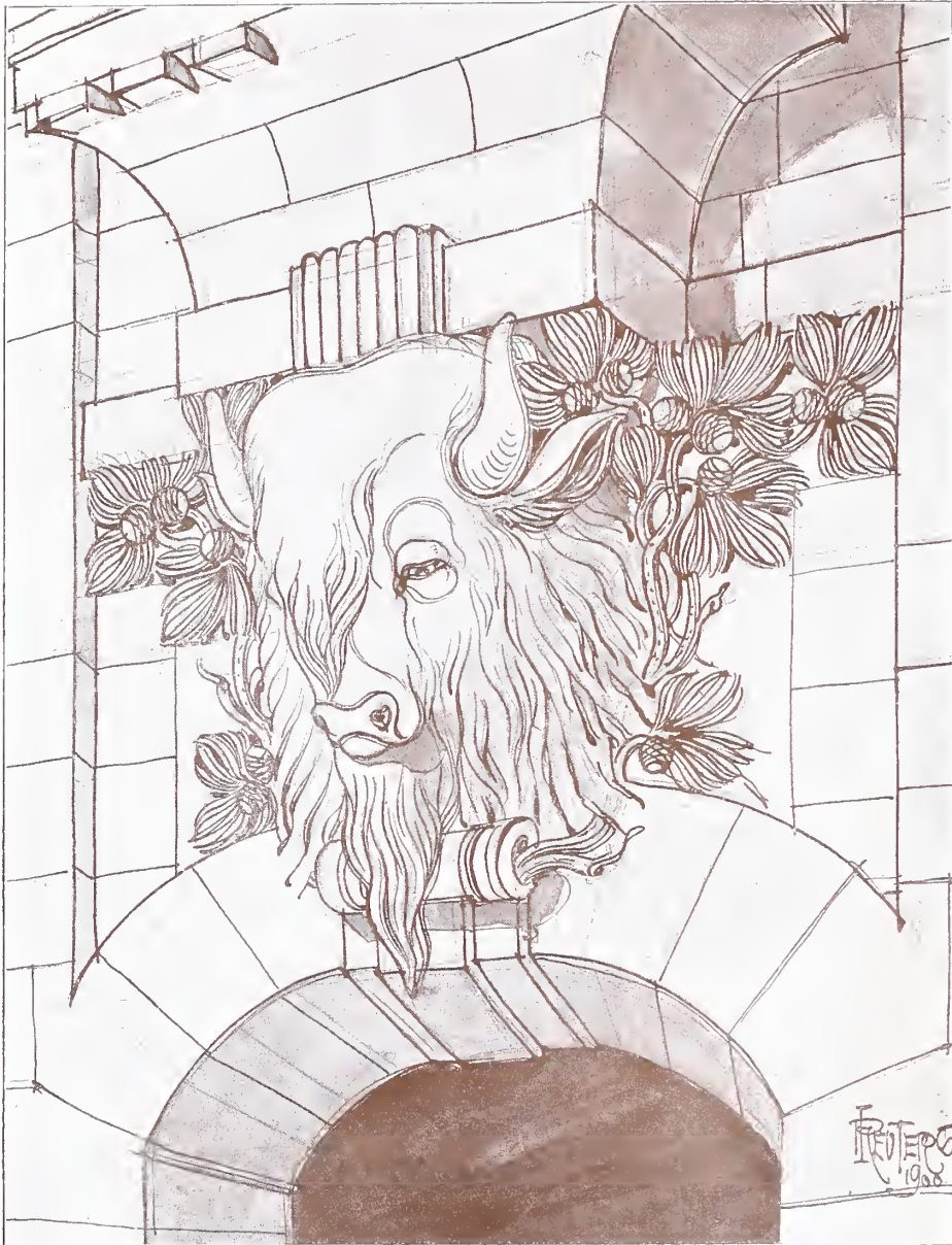
Erkerkonsole, zugleich Schlussstein für Fenster. Architekt: J. REUTERS in Wilmersdorf.
