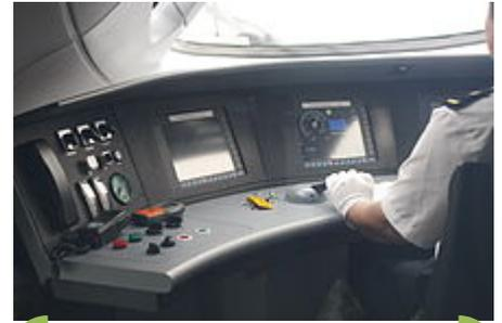
在第一列從天津西站發出的京滬高鐵列車(2011-06-30，G215，車號 60031)上拍攝的 CRH380A 駕駛室左部，能清楚的看到左部控制開關，也能清晰地看到控制電腦螢幕的大部分。
