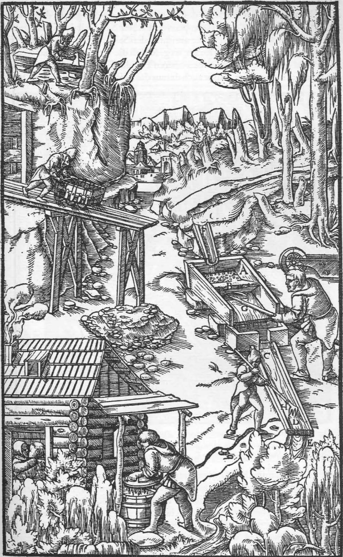
Der Trog A. Das Blech B. Der Graben C. Die Brettchen D. Der Sumpf E. Das kleine Gerinne F. Die Kiste G. Der Krähl H.
