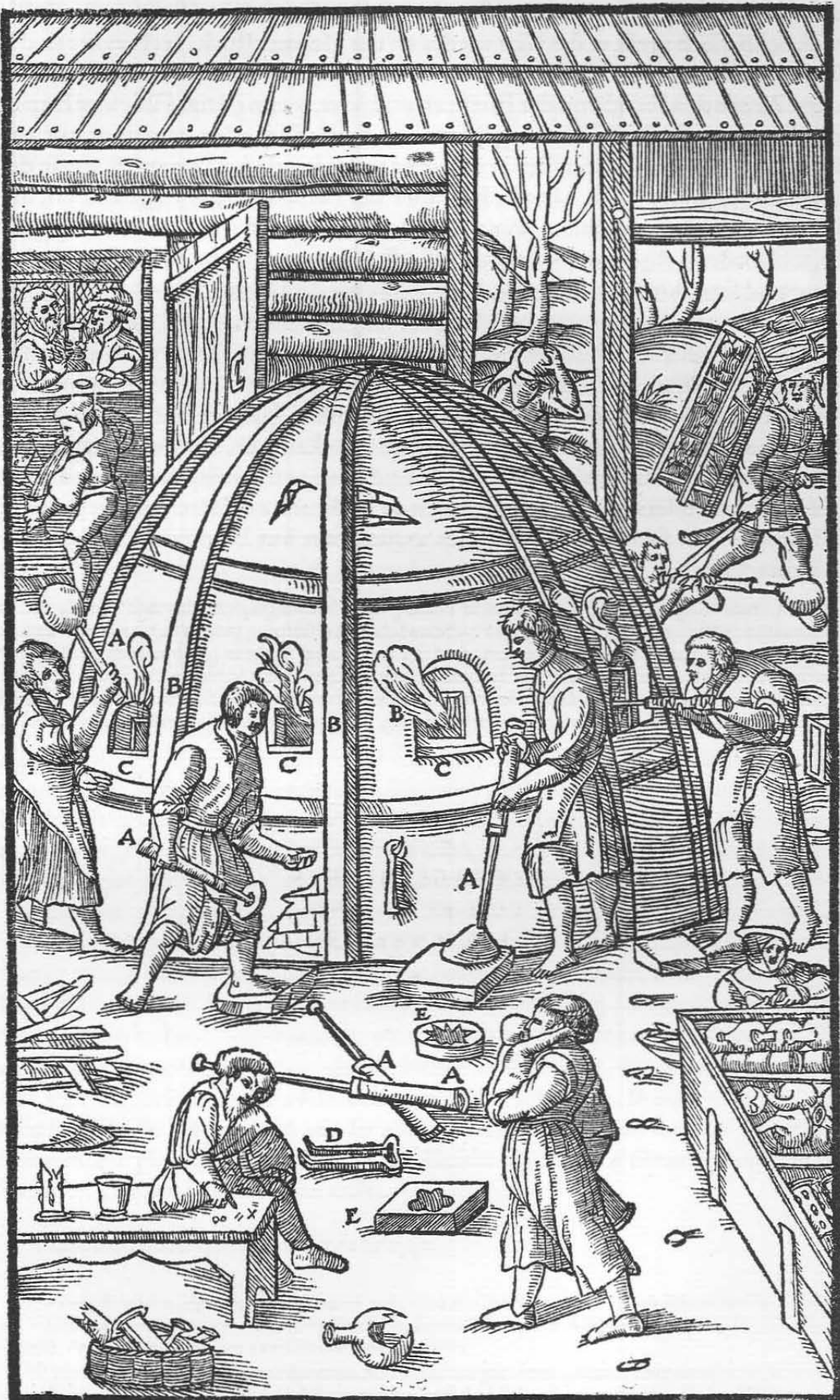
Die Pfeifen A. Die kleinen Fenster B. Die Marmorplatten C. Die Zange D. Formen für die Gestaltung der Glaswaren E.
