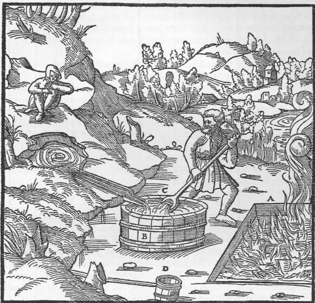
Die ausgehobene Grube A. Gefäß, in das die Sole geleitet wird B. Schöpflöffel C. Schöpfer mit eingelassenem Stiel D.
