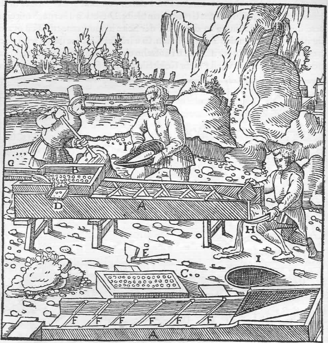
Das Gerinne A. Der Trog B. Sein umgekehrter Boden C. Sein seitlicher Auslaß D. Eine eiserne Kriech E. Die Brettchen F. Das Wassergerinne G. Der Sichertrog, in dem das, was sich abgesetzt hat, aufgefangen wird H. Ein Sichertrog, in dem es verwaschen wird I.
