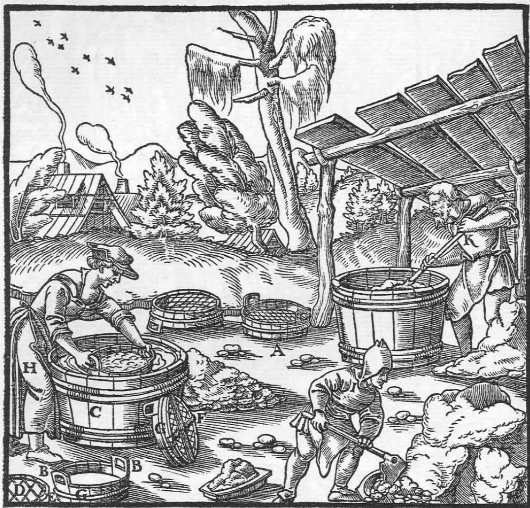
Das Sieb A. Seine Handhaben B. Das Faß C.
