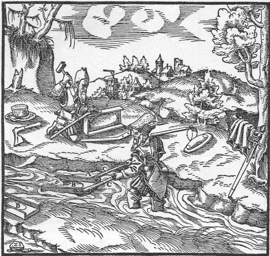
Der Läutertrog A. Seine Aushöhlung B. Seine Handhaben C.
