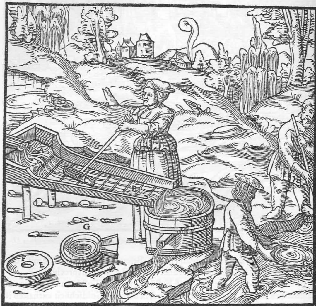
Das Haupt des Herdes A. Die Querleisten B. Die Kiste C. Das zugespitzte Hölzchen D. Eine Waschschüssel E. Die Vertiefung in der Mitte F. Eine Waschschüssel mit Rillen G.
