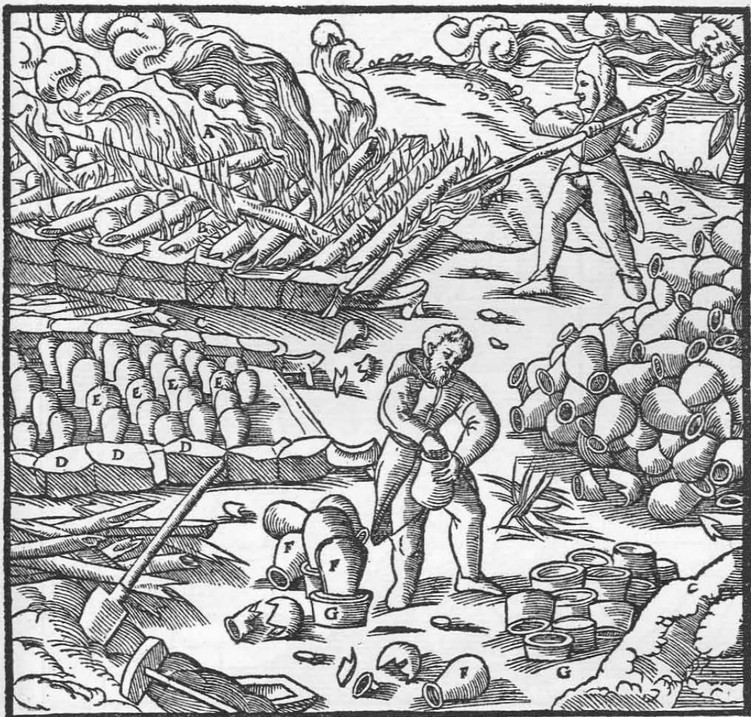
Die brennende Feuerstätte A. Die Hölzer B. Die nicht brennende Feuerstätte, in welche die Töpfe eingesetzt werden C. Die Steine D. Die Topfreihen E. Die oberen Töpfe F. Die unteren Töpfe G.
