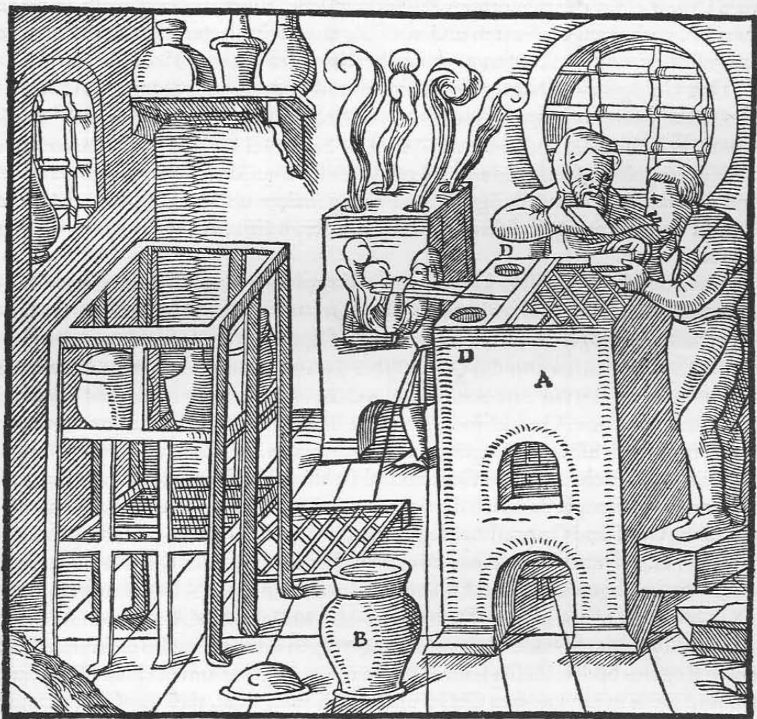
Der Ofen A. Der Topf B. Der Deckel C. Die Windlöcher D.
