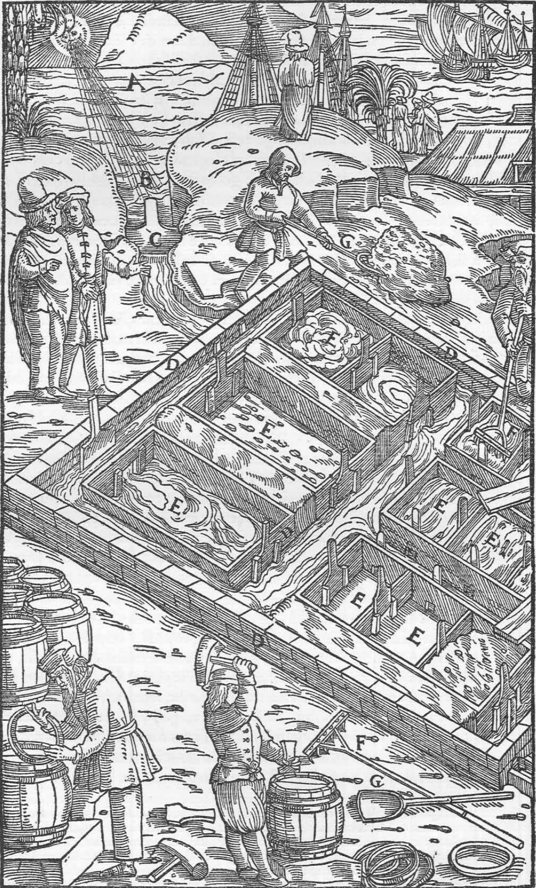
Das Meer A. Die Lagune B. Schleuse C. Gräben D. Salzkrusten E. Rechen F. Schaufel G.
