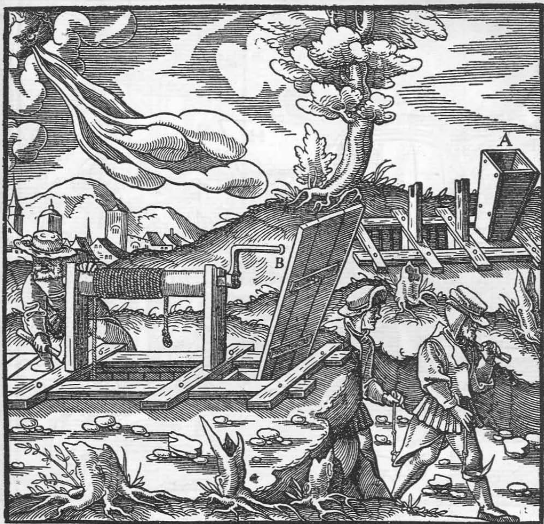
Die herausragende Luttenöffnung A. Die an die nicht herausragende Lutte angeschlagenen Bretter B.
