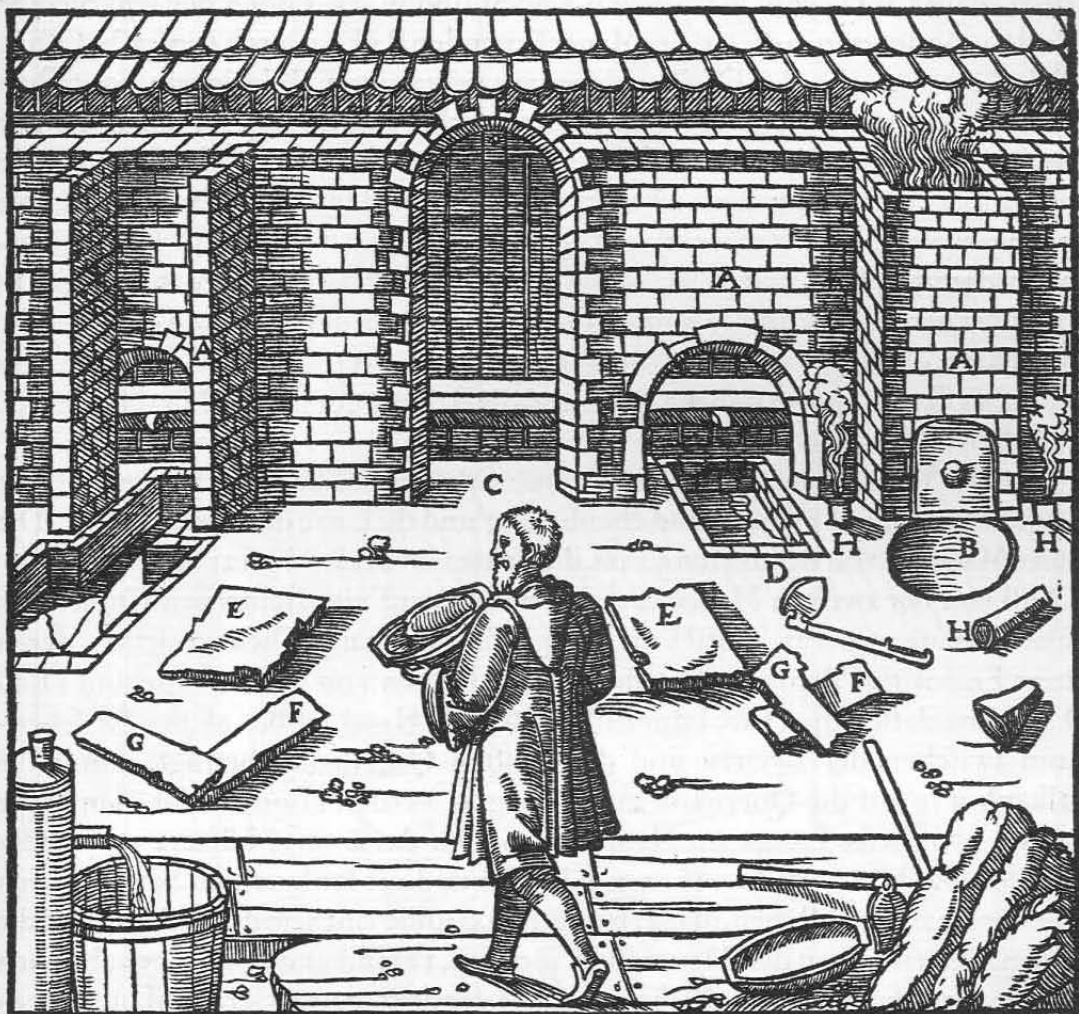
Die Schmelzöfen A. Der Vorherd B. Die Thür C. Der versenkte Feuchtigkeitsbehälter D. Platte zum Bedecken desselben E. Gemauerter Kanal F. Platten zum Bedecken desselben G. Rohr, durch das die Dämpfe entweichen H.
