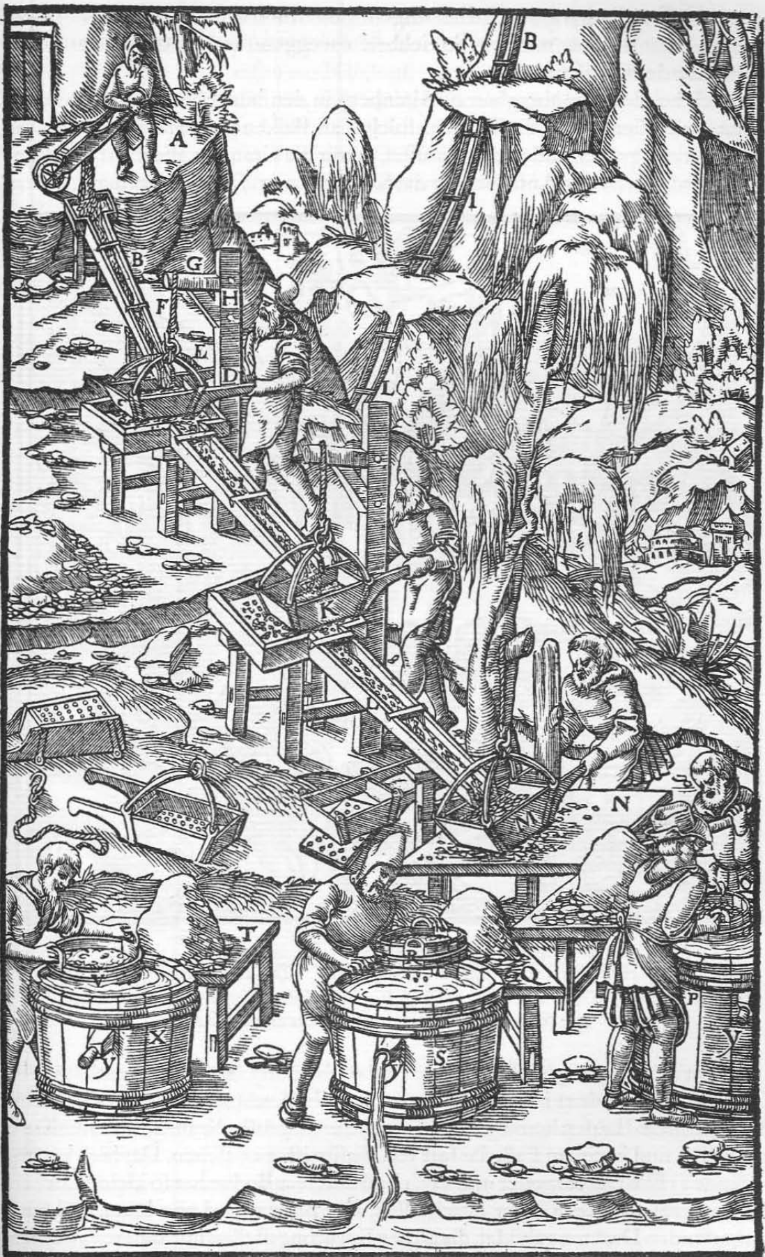
Der Karrenläufer, der das Hauswerk heranzführt A. Das erste Gerinne B. Das erste Kasten-sieb C. Seine Hand-haben D. Dessen Bögen E. Der Strick F. Der Balken G. Die Säule H. Das zweite Gerinne I. Das zweite Kasten-sieb K. Das dritte Gerinne L. Das dritte Kasten-sieb M. Die erste Bühne N. Das erste Hand-sieb O. Das erste Faß P. Die zweite Bühne Q. Das zweite Hand-sieb R. Das zweite Faß S. Die dritte Bühne T. Das dritte Hand-sieb V. Das dritte Faß X. Der Spund Y.
