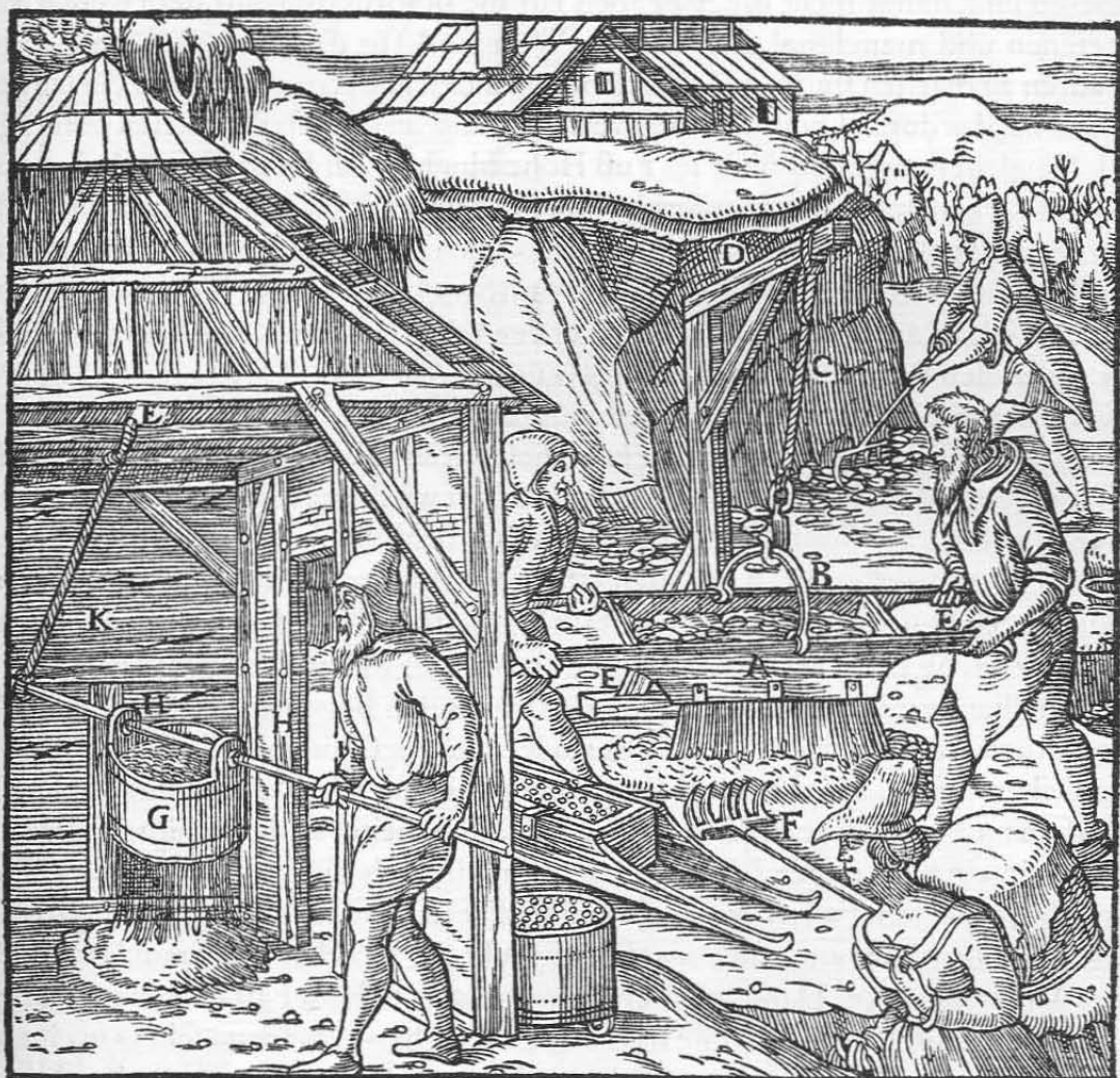
Das große Sieb A. Der halbkreisförmige Bogen B. Der Strick C. Der Galgen D. Die Handgriffe E. Der fünfzinkige Krähl F. Das kleine Sieb G. Seine Henkel H. Die Stange I. Der Strick K. Der Balken L.
