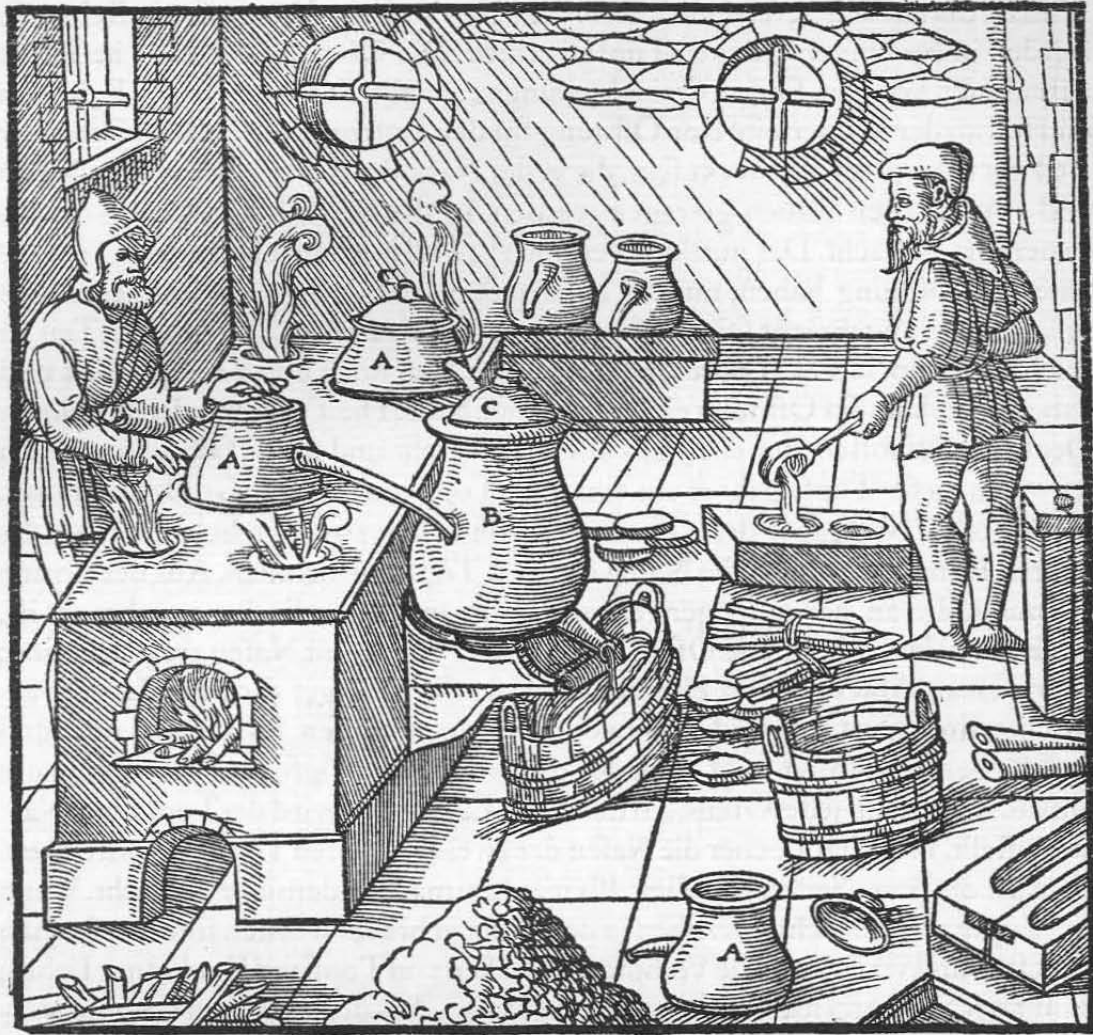
Die Gefäße mit Nasen A. Das Gefäß ohne Nase B. Der Deckel C.
