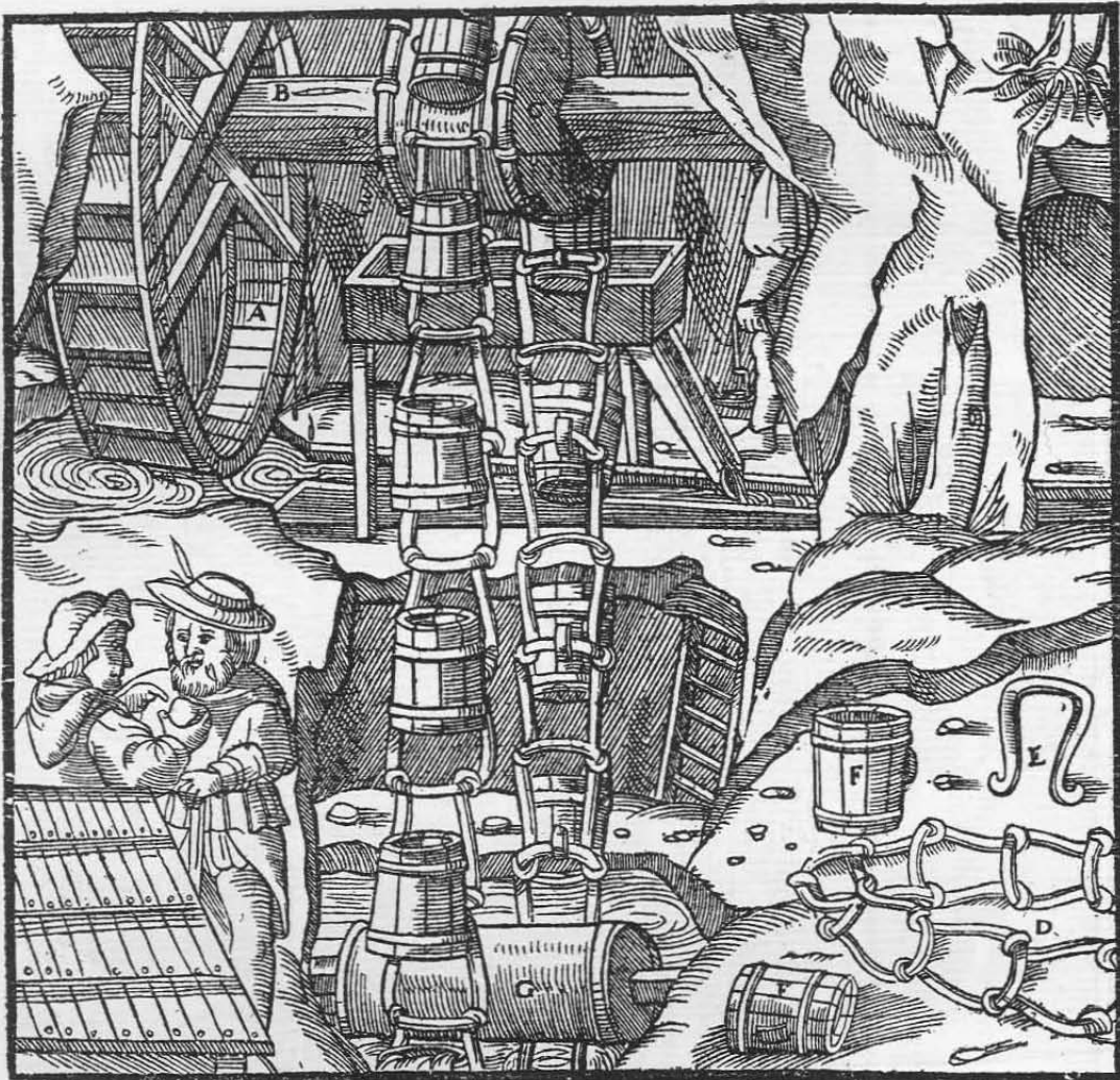
Das Unterschlächtige Wasserrad A. Die Welle B. Die Trommel, auf der Klammern eingeschlagen sind C. Die Kette D. Ein Kettenglied E. Die Kannen F. Die untere Trommel G.
