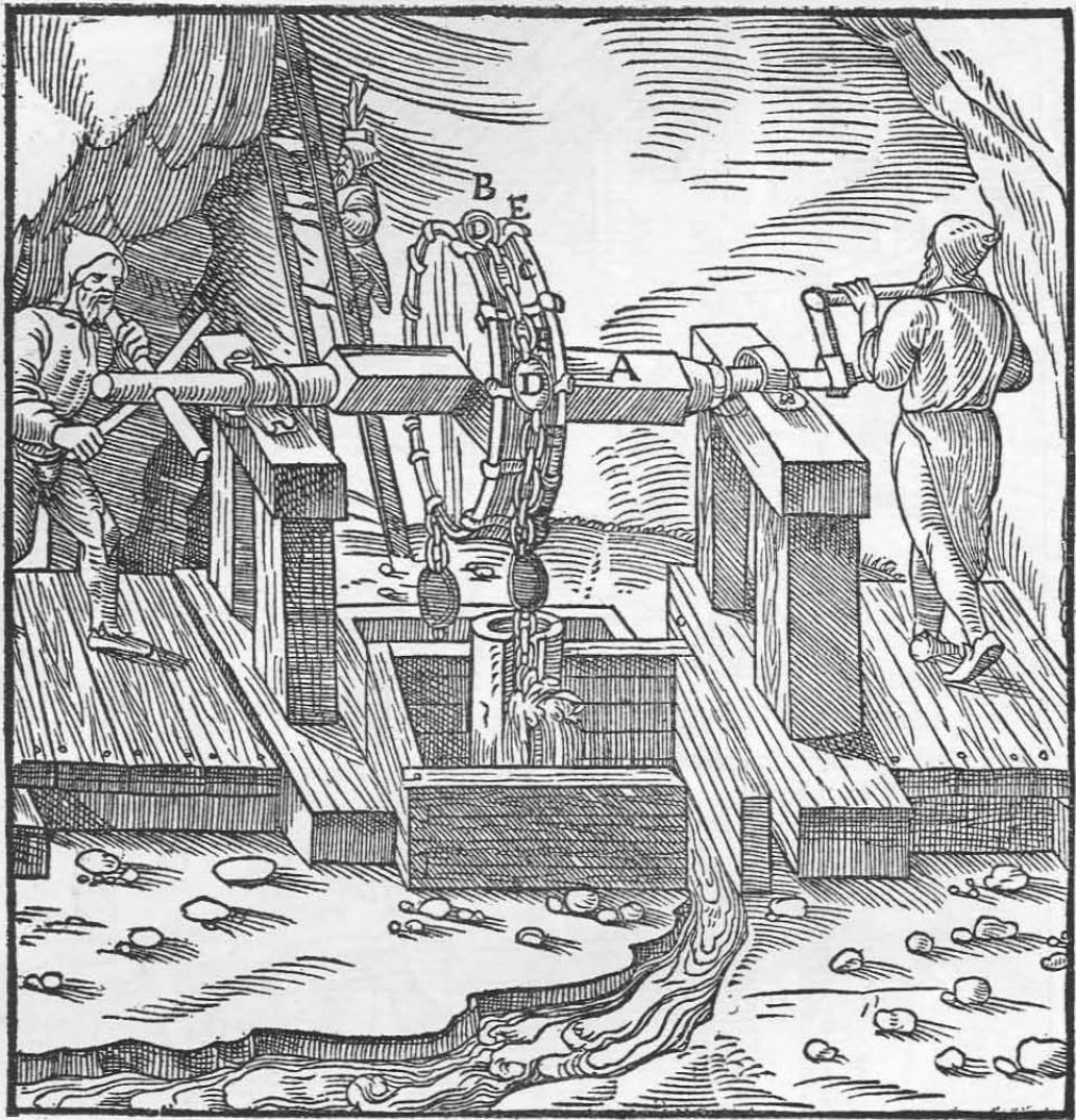
Der Rundbaum A. Der Kettenkorb B. Die Förderkette C. Die Taschen D. Die Klammern E.
