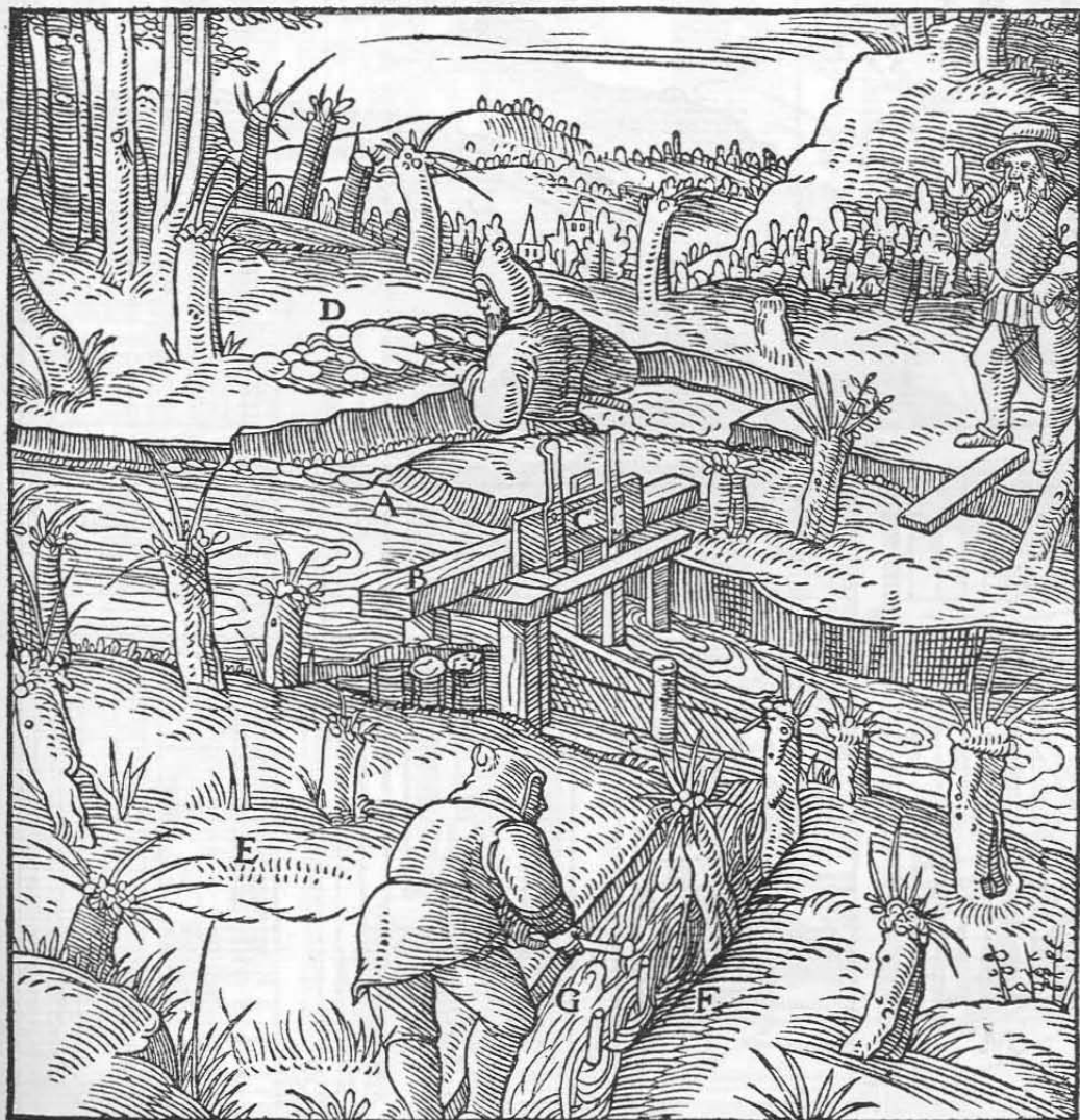
Der Fluß A. Das Wehr B. Der Schützen C. Der Graben D. Die Wiese E. Der Zaun F. Der Graben G.
