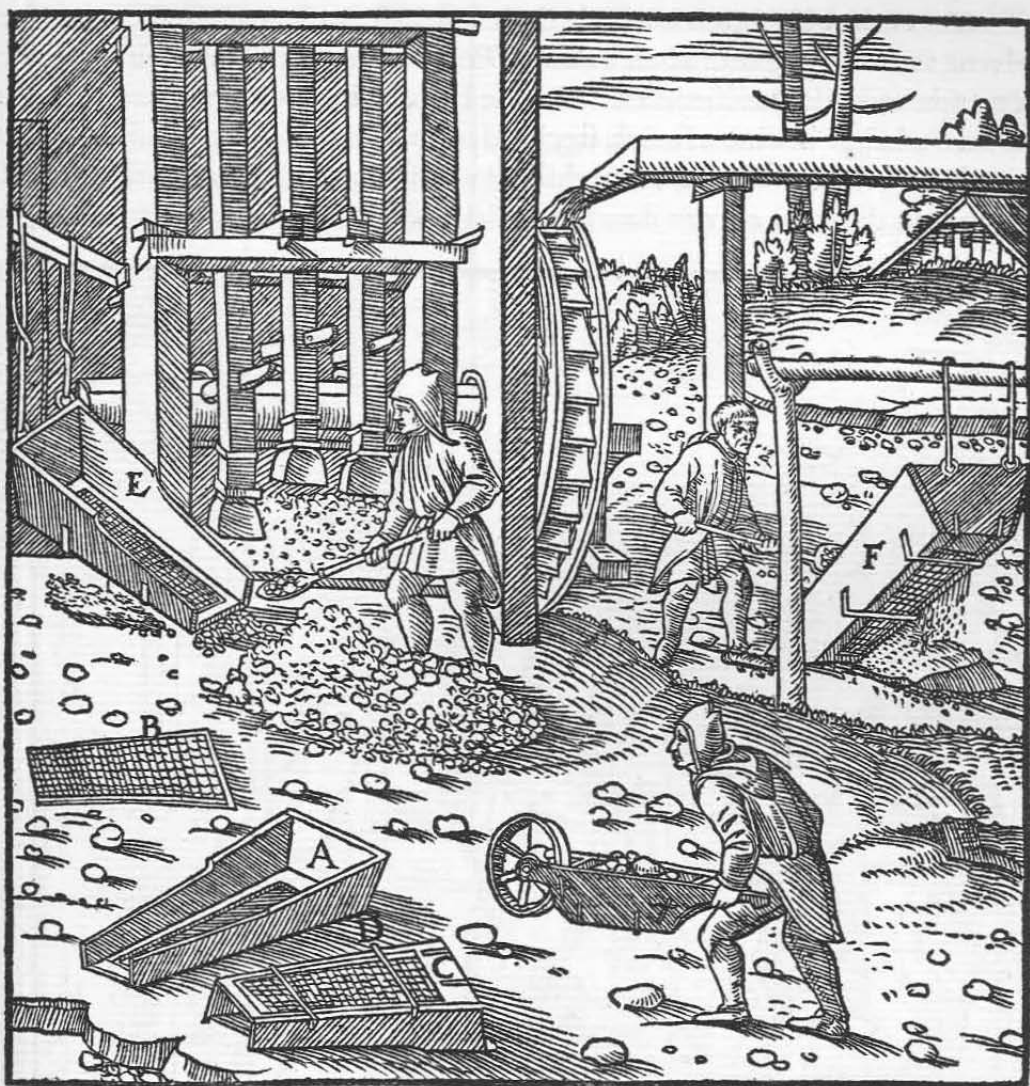
Ein Durchwurf richtig auf die Erde gestellt A. Sein Boden, der aus eisernen Drähten besteht B. Ein umgekehrter Durchwurf C. Ein eiserner Stab D. Durchwurf, an einer Stange aufgehängt, dessen Boden man von oben sieht E. Durchwurf, an einem Balken aufgehängt, dessen Boden man von unten sieht F.
