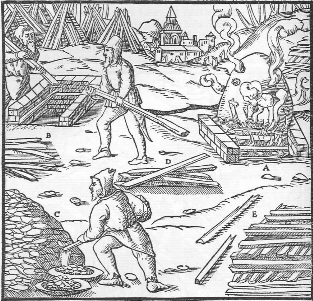
Der angezündete Röststadel A. Ein Röststadel, der hergerichtet wird B. Das Erz C. Der Erzhaufen auf dem Röststadel D. Der Holzhaufen E.
