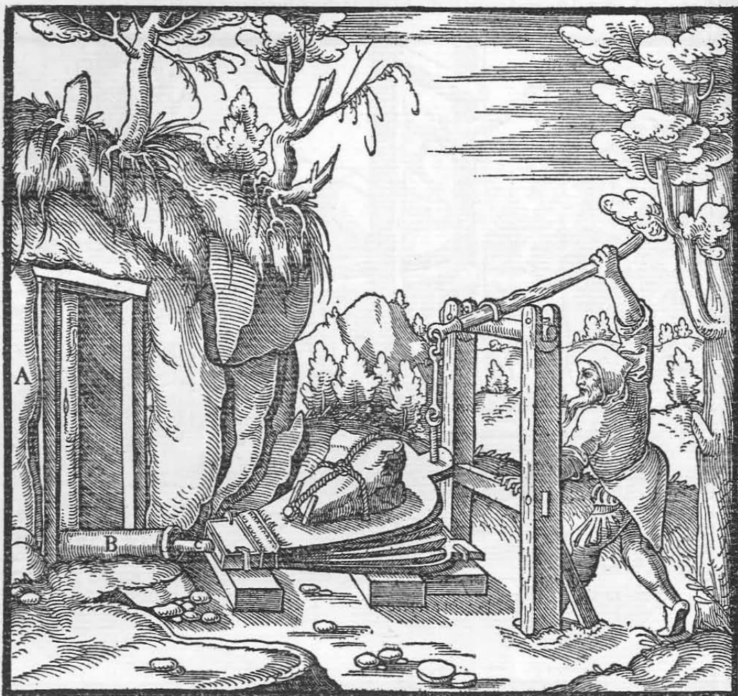
Der Stollen A. Die Rohre B. Das Mundstück des doppelt wirkenden Blasebalges C.
