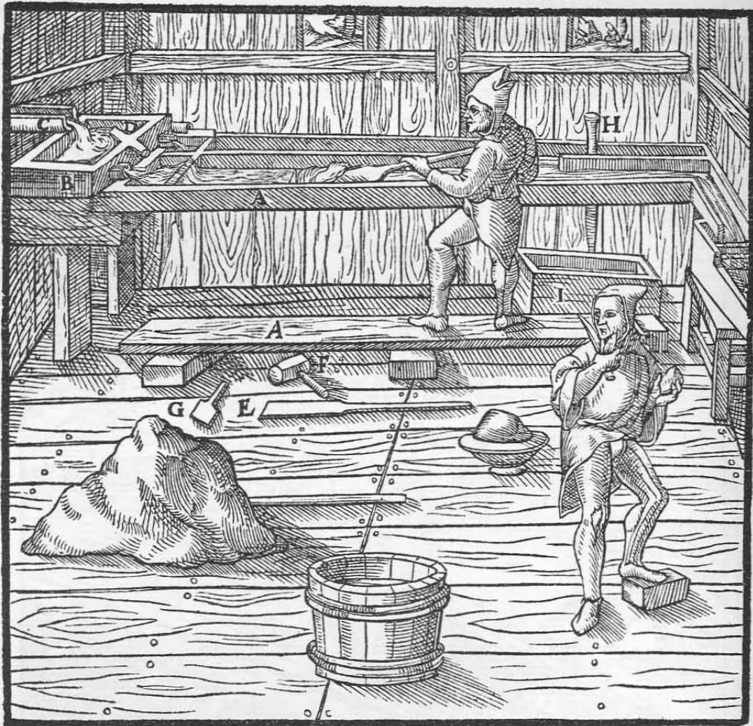
Die Gräben A. Der Trog B. Das kleine Gerinne C. Der runde Zapfen D. Die hölzerne Schaufel E. Der hölzerne Hammer F. Die hölzerne Schaufel mit kurzem Stiel G. Der im Gerinne angebrachte Zapfen H. Der daruntergestellte Trog I.
