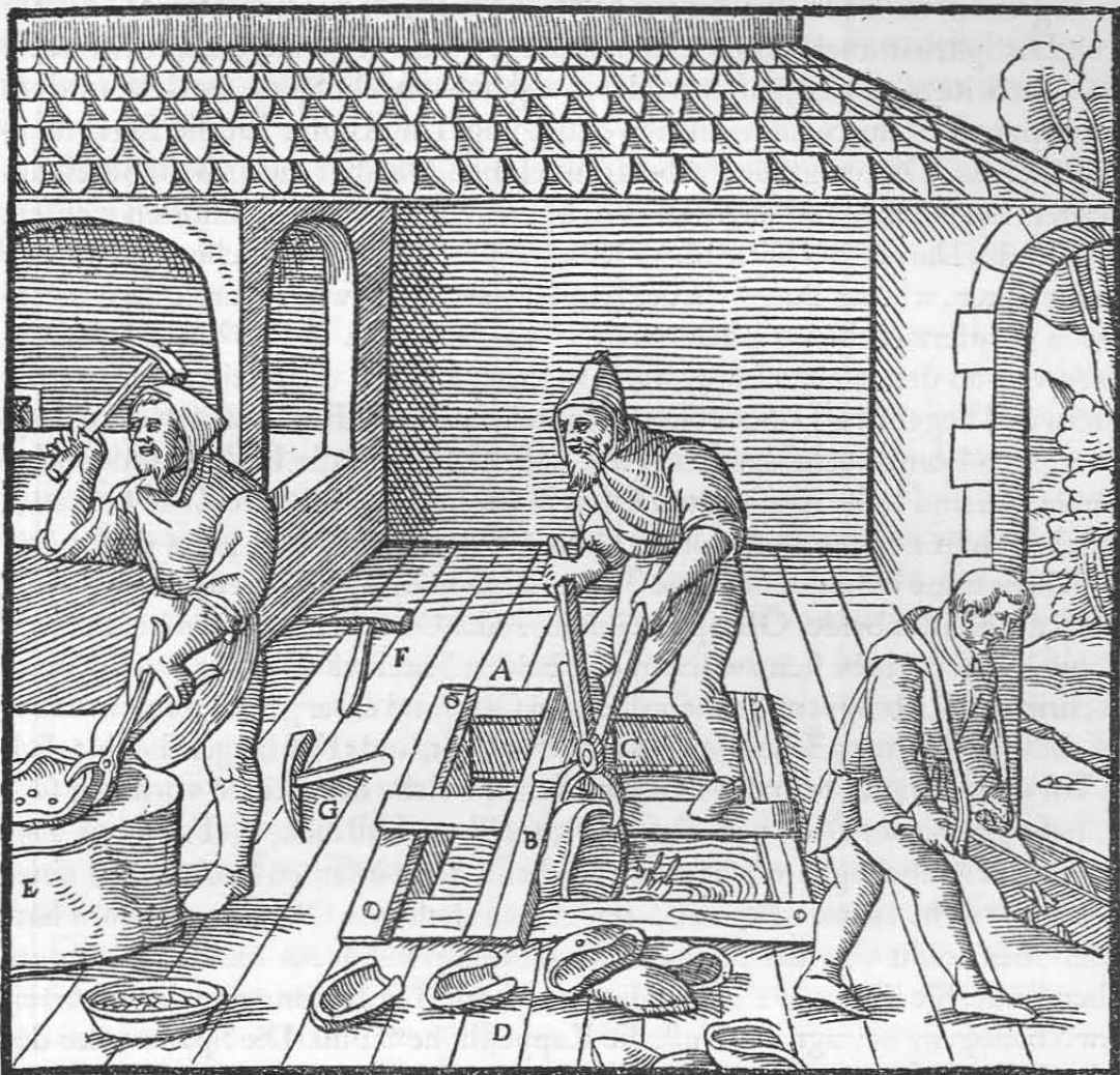
Der Wasserbehälter A. Das Brett B. Die Zange C. Die aus dem Behälter herausgeholtten Darrlinge D. Der Eichenklötz E. Der abgerundete Hammer F. Der Spitzhammer G.
