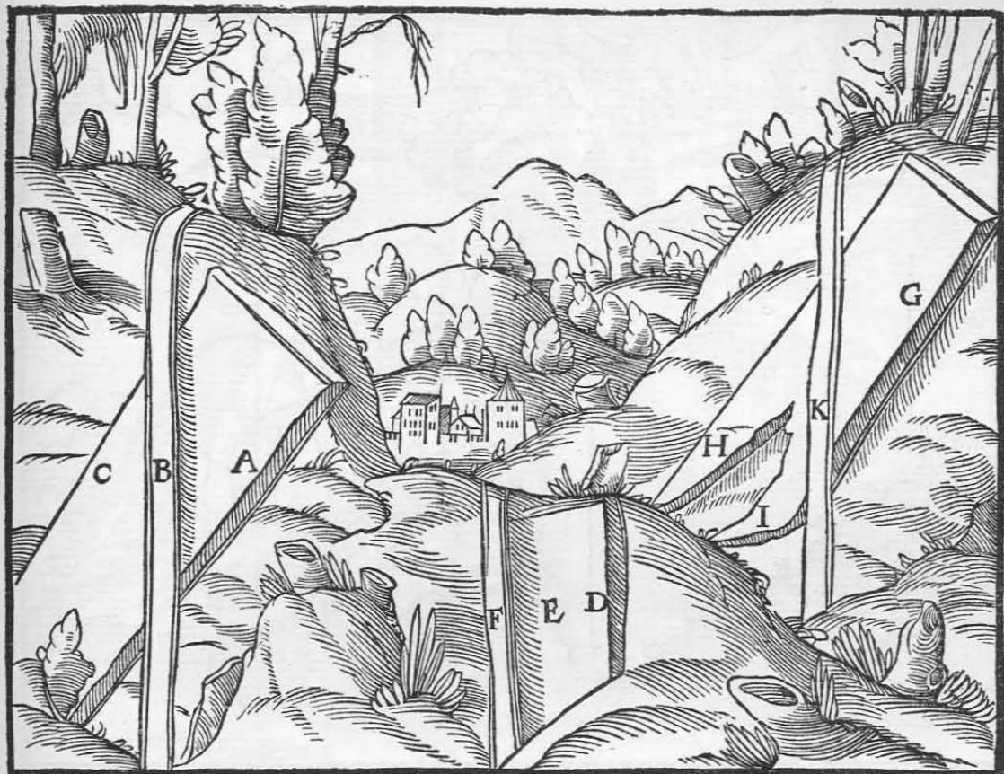
Ein Flöz, einen Gang schneidend A, C. Der Gang B. Ein Flöz, mit einem Gang sich vereinigend D, E. Der Gang F. Ein Flöz G. Teilstücke dieses Flözes H, I. Der Gang, ein Flöz zerteilend K.
