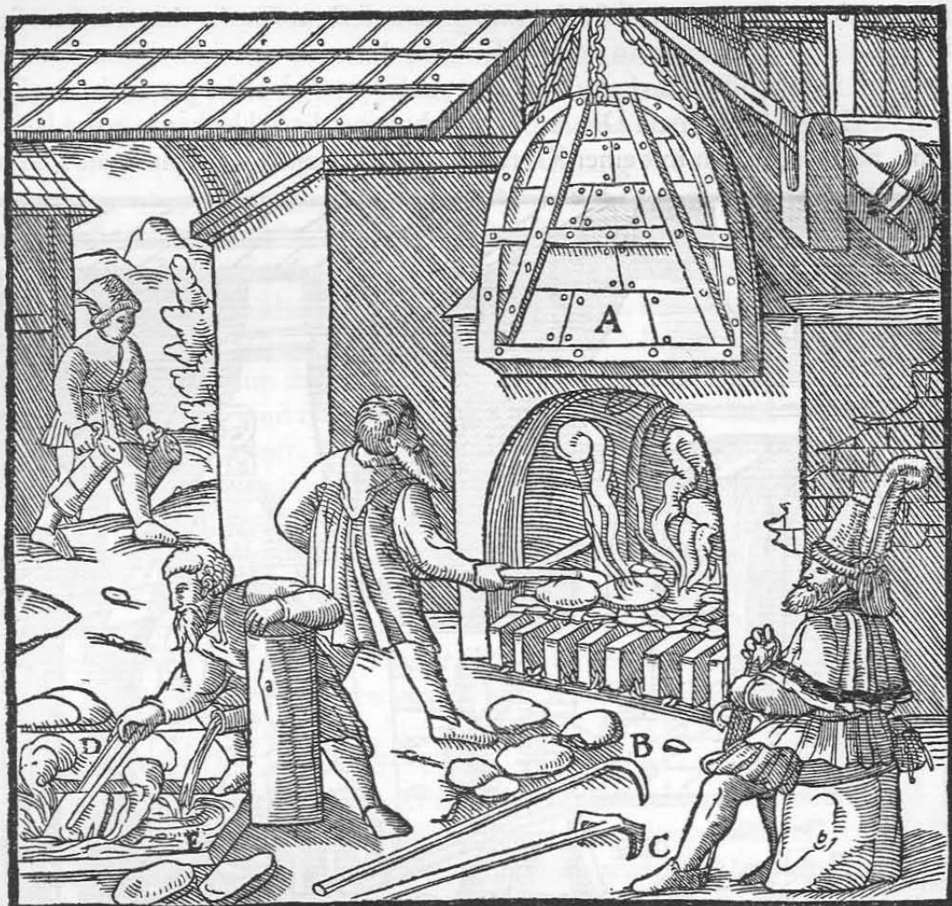
Die hochgezogene Tür A. Der Haken B. Der zweizinkige Krähl C. Die Zange D. Der Wasserbehälter E.
