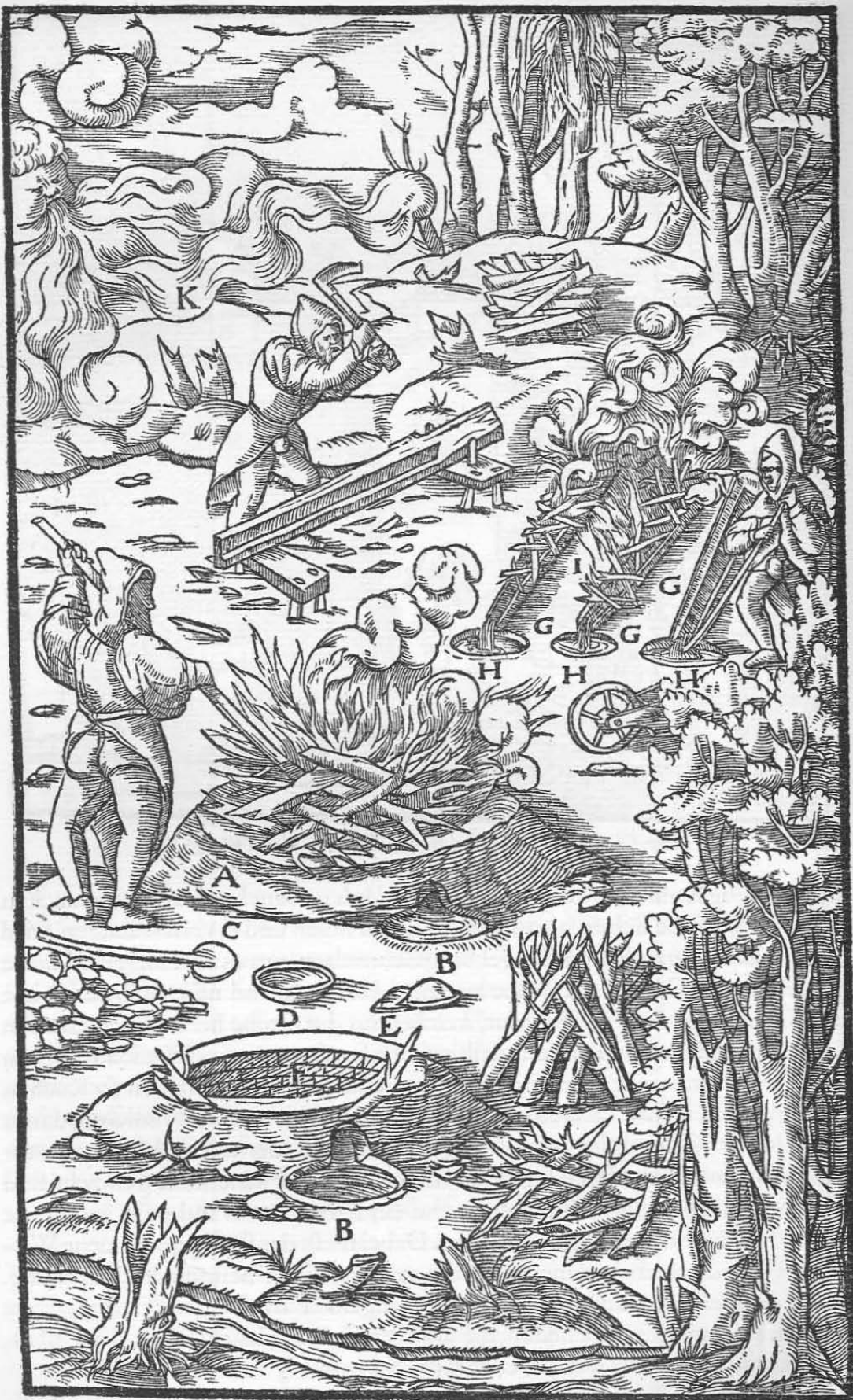
Die Grube mit darüberegelegten Holzscheiten A. Der Vorherd B. Die Kelle C. Eiserne Gußformen D. Metallkuchen E. Leere, mit Steinen ausgekleidete Grube F. Holzrinne G. Die Sammelgruben der Rinnen H. Das über die Rinnen gelegte kleine Holz I. Der Wind K.
