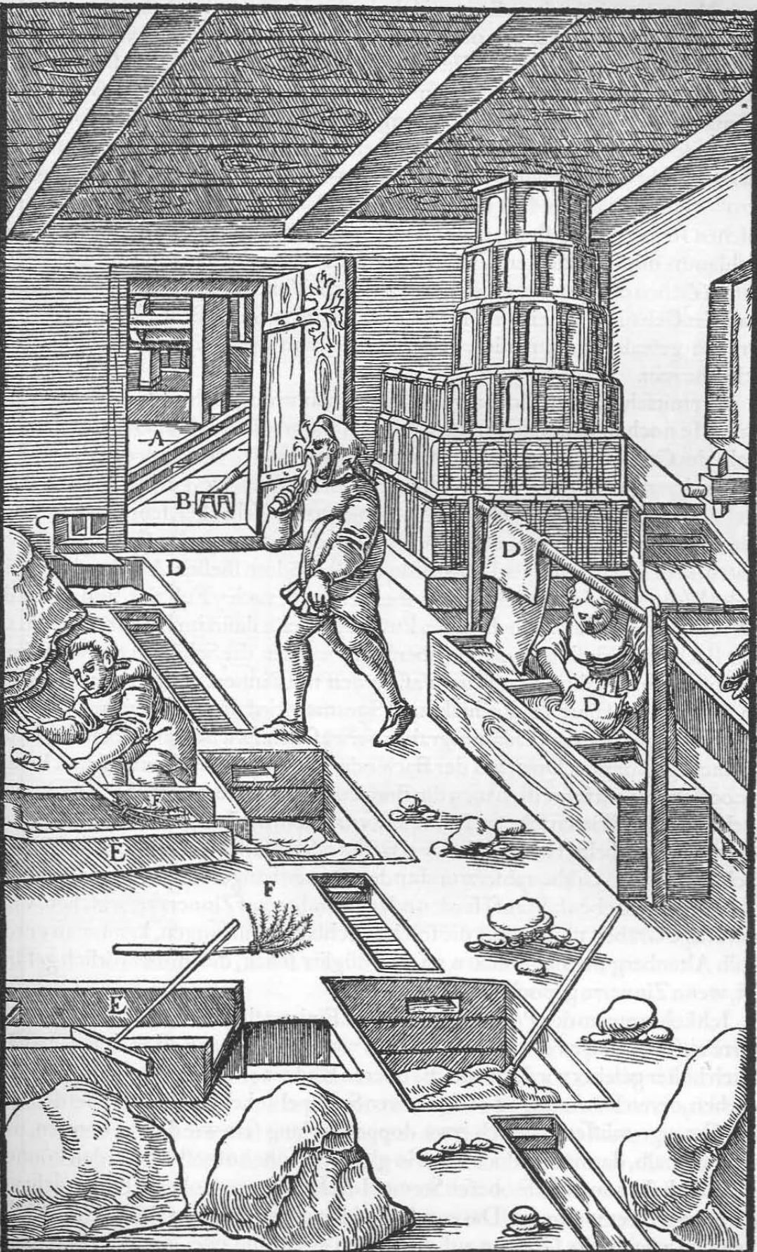
Das Gerinne, das an das gelochte Blech des Pochtroges anschließt A. Der dreizinkige Krähl B. Der kleine Trog C. Die Planen D. Der Schlammgraben E. Die Besen F.
