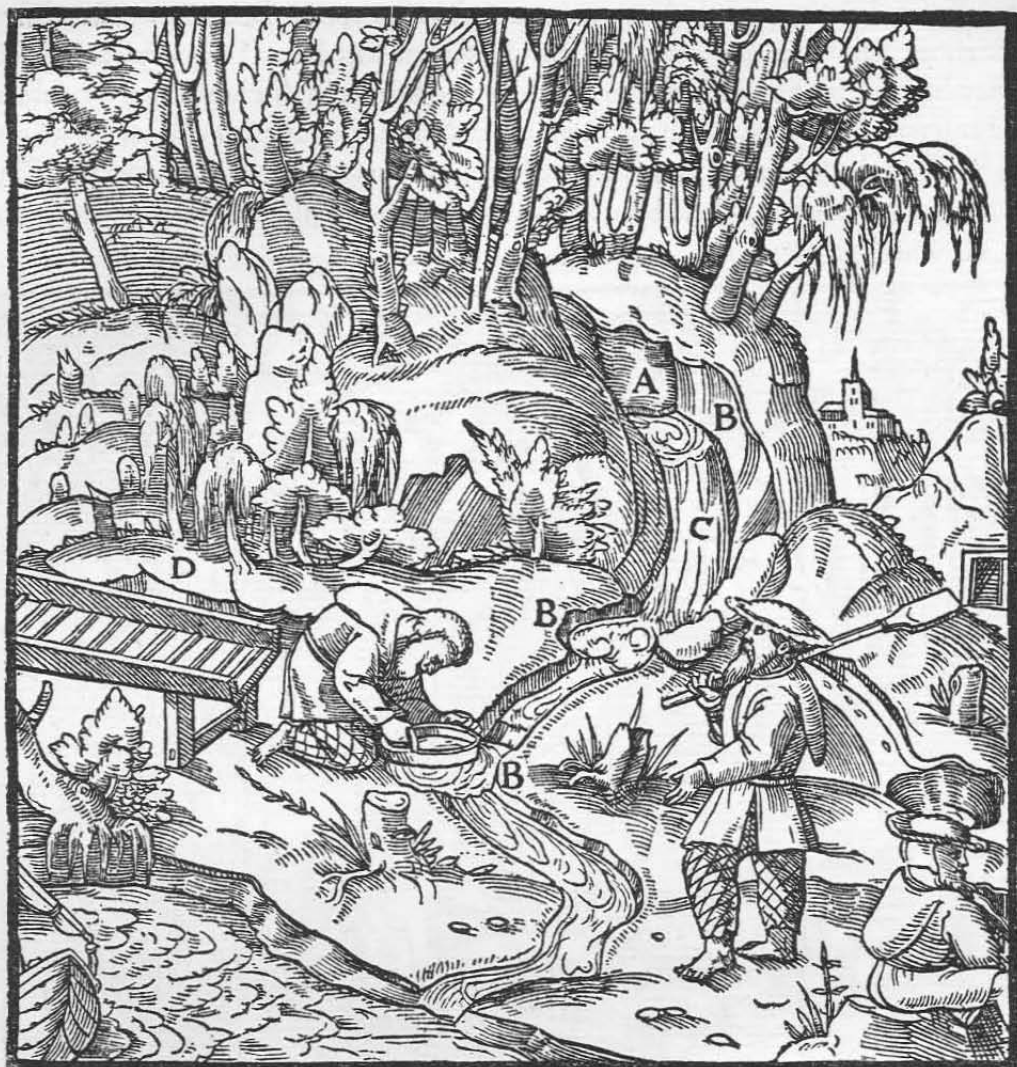
Die Schlucht A. Die Gräben B. Das strömende Wasser C. Der Herd der Lusitanier D.
