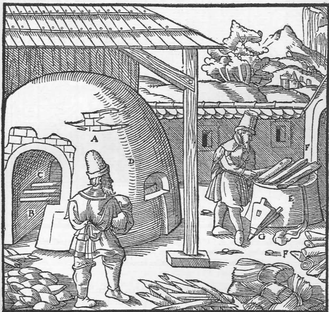
Ein backofenartiger Ofen A. Die Gasse B. Der Eisenrost C. Die Arbeitsöffnung, durch welche man die Glätte abzieht D. Ein Herd ohne Treibehaube E. Die dicken Holzscheite F. Der Blasebalg G.
