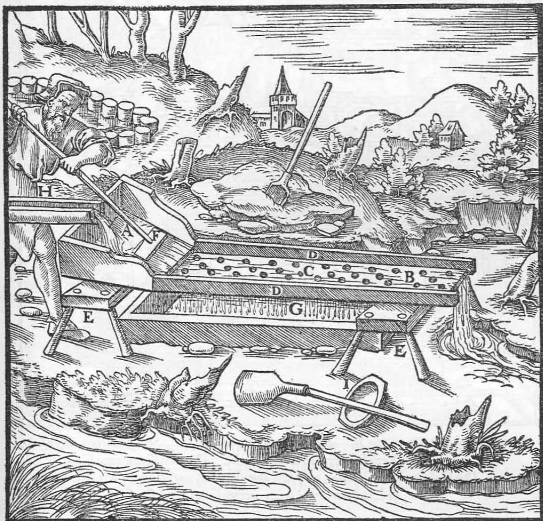
Das Haupt des Herdes A. Der Herd B. Die Löcher C. Die Seitenbretter D. Die Schemel E. Die Kiste F. Der Waschtrog G. Das Gerinne H. Der Sichertrog I.
