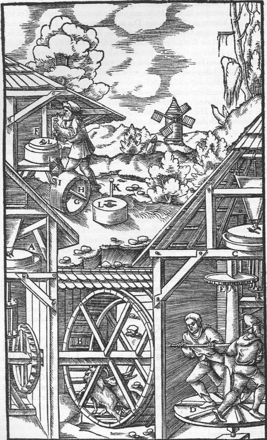
Die erste Mühle A. Das von Ziegen getretene Rad B. Die zweite Mühle C. Die Scheibe an der stehenden Welle D. Deren Kammrad E. Die dritte Mühle F. Die Form des unteren Mühlsteins G. Die senkrechte Achse H. Deren Bohrung I. Des Läufersteins Handhabe K. Seine Öffnung L.
