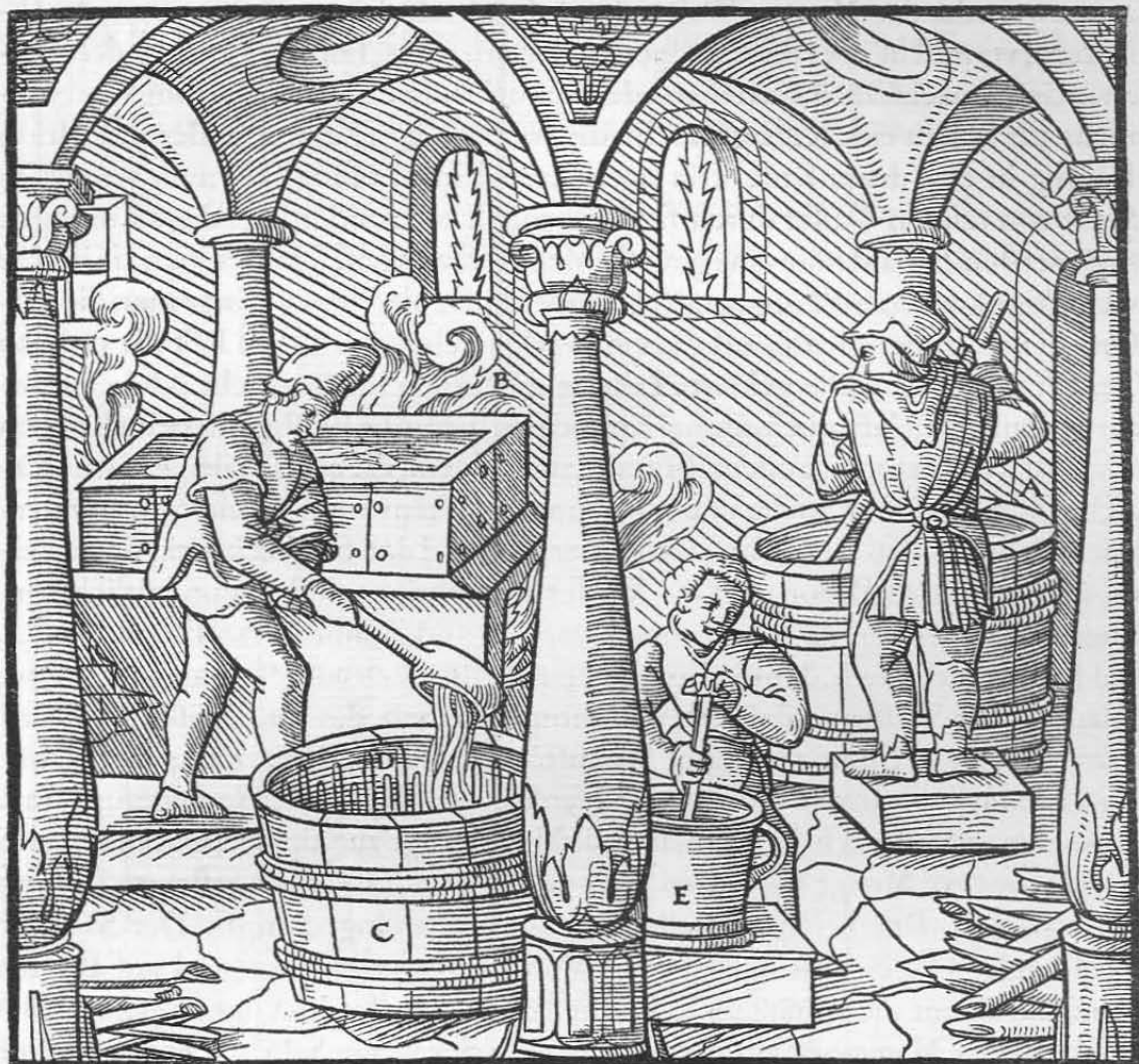
Kufe, in der Soda mit Harn vermischet wird A. Die Pfanne B. Kufe, in der sich die Chryfokolla abscheidet C. Kupferstäbe D. Mörser E.
