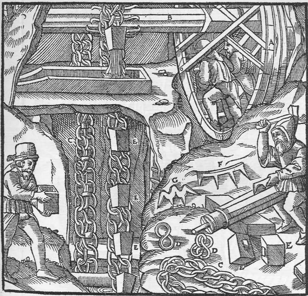
Das Tretrad A. Die Welle B. Die doppelte Kette C. Ein Glied der doppelten Kette D. Die Kannen E. Eine einfache Klammer F. Eine dreimal gekrümmte Klammer G.
