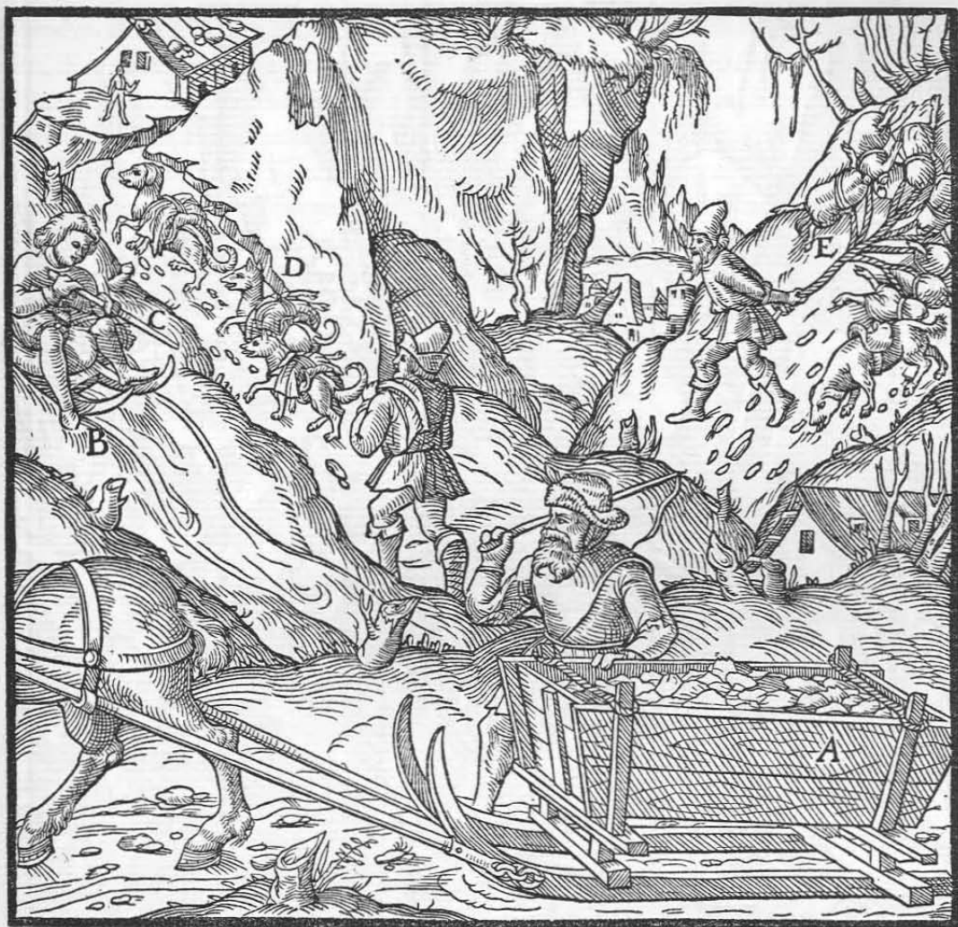
Ein Schlitten A. Eine Schleife mit Säcken B. Der Stab C. Die Hunde mit Saumfätteln D. Die an einem Strick befestigten schweinsledernen Säcke E.
