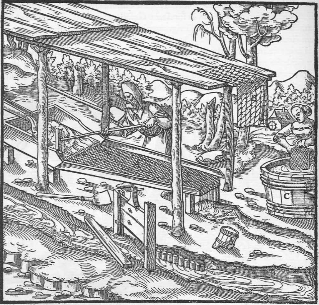
Das aufgelegte Gewebe mit vielen Knoten A. Die Knoten deutlicher sichtbar B. Das Faß, in dem das Tuch gewaschen wird C.
