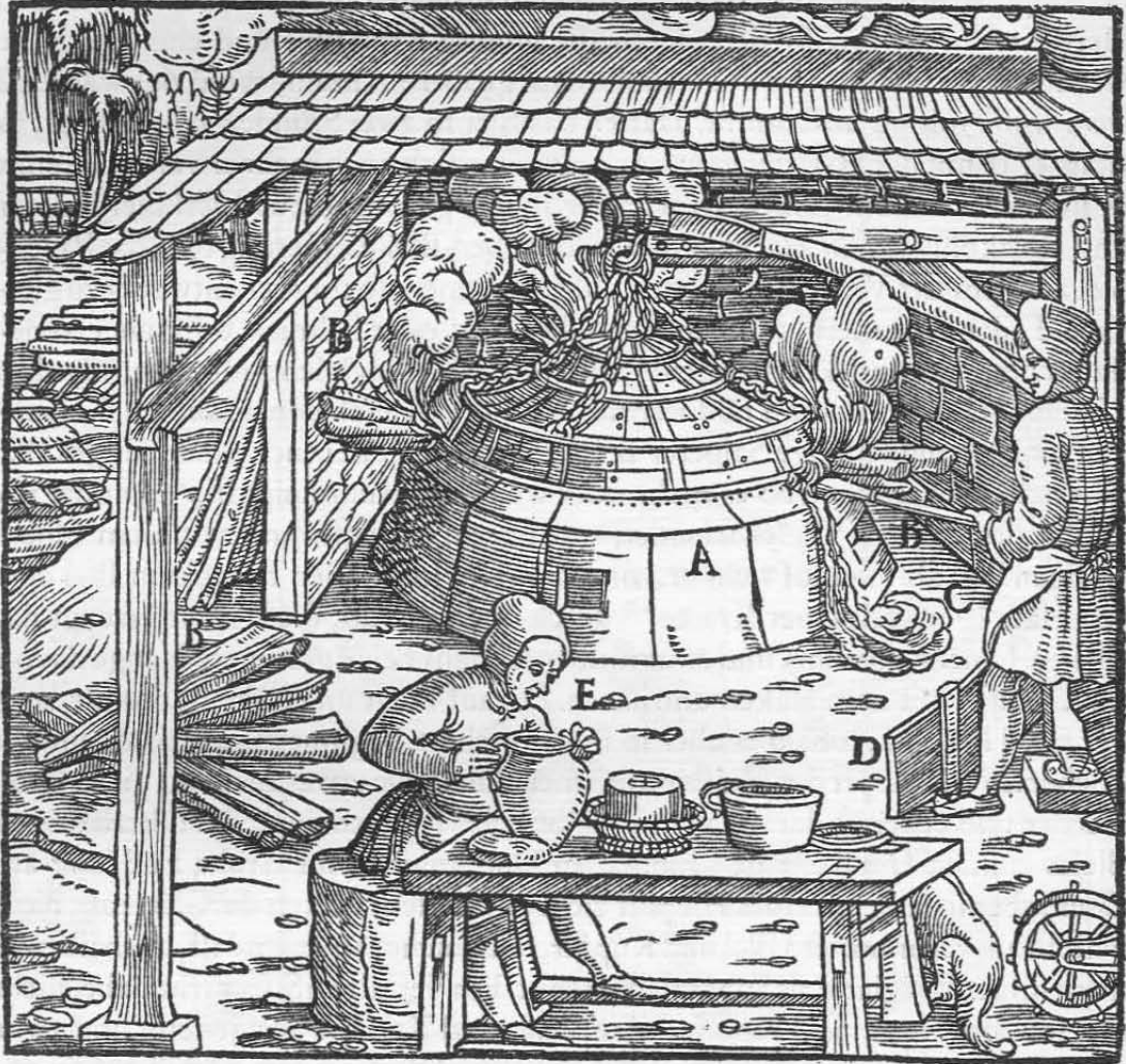
Der Ofen A. Die Holzschneite B. Die Silberglätte C. Das Blech D.
