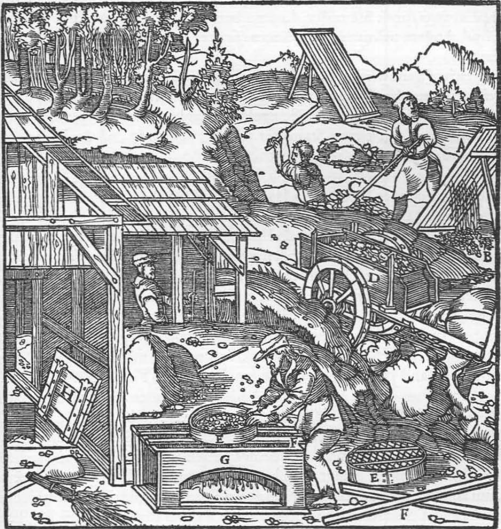
Das Stangensieb A. Die Stütze B. Eine Schaufel C. Ein zweirädriger Karren D. Das Sieb E. Die Querstäbe F. Das Sammelgefäß G. Die abgedeckte Grube H.
