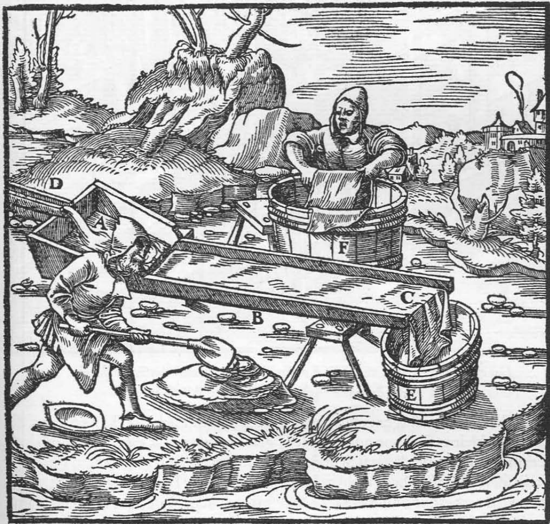
Das Haupt des Herdes A. Der Herd B. Das Tuch C. Das kleine Gerinne D. Das unter dem Herde aufgestellte Faß E. Das Faß, in dem das Tuch gewaschen wird F.
