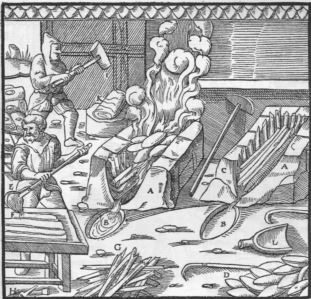
Der Saigerherd A. Der Vorherd B. Die Hölzer C. Zinnkuchen D. Die Kelle E. Die Kupferplatte F. Die Gitter G. Signiereisen H. Der hölzerne Hammer I. Das Ballenzinn K. Schippe L.
