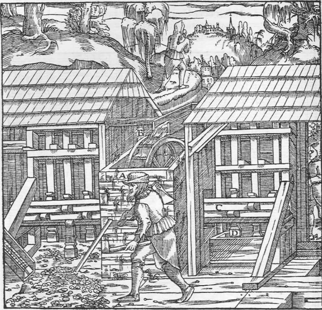
Der Schrot A. Dieser ist am oberen Teile geschlossen, hier ist er offen dargestellt, damit man das Rad sehen kann. Das Rad B. Die Welle C. Die Stempel D.
