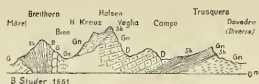
Fig. 1. Geologisches Profil des Simplonmassivs nach Studer - 1851 Sk Graue Schiefer (Glanzschiefer) - D Dolomit und Marmor - G Gips - Gn Gneiss
