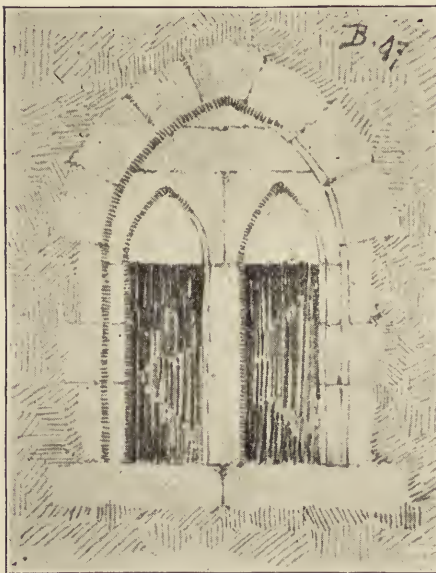
Fig. 77. Ruine Landeck. Doppelfenster am Palas der unteren Burg.
