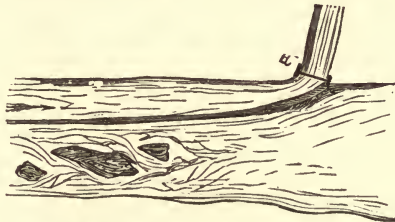
Fig. 99.—LONGITUDINAL WING DAM.
