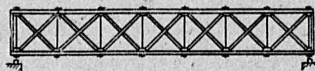
第 32 圖 (a) Howe Truss
