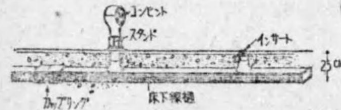
第 6.5.11 圖 床下線槽工事
