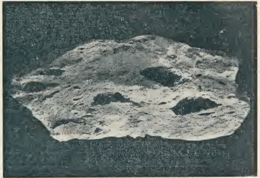
Fig. 7. Zu einer bimssteinartigen Masse geschmolzener Sandstein aus einem Bohrloche im Innern des Kraters (nach Merrill).
