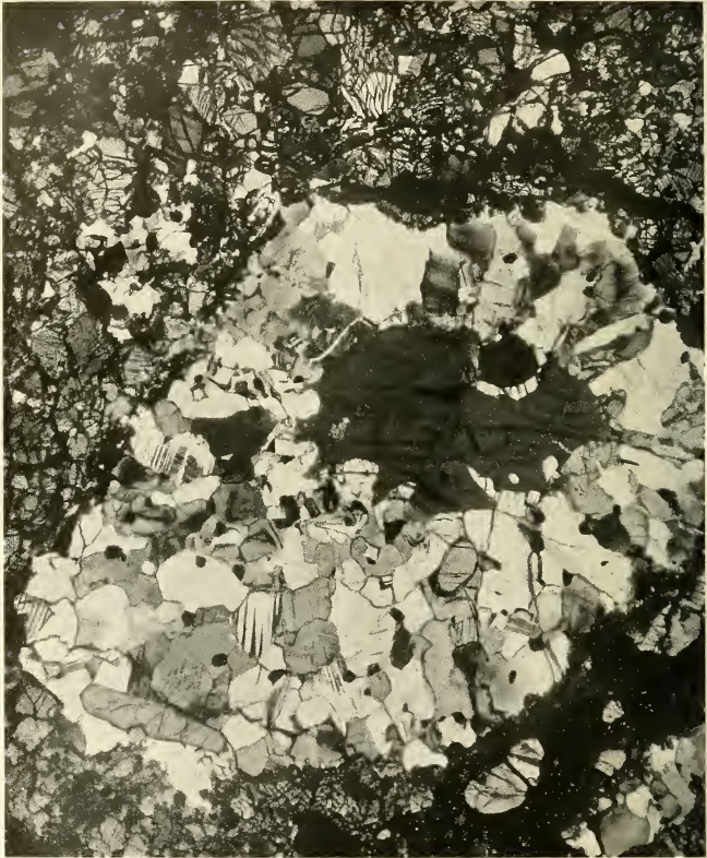
Fig. 77. Utskilning i labradorsten ved Hagasæter. Granat med randsone av feltspat, og utenom hornblende. 20 \times . Polarisert lys.
