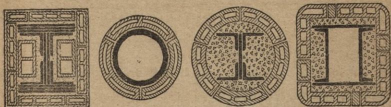
圖 215 示柱用空心磚及混凝土防火之做法
