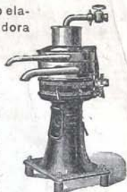
Desnatadora ALFA-LAVAL a vapor
