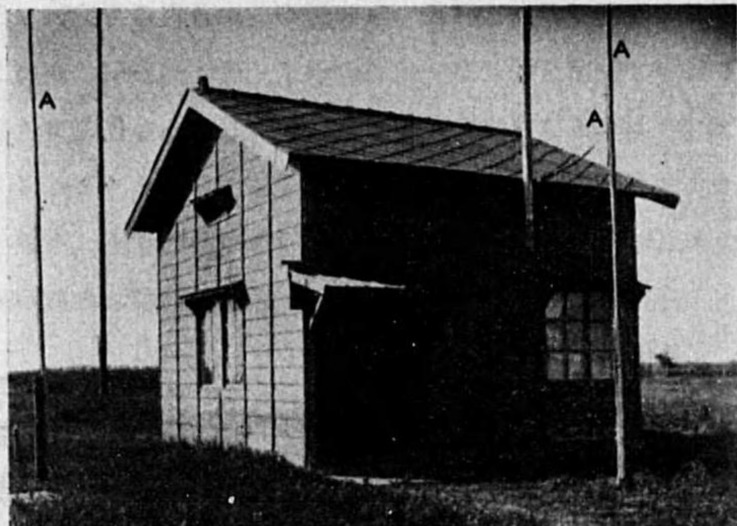
第10圖 アドコック空中線装置 (A: アドコック空中線)
