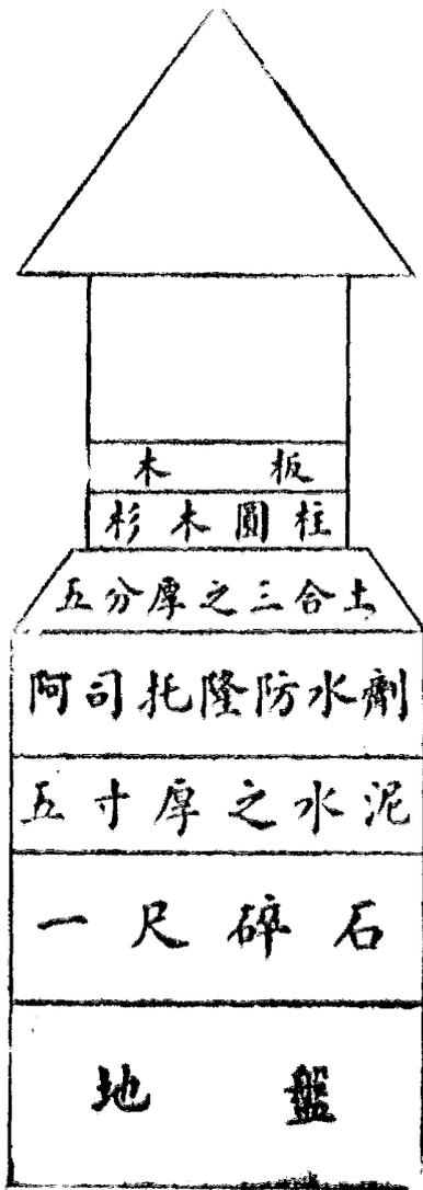
此外在壁體上亦塗以火山灰配合及阿司托隆防水劑。庫內並有羅浮脫生式自然換氣之裝置。
