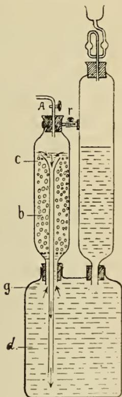
Flasche *d* schlierenförmig auszubreiten. Auf diese Weise entsteht eine Säurezirkulation, dadurch herbeigeführt, dass oben die schwere Salzlösung beständig durch das Trichterrohr abfließt und dafür bei *g* die spezifisch leichtere Säure in das Gefäss *b* eindringt und hier das Zn bzw. FeS angreift.
