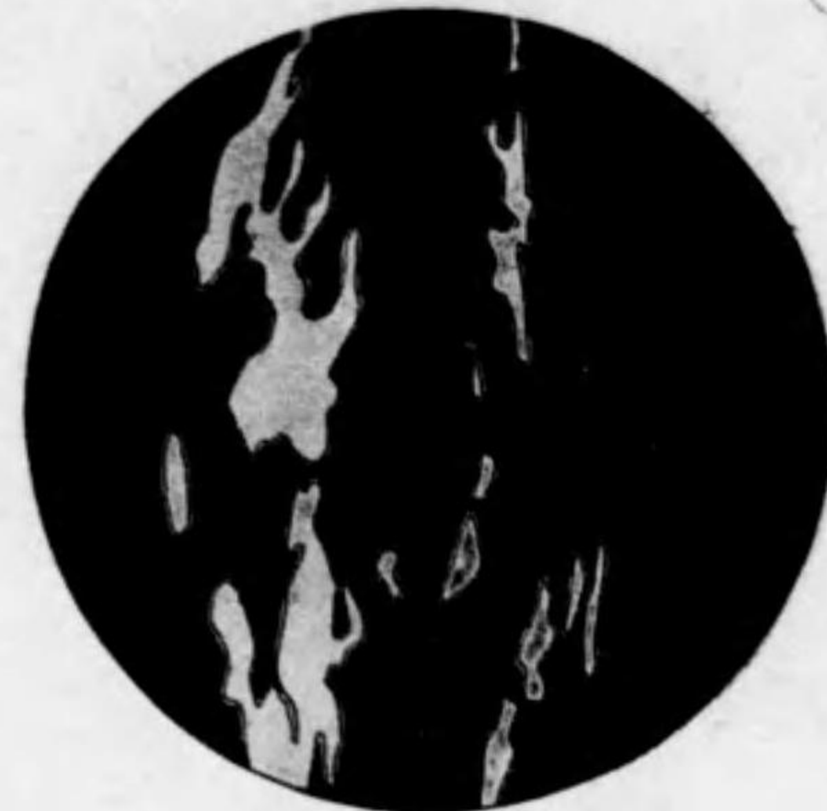
440倍 反射顕微鏡 黒 磁鉄鑛 白 硫鐵ニッケル鑛
