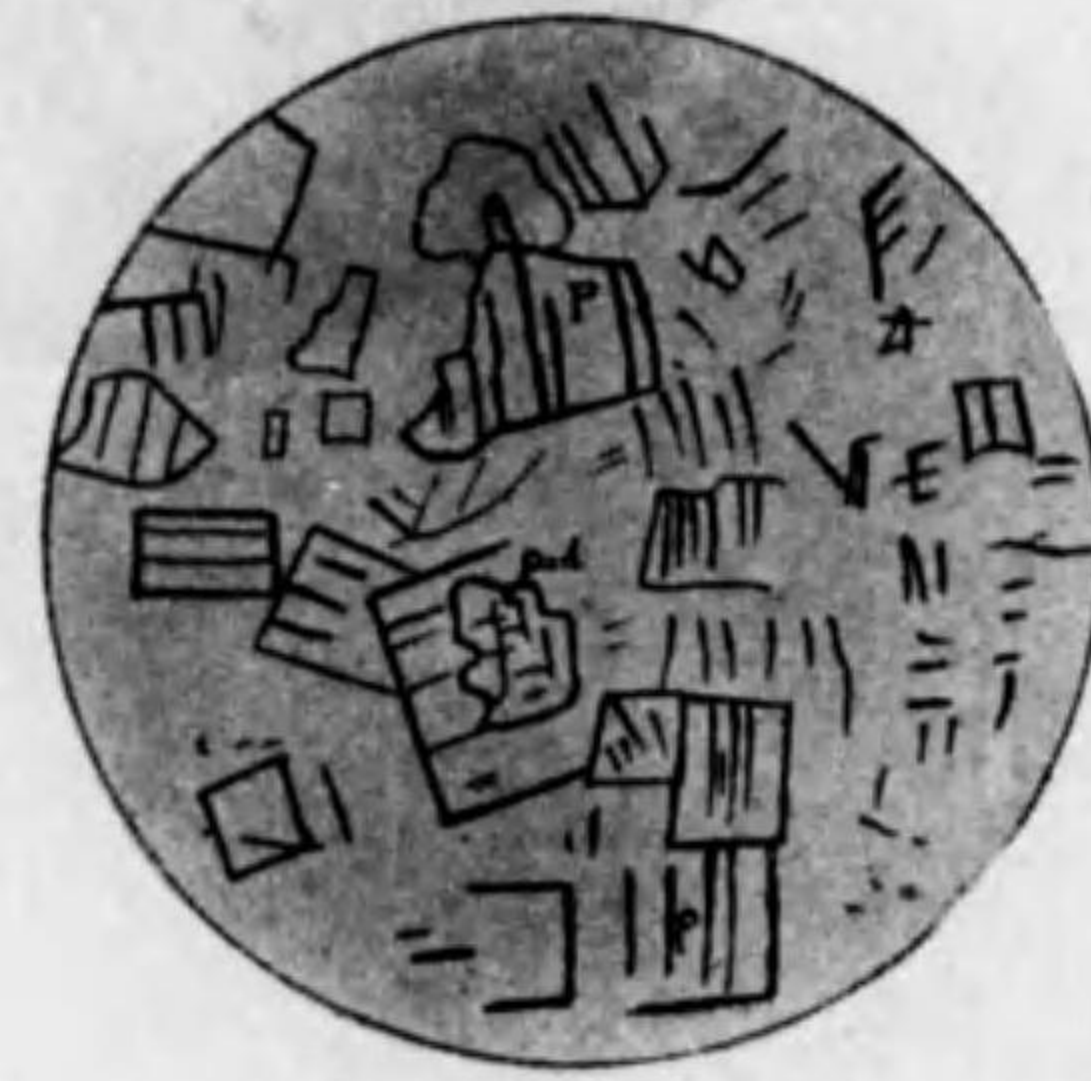
90倍 Prh 磁鉄ニツケル鑛 P 黄銅礦
