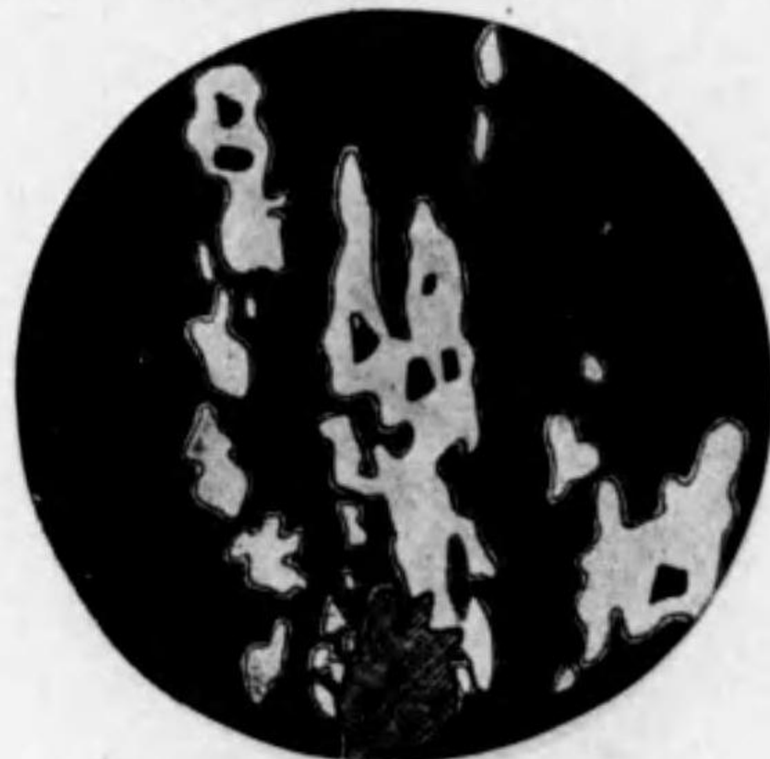
132倍 反射顕微鏡 黒 磁鉄鑛 白 硫鐵ニッケル鑛 灰 母岩
