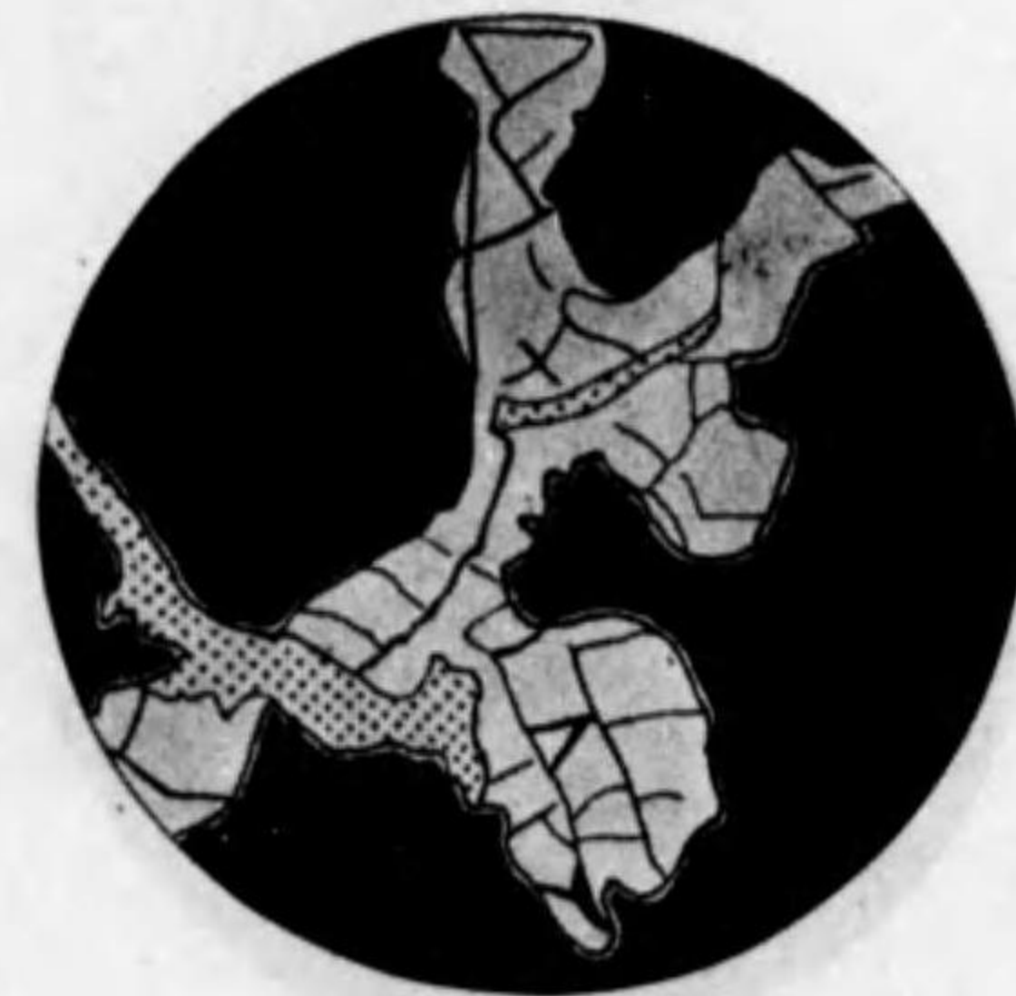
300 倍 白色 硫鐵ニッケル鑛(大粒) 黒色 磁鉄鑛 散點部 磨キ傷
