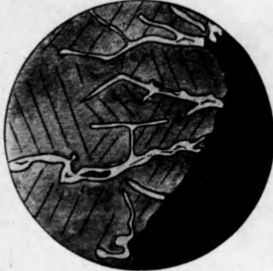
440 倍 反射顕微鏡 黒色 磁鉄鑛 灰色 珪酸鑛物 白色 硫鐵ニッケル鑛
