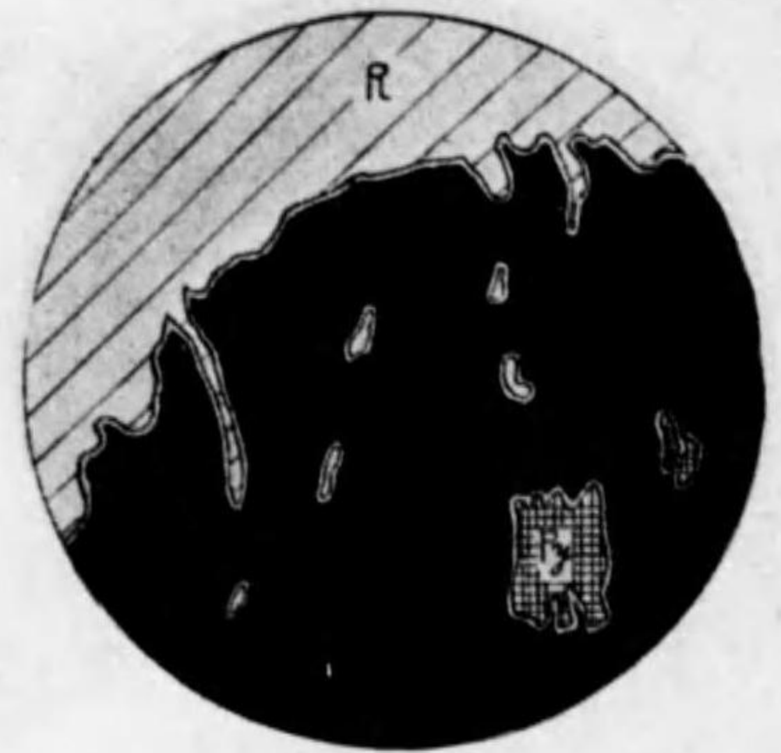
300倍 黒色 磁鉄鑛 R 母岩 Py 黄鐵鑛 白色 硫鐵ニッケル鑛
