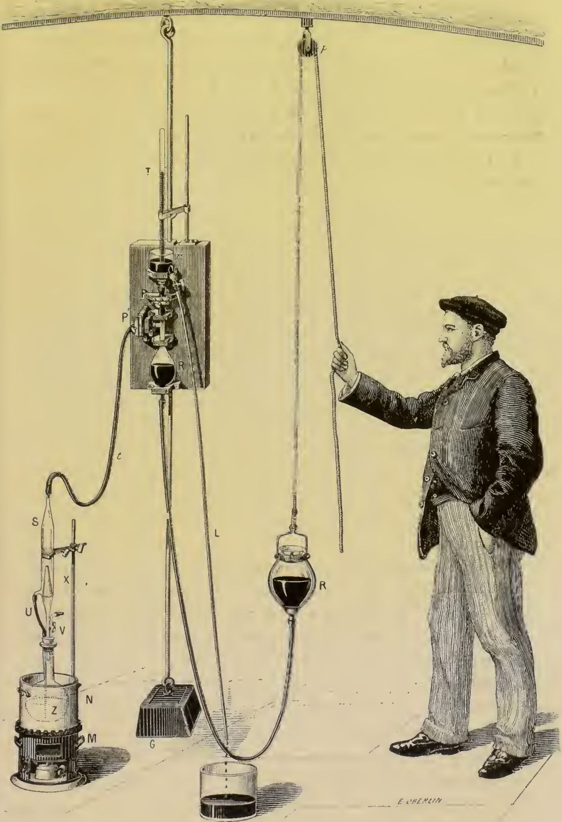
Fig. 176. — Pompe à roulis de P. Regnard pour l'extraction des gaz de l'eau.
