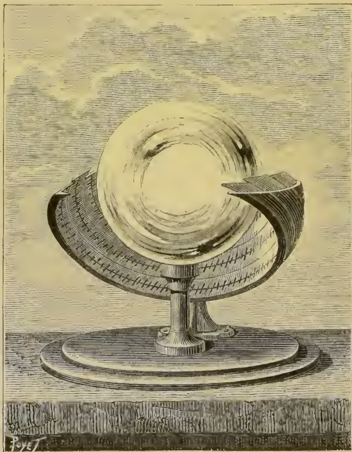
Fig. 93. — Appareil de Campbell et Stokes pour mesurer l'intensité lumineuse.
