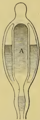
Fig. 134. — Mécanisme qui préserve de l'influence de la pression le thermomètre Miller-Casella.
