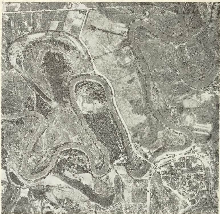
FIG. 2. — Aerofotograma de terreno anegadizo (con semejanzas al del Delta del río Irrawadi de Birmania) donde se ven viejos cauces del río cuya segura localización desde el suelo es imposible.
