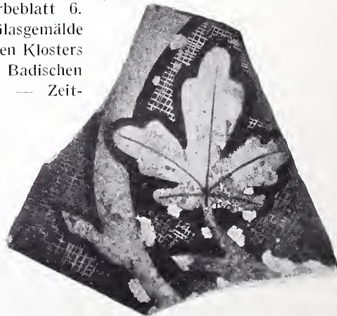
Abb. 239. Scheibe aus Höxter, die weißen Flecken bezeichnen die Stellen, an denen das Schwarzlot abgesprungen ist.
