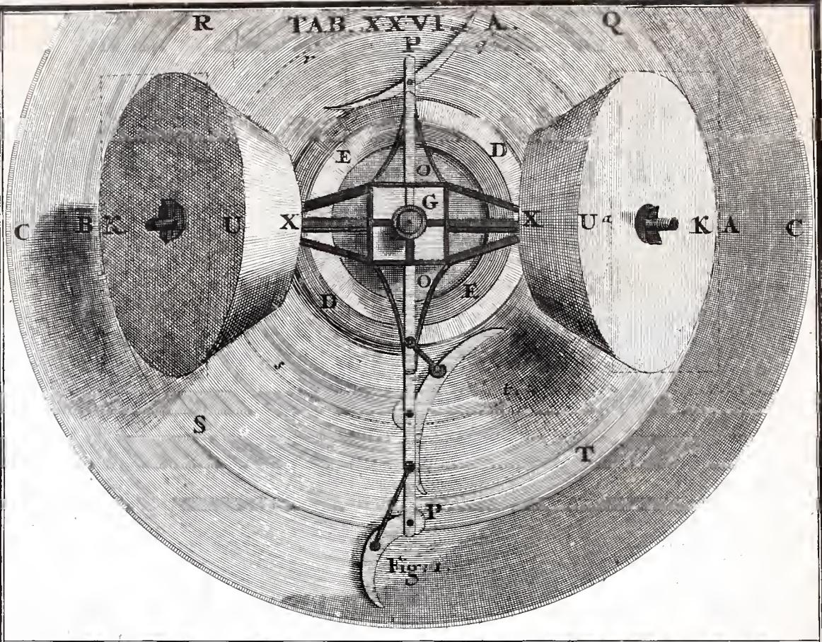
*Grundriss und Standriss der verbesserten Art mit Stehenden nicht Cylindrischen, sondern Curviconischen Läuflsteinen zumaalen L. C. Sturms Invention.*
