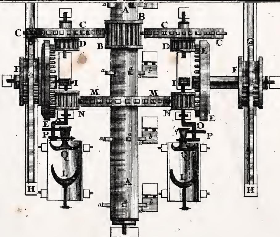
Der halbe Grundriß obengemeldeter Machina, durch deren hülffe ein einziger Mensch mit 12. Flegeln dreschen, und auf 4. Läden Häkrel schneiden kan.
