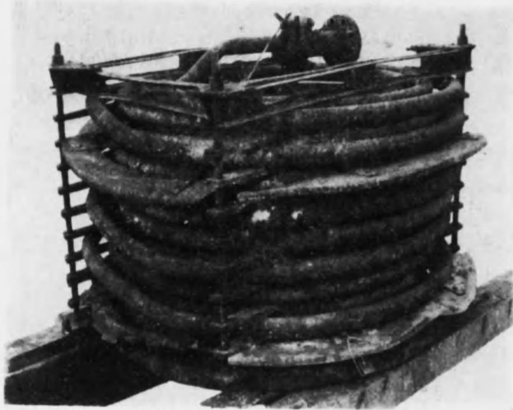
第10圖 エグゼボレーター内熱交換コイル腐蝕状況
