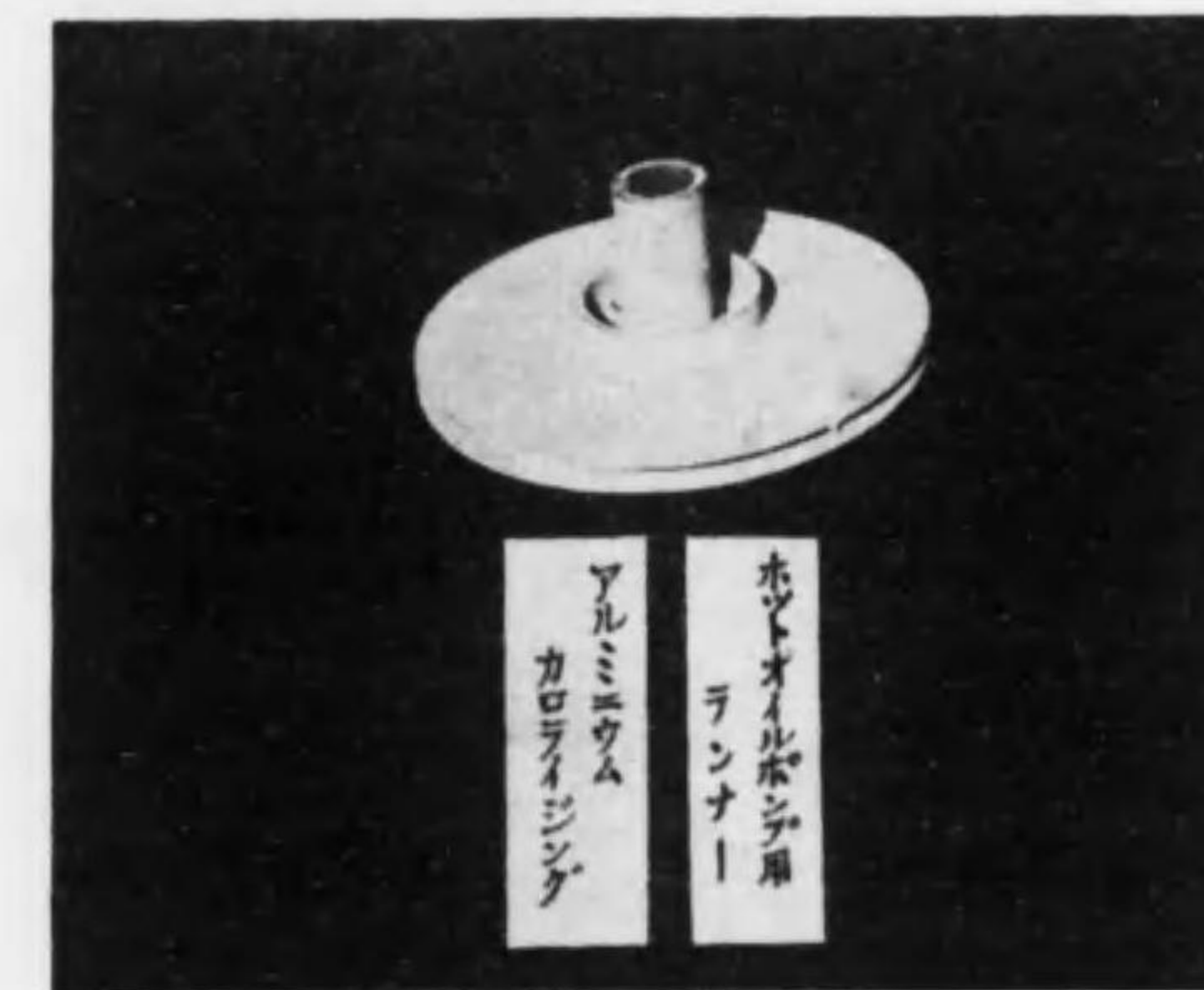
第2圖 ホットオイルポンプ用ランナー腐蝕状況
