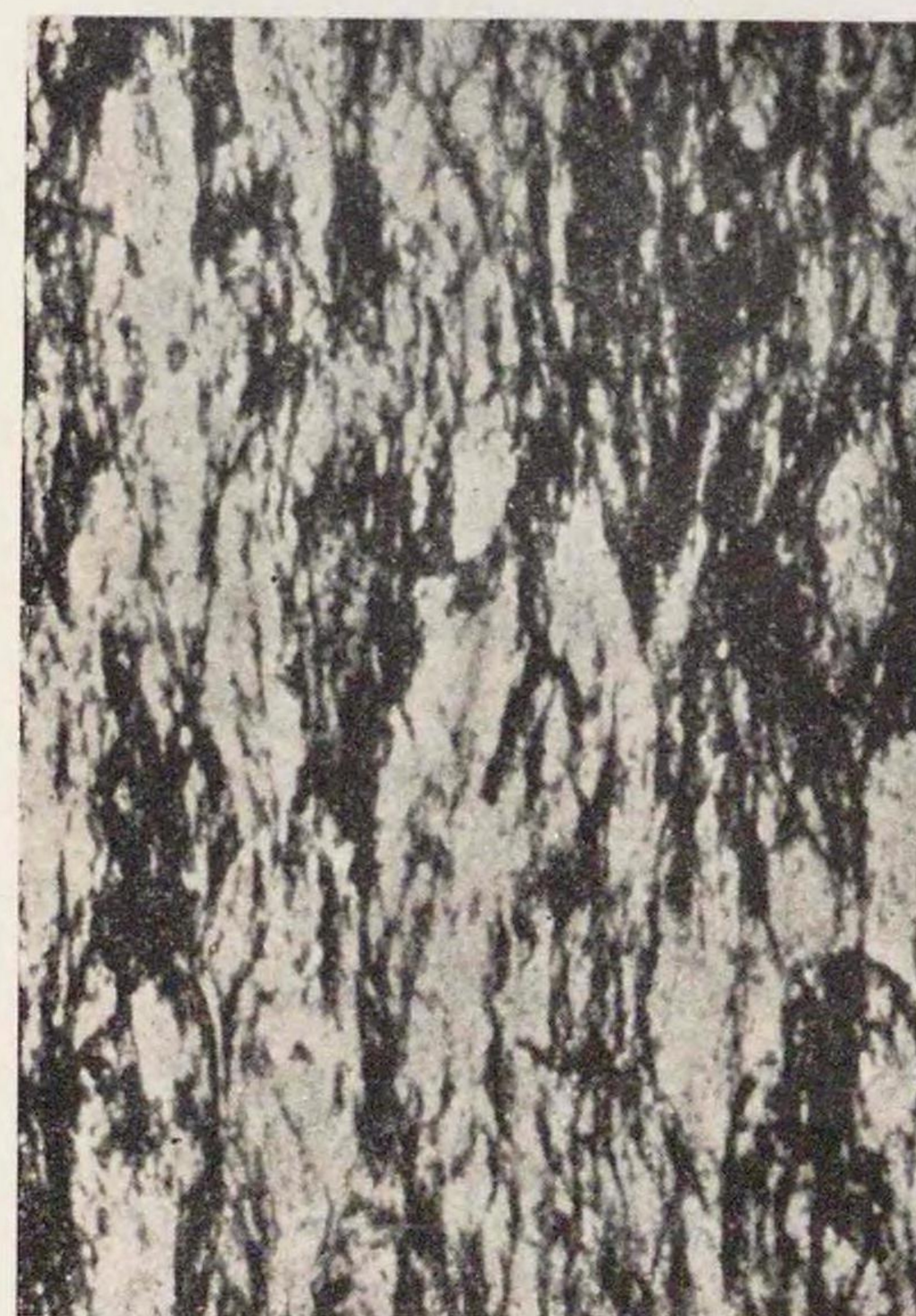
第87圖 Anka 鋼 0.1% C, 15.2% Cr, 11.4% Ni で常温加工して硬くしたものを示す。大洲田粒が一層歪んで細線が一層多く現はれ黒く見える。(ブリネル硬度 350)
