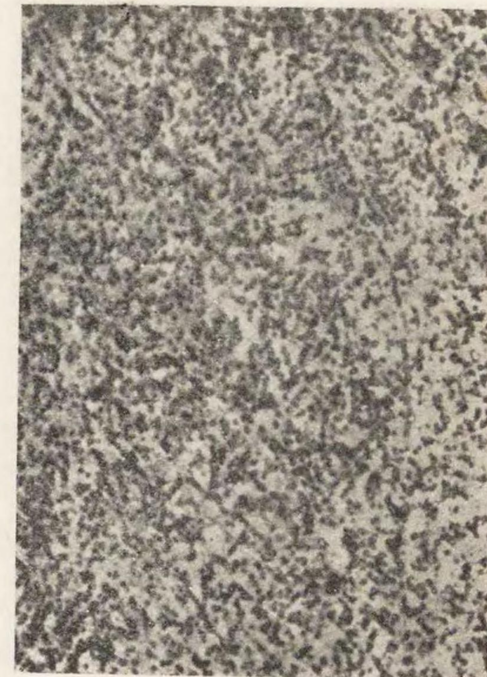
第71圖 900°Cで油焼入せるものを示す。焼入不銹鋼の標準組織である。(ブリネル硬度 437) ×1000
