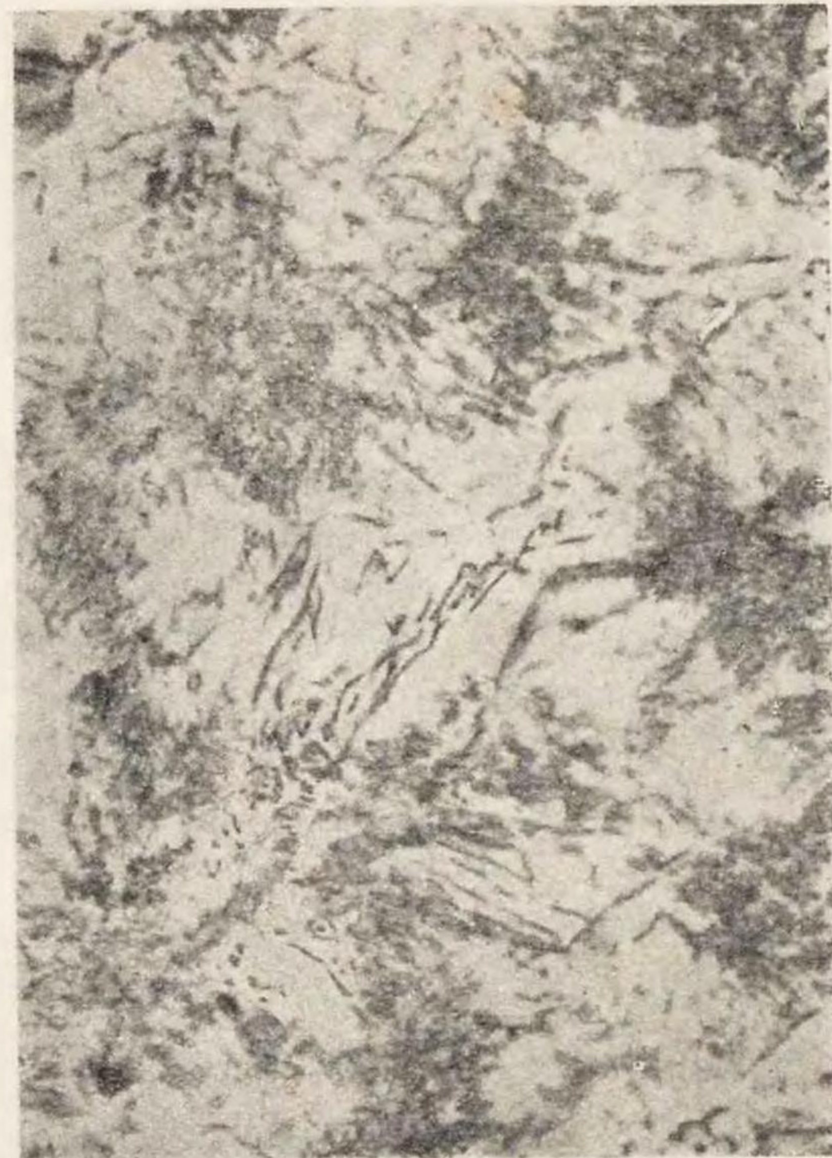
第67圖 66に類似の試片で825°Cに再加熱してから水中に焼入したものを示す。Ac 1 より25°C位の上より焼入したので炭化物が残留してゐて66と似た組織を示す。×750
