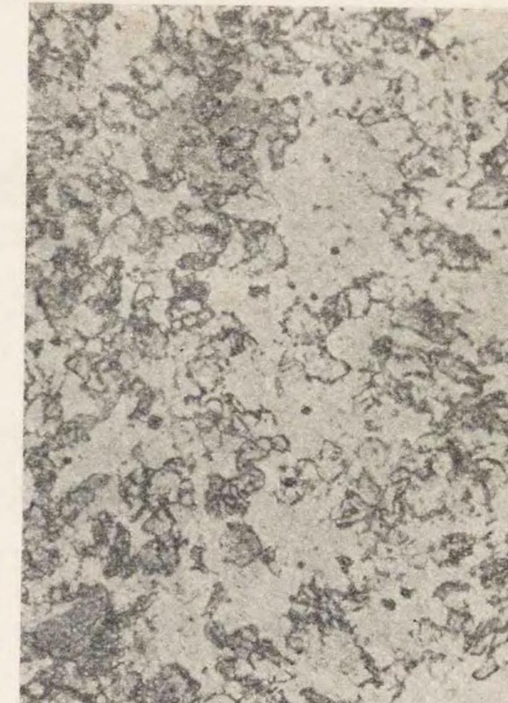
第79圖 0.07% C, 13.3% Cr 不銹鋼で850°Cから水中焼入せるものを示す。(ブリネル硬度 238) ×300
