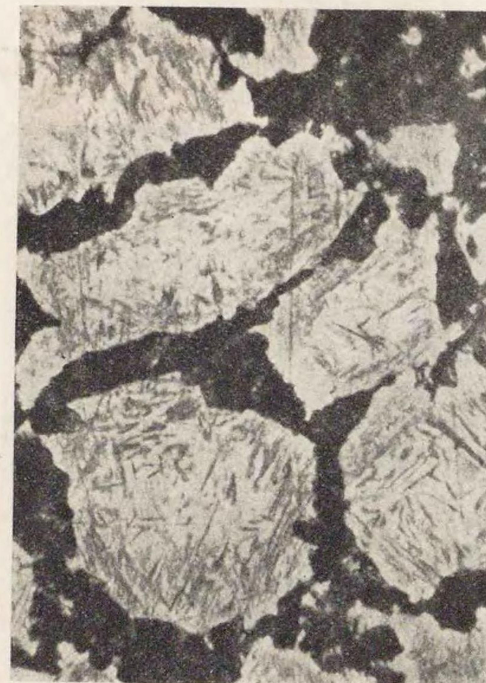
第72圖 1200°Cから静かに適當に冷却せるもので同一試片に於ける白色部は麻留田を、黑色部は吐粒洲組織を示す。(ブリネル硬度 364) ×250
