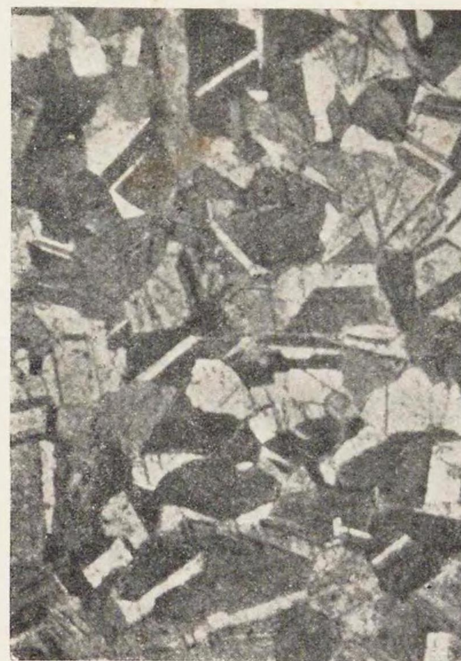
第85圖 Anka 鋼 0.10% C, 15.2% Cr, 11.4% Ni で十分に焼鈍せるものを示す。全部大洲田組織 ×300
