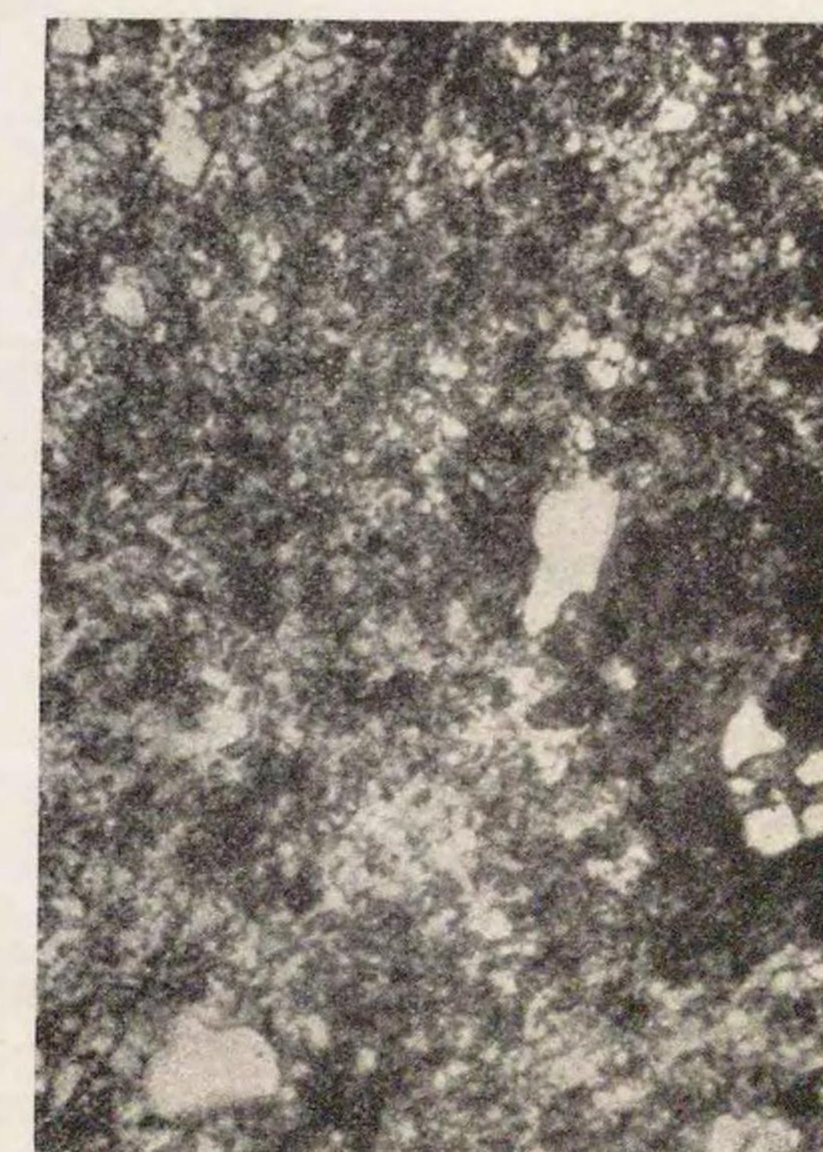
第81圖 1.01% C, 11.8% Cr 不銹鋼で焼入後に十分焼戻せるものを示す。炭素含有量大なるため炭化物が無數に析出す。(ブリネル硬度 241) ×1000
