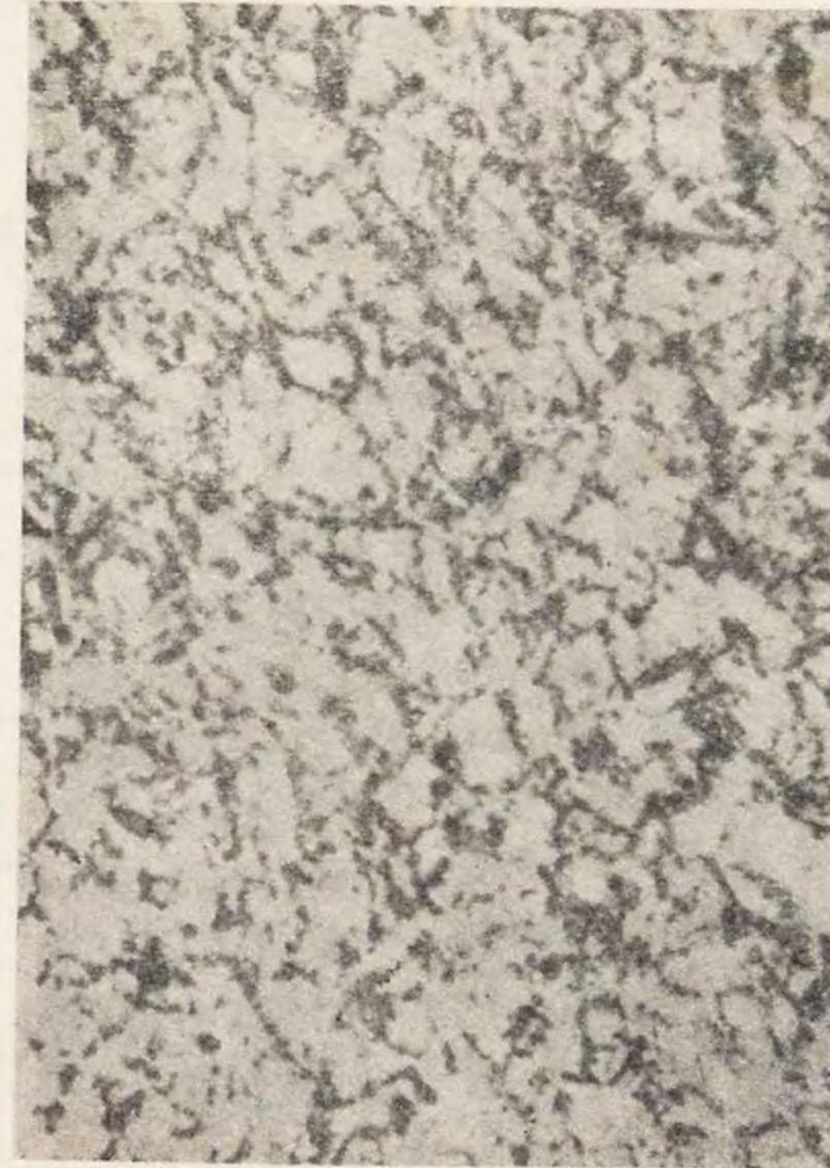
第78圖 0.07% C, 13.3% Cr 不銹鋼で950°Cで焼入硬化してから700°Cに焼戻せるものを示す。炭化物が地鉄に950°Cで固溶し焼入により一部炭化物を残し麻留田となり之が700°Cの焼戻で炭化物を析出す。(ブリネル硬度 174) ×100
