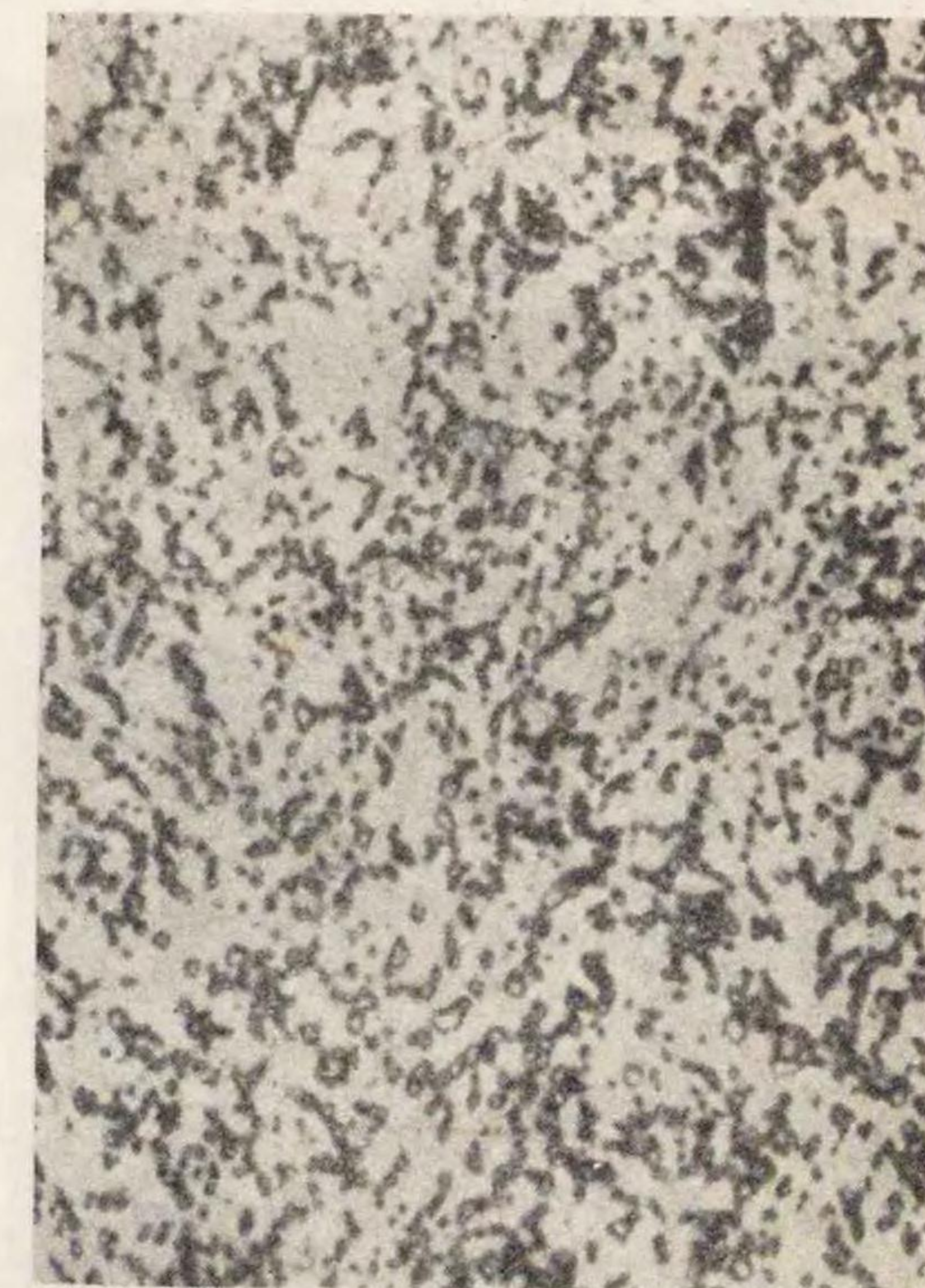
第73圖 860°Cに焼鈍せるものを示す。(ブリネル硬度 170) ×1000
