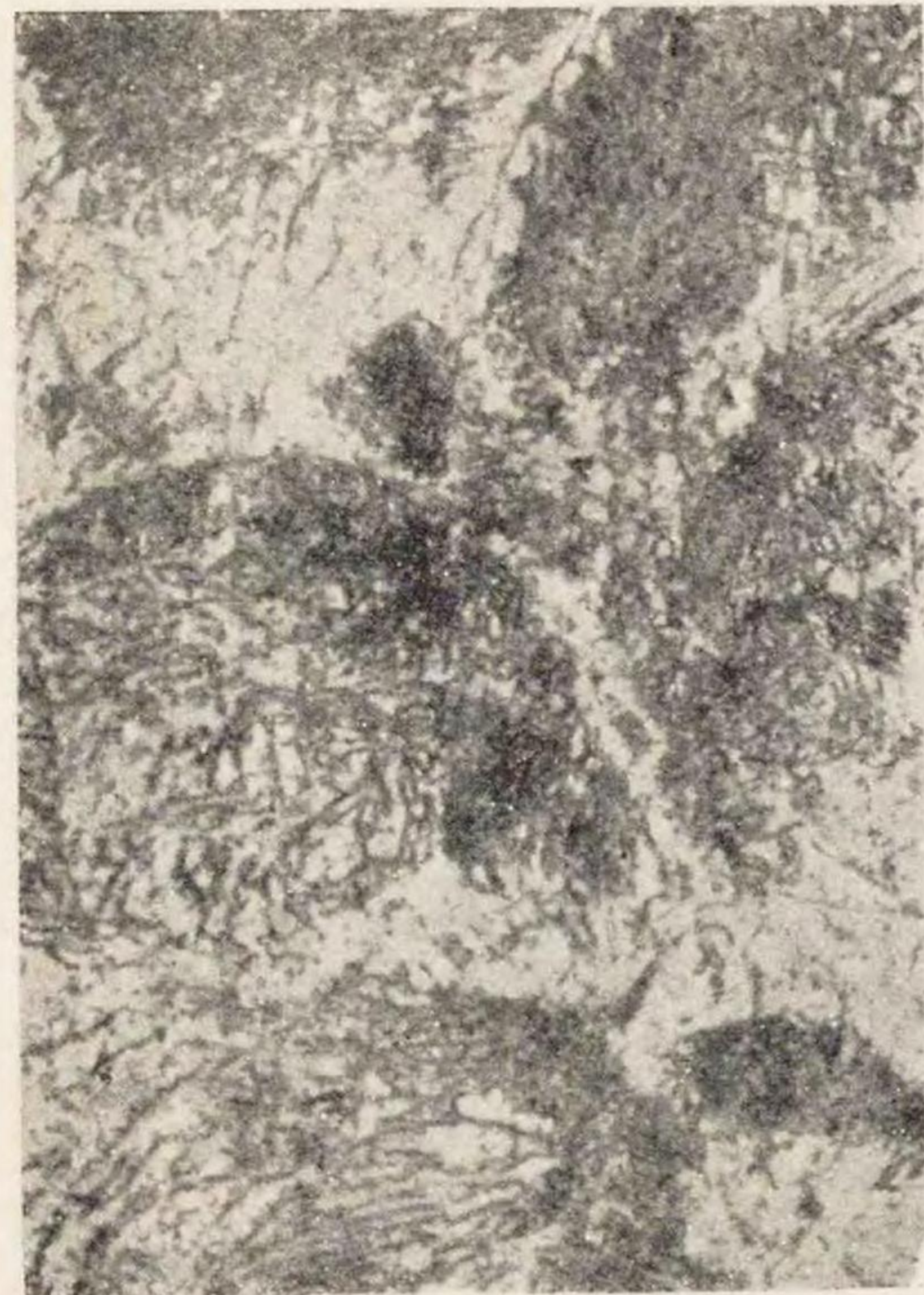
第66圖 高温度より徐冷して波來土組織を生成せしめたものを示す。(ブリネル硬度 200) ×750
