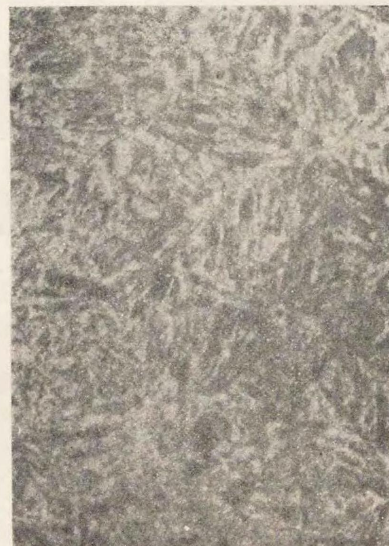
第69圖 6の如く1050°Cに再加熱してから水中に焼入したものを示す。全部麻留田組織となる。×750
