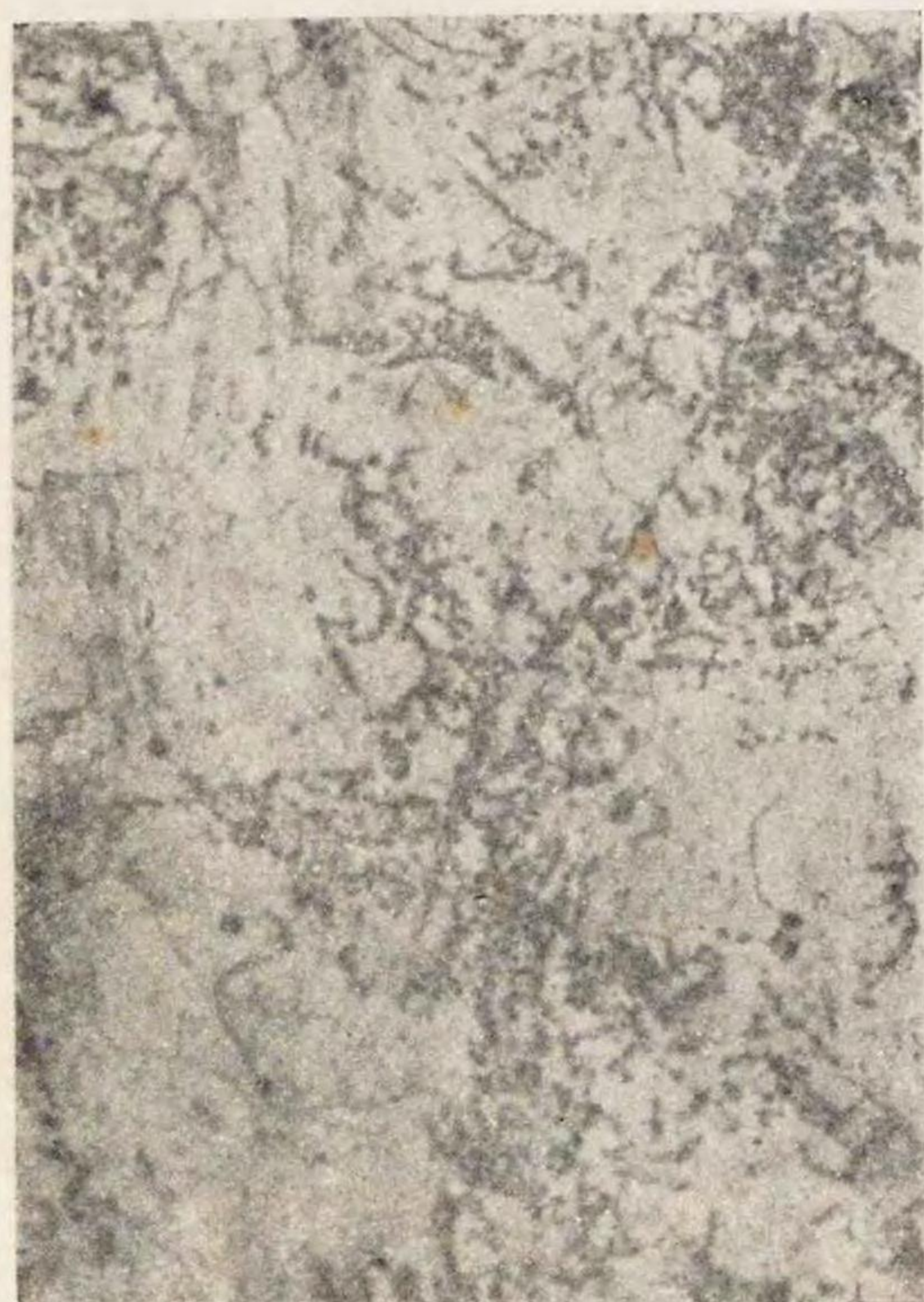
第68圖 67の如く950°Cに再加熱してから水中に焼入せるものを示す。焼入温度がAc 1 より上昇してくるので残留炭化物が少くなり麻留田が現はれる。×750
