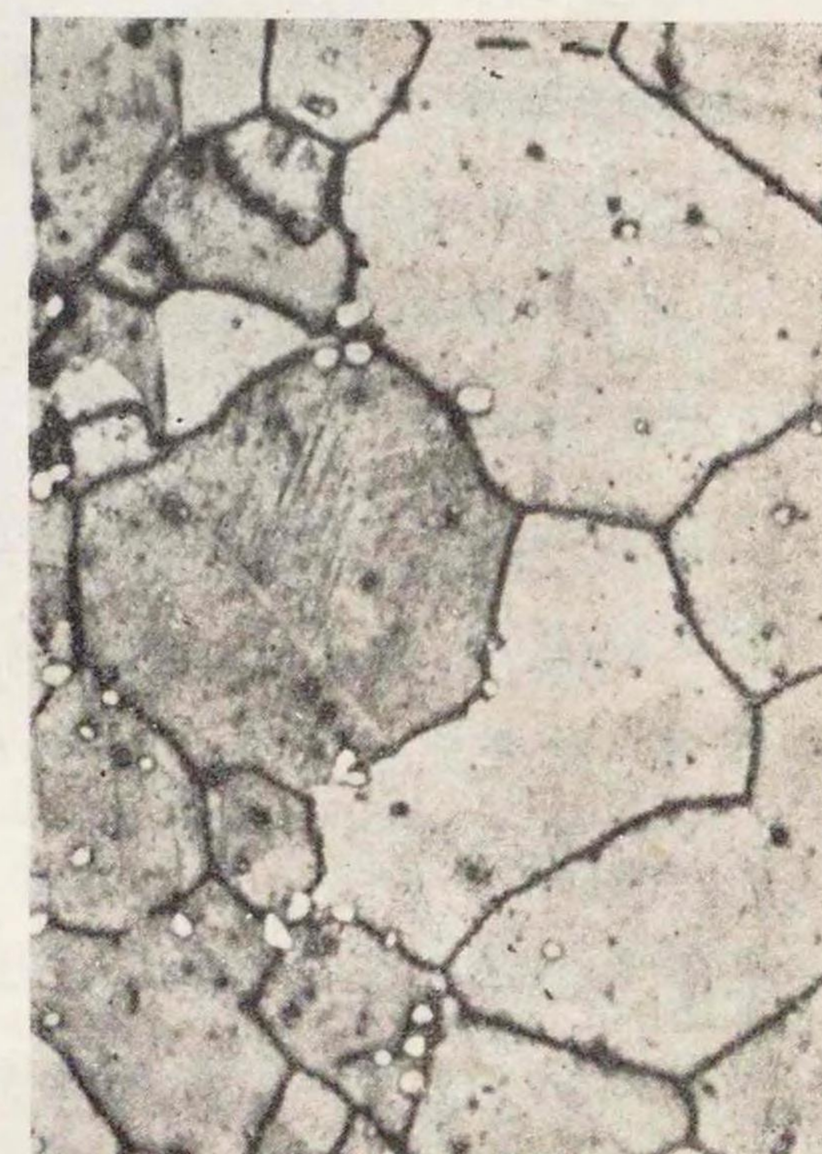
第88圖 0.44% C, 20% Cr, 6.47% Ni の高炭素常輝鋼で大洲田組織を示し、十分に焼鈍したので炭化物が析出してゐる所を示す。1000°Cに再加熱すると粒の歪も線條の出現も全部再結晶により除去される。
