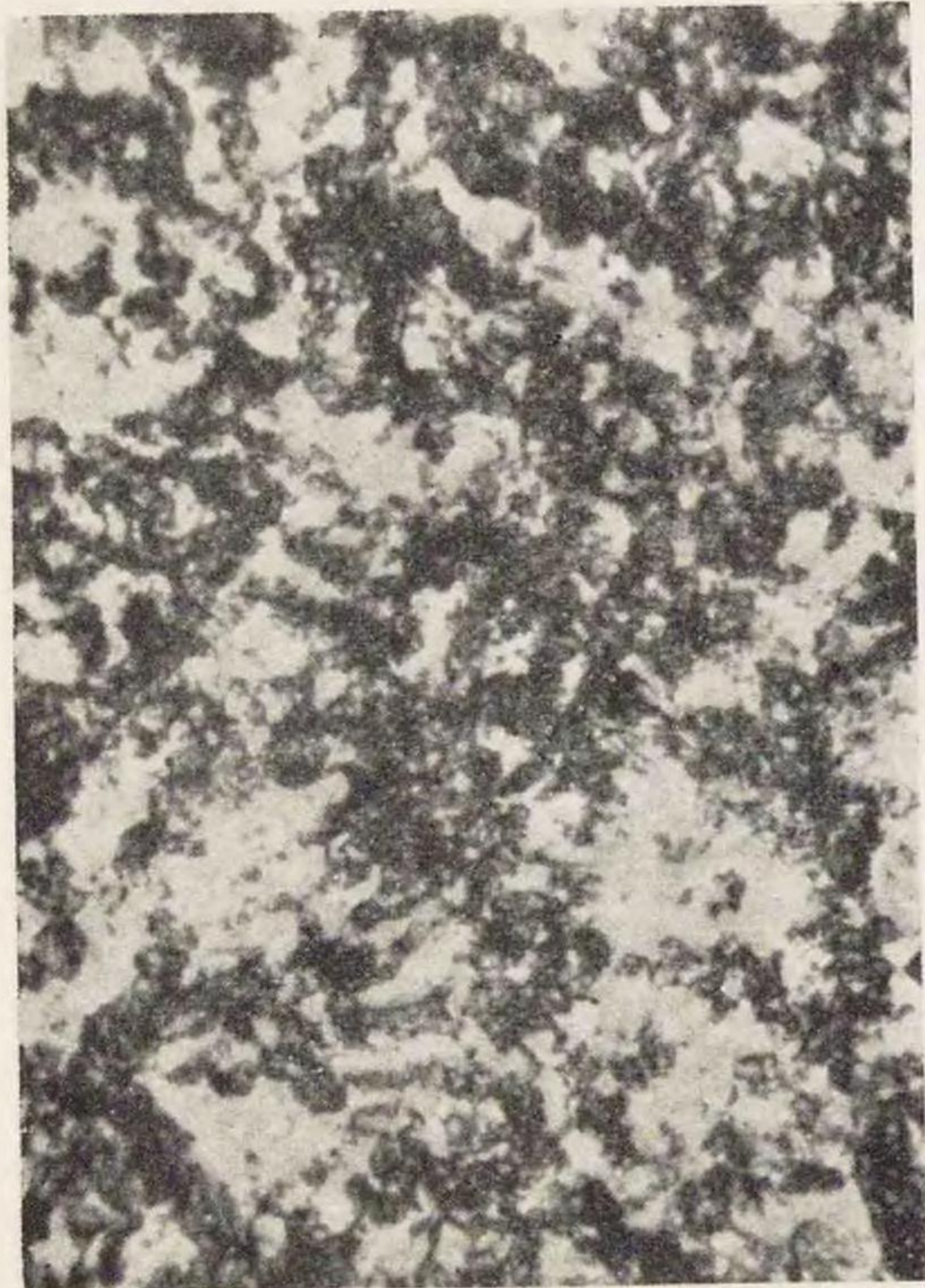
第74圖 硬化するだけ十分に速でない速度で860°Cから冷却した不銹鋼の吐粒洲組織を示す。麻留田の分解した部分が黒くピクリン酸でエッチされる。白色部は未だ分解しない所でエッチされない事を示す。(ブリネル硬度 245) ×250
