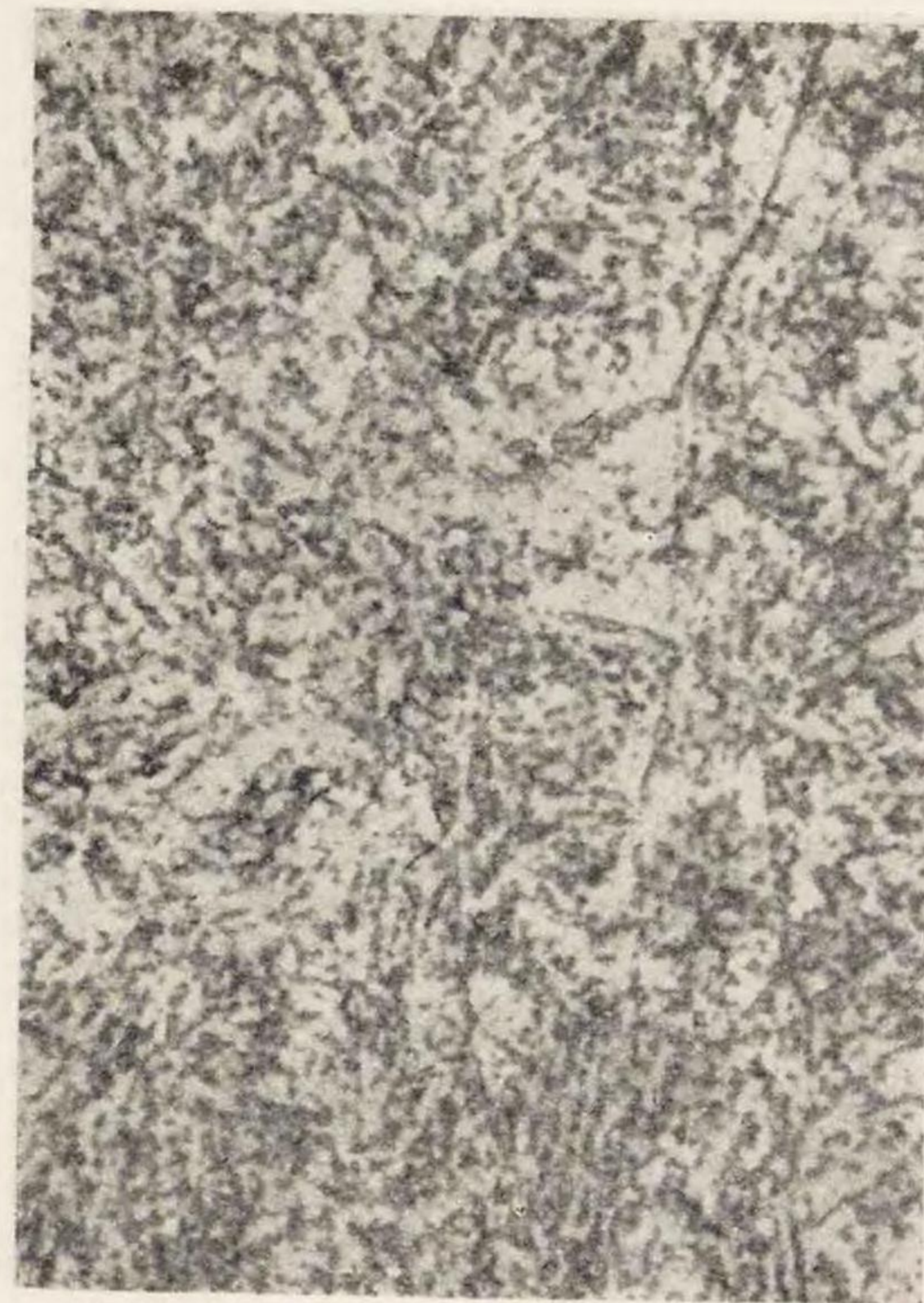
第70圖 焼入後700°Cに焼戻せるもので粗粒波來土組織を示す。(ブリネル硬度 207) ×1000
