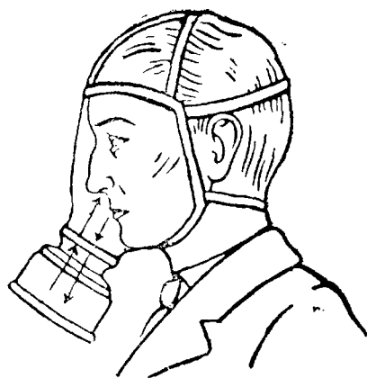
用鼻吸氣用口呼氣罐 內有活塞自然開閉
